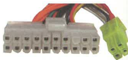
Rys. 58.4. 24-stykowe złącze zasilania ATX 24-pin (20+4)
