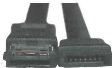
Rys. 47.6. Złącze eSATA (po lewej) oraz złącze SATA (po prawej)
