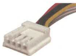
Rys. 58.7. Złącze 4-stykowe zasilania stacji dyskietek Floppy 4-pin
