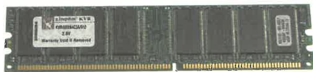
Rys. 38.1. Moduł (184-stykowy) pamięci operacyjnej DDR
