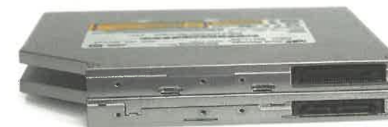
Rys. 97.4. Napęd optyczny z kontrolerem: ATA (u góry) i SATA (u dołu)
