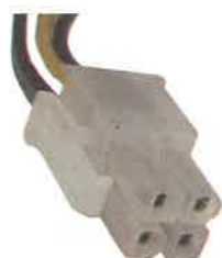
Rys. 58.5. Złącze 4-stykowe ATX 12V 4-pin do zasilania procesora napięciem 12 V
