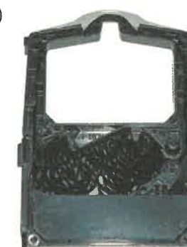
Rys. 81.1. Taśma do drukarek igłowych: a) kompletna, b) widok wewnątrz z nawiniętą taśmą
