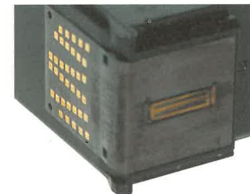
Rys. 82.2. Głowica drukująca w urządzeniu atramentowym (widok od spodu)
