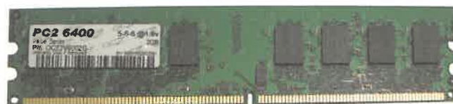
Rys. 38.3. Moduł (240-stykowy) pamięci operacyjnej DDR2
