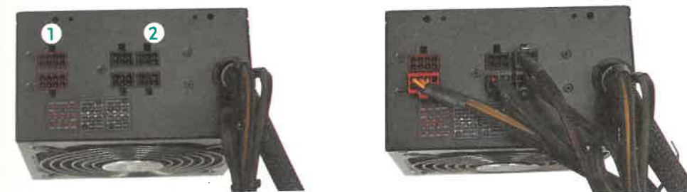
Rys. 59.1. Zasilacz z odłączanymi wtykami zasilania 1 – wtyki zasilania PCI Express, 2 – wtyki zasilania molex i S-ATA
