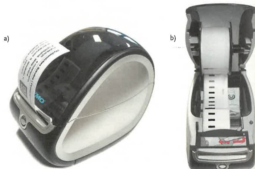
Rys. 68.1. Przykładowa drukarka etykiet: a) podczas wydruku, b) budowa od środka
