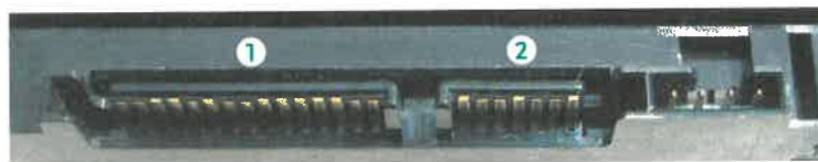
Rys. 47.3. Złącza SATA w dysku twardego 1 – gniazdo zasilania, 2 – gniazdo interfejsu SATA
