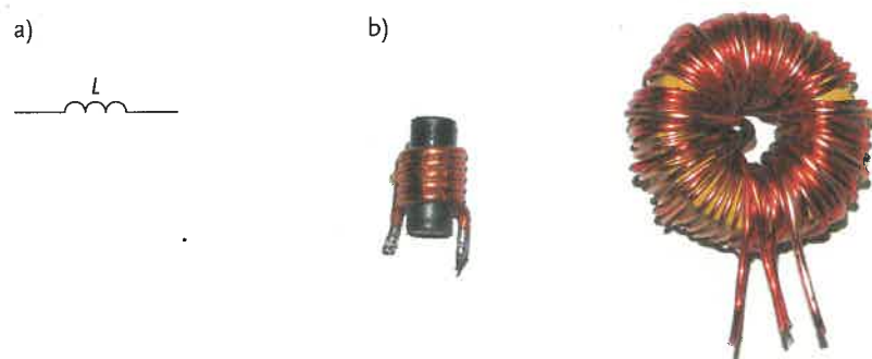
Rys. 23.4. Cewka: a) oznaczenie i symbol, b) wygląd typowego elementu z rdzeniem ferrytowym
