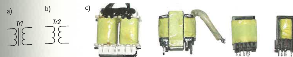
Rys. 23.5. Transformator: a) oznaczenie i symbol z rdzeniem Tr1 , b) oznaczenie i symbol bez rdzenia Tr2 , c) wygląd typowego elementu
