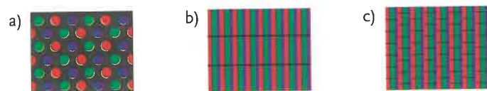
Rys. 77.3. Układ luminoforu w kineskopie monitora CRT – maski: a) perforowana, b) szczelinowa, c) kratowa
