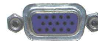
Rys. 77.4. Złącze sygnałowe D-SUB monitorów CRT
