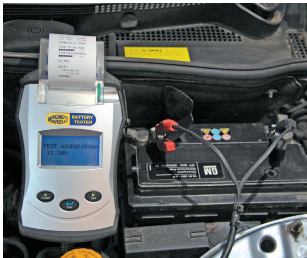
Rys. 4.14. Sposób oceny stanu technicznego akumulatora z wykorzystaniem pomiaru konduktancji/ rezystancji (a) oraz przykładowy wydruk z wynikami pomiarów (b)
