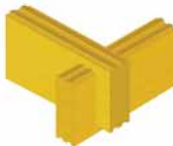
Ściana zewnętrzna z bali pełnych
