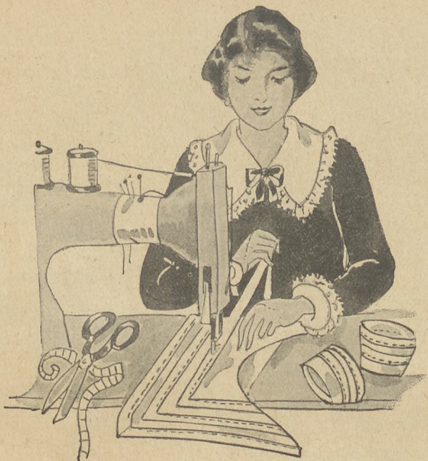
Ryc. 46. Przybranie wierzchniego kołnierza. Gładkie białe bory stębnuje się tylko z jednej strony
