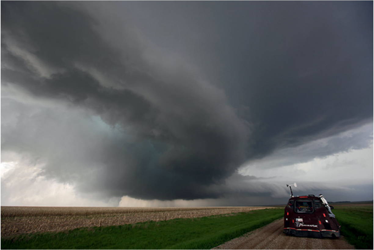
Dominator szykuje się do przechwycenia rozwijającego się tornada w północno-środkowej części Dakoty Południowej w 2010. Z tyłu po prawej stronie dachu został zamontowany radar pionowy przeznaczony do pomiaru wiatrów wstępujących wewnątrz tornada.
