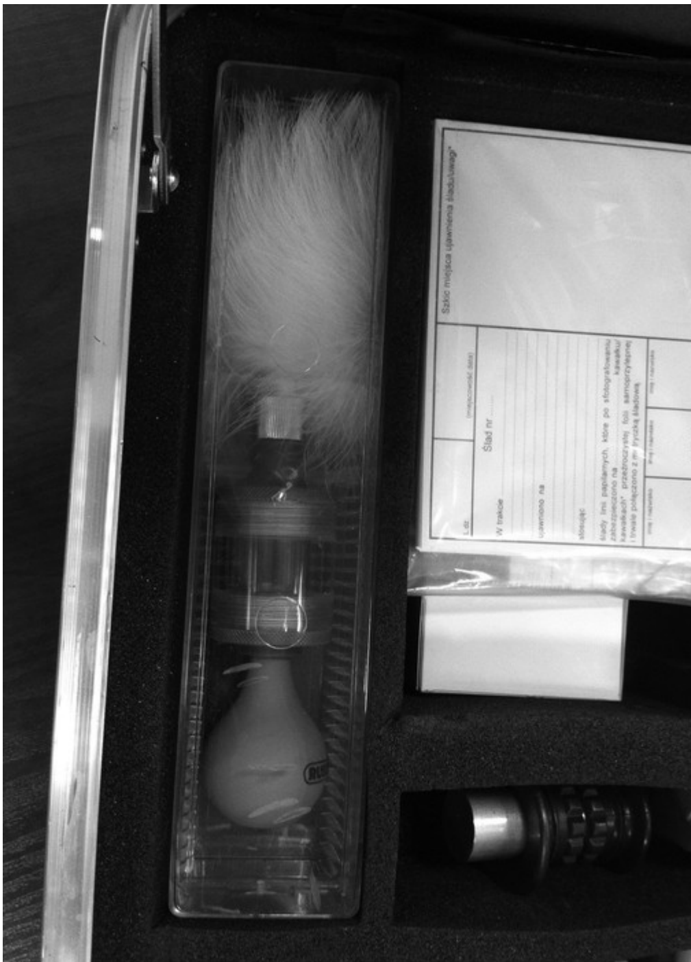
Zawartość walizki technika kryminologa. Na pierwszym planie – pędzel z marabuta z pompką do rozpylania chemikaliów, które ujawniają odciski palców na różnych powierzchniach.
