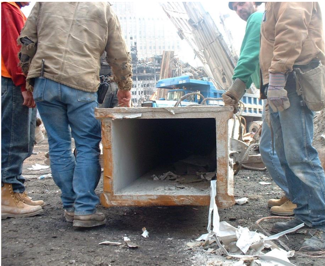
A oto przekrój kolumny ze ściany nośnej wieży WTC - fragment badany na miejscu katastrofy „Ground Zero”.
