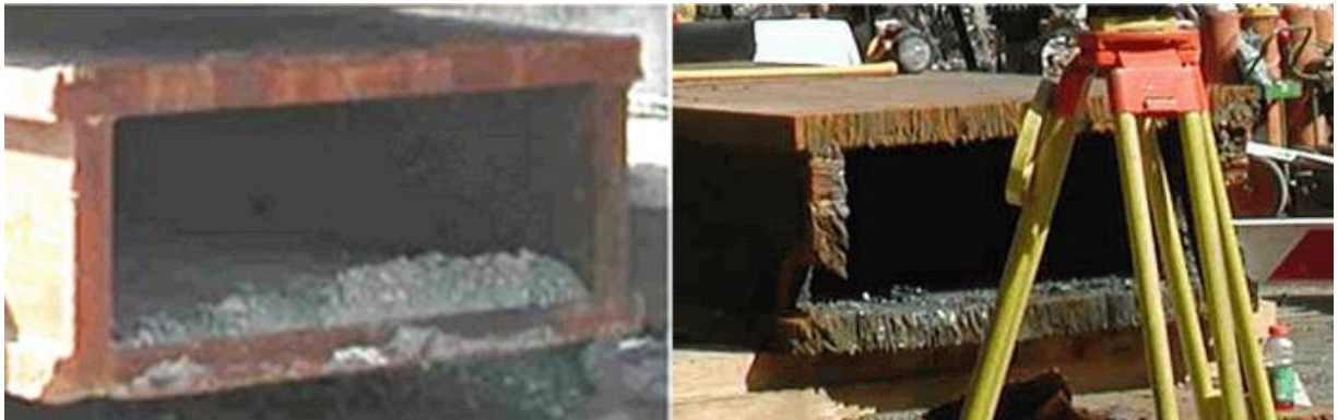
Przekroje elementów stalowych konstrukcji badane na terenie „Ground Zero”, grubość każdej ze ścian – 2,5 cala. Z takich elementów zbudowane były rdzenie i ściany zewnętrzne – fasady bliźniaczych wież.
