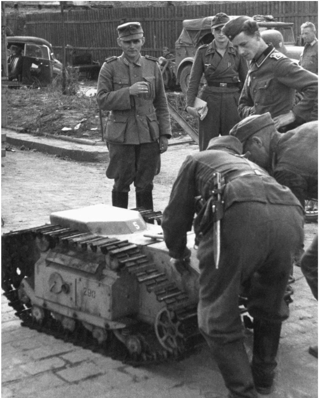
20. „Goliat” – zdalnie sterowany transporter ładunków wybuchowych, popularnie nazywany miniczołgiem, skutecznie niszczący barykady.
