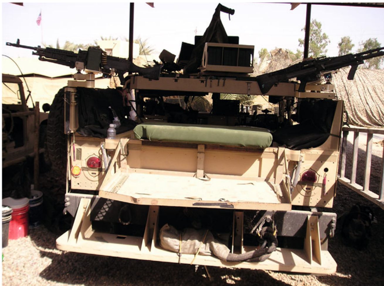
HMMWV – tył z widoczną tylną rampą, siedziskiem dla gunnerów i zamontowanymi na wysięgnikach karabinami
