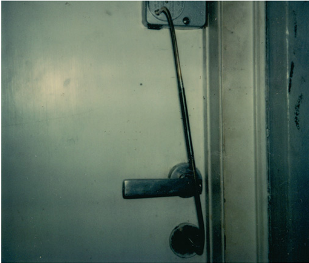
Pan Zenon skonstruował specjalny zestaw ułatwiający ustalenie kombinacji przy pomocy pręta stanowiącego jednocześnie klucz do przeszyfrowania. Widoczna
