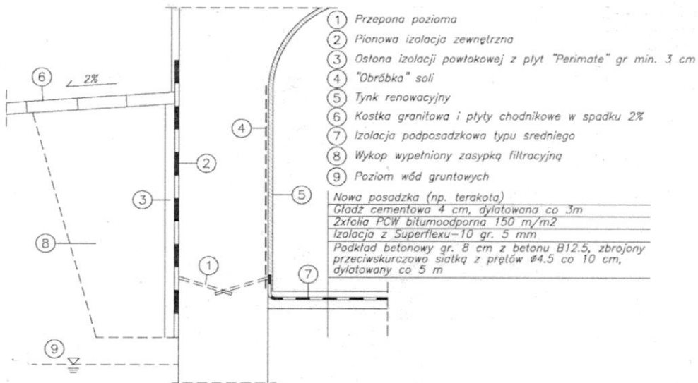
Schemat wykonania zabezpieczenia przeciwwilgociowego ścian zewnętrznych,
