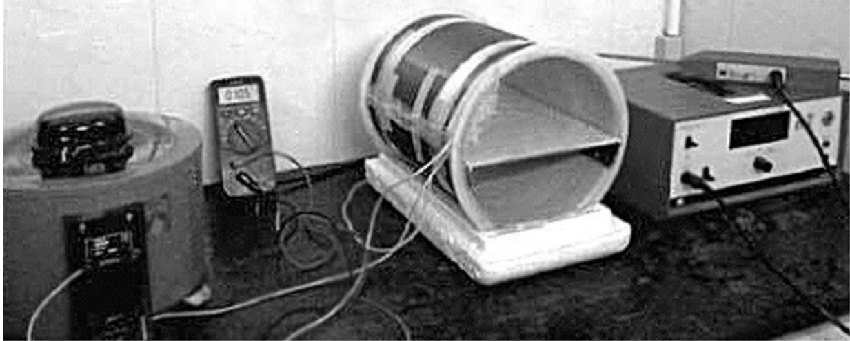
Badacze zbudowali generator pola magnetycznego o skrajnie niskiej częstotliwości wykorzystując transformator, multimetr, cewki cylindryczne, teslomierz i sondę (Razavi, Salimi, Shabhazi-Gahrouei, Karbasi i Kermani, 2014)
