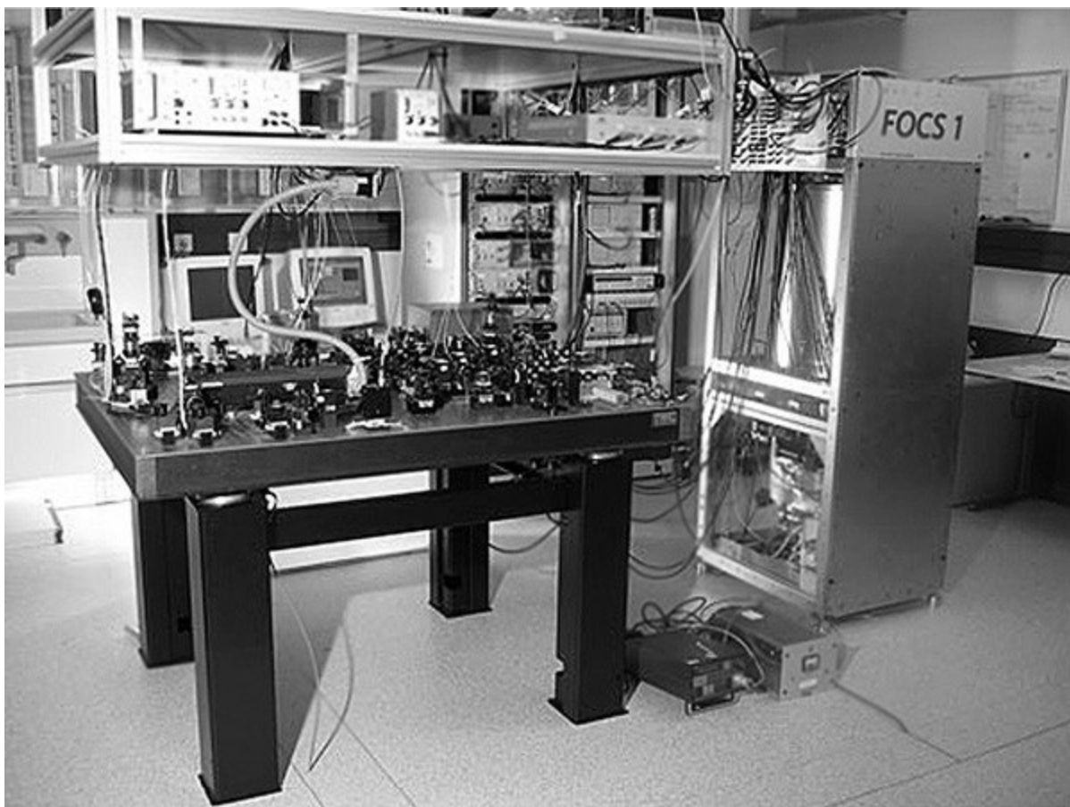
Atomowy zegar cezowy skonstruowany w 2004 roku dla laboratorium w Szwajcarii działa z odchyleniem od dokładności okresu wynoszącym 1 sekundę na 30 milionów lat
