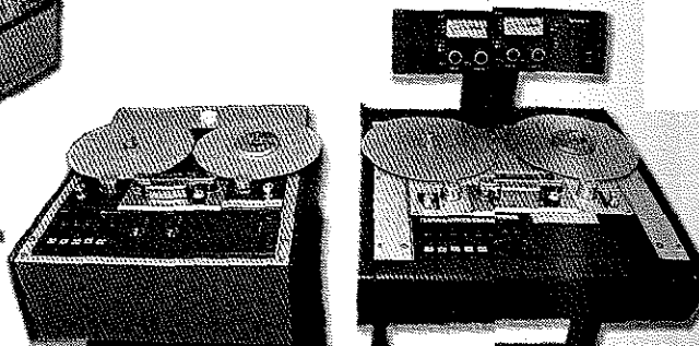
Magnetofony analogowe tuder do taśm tzw. radiowych 6,25 mm
