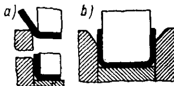
Rys. 71. Wgniecenia przy wyginaniu i zalecany kształt matrycy
