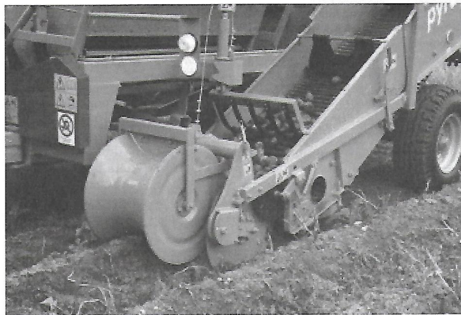
Ryc. 13.14. Rolka kopiująca, tarcza odcinająca, rolka wciągająca i główny przenośnik odsiewający kombajnu do zbioru ziemniaków podczas pracy (fot. firmy UNIA group)
