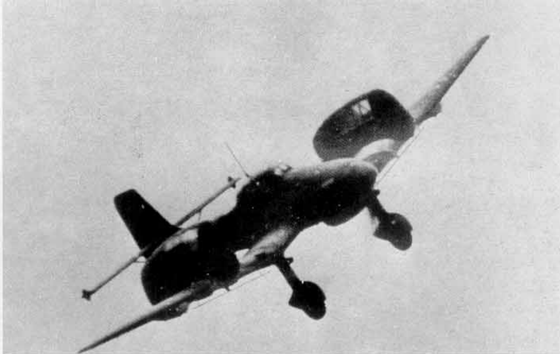
Ju 87 D-3 z dwoma kabinami dla dywersantów zainstalowanymi na skrzydłach.
