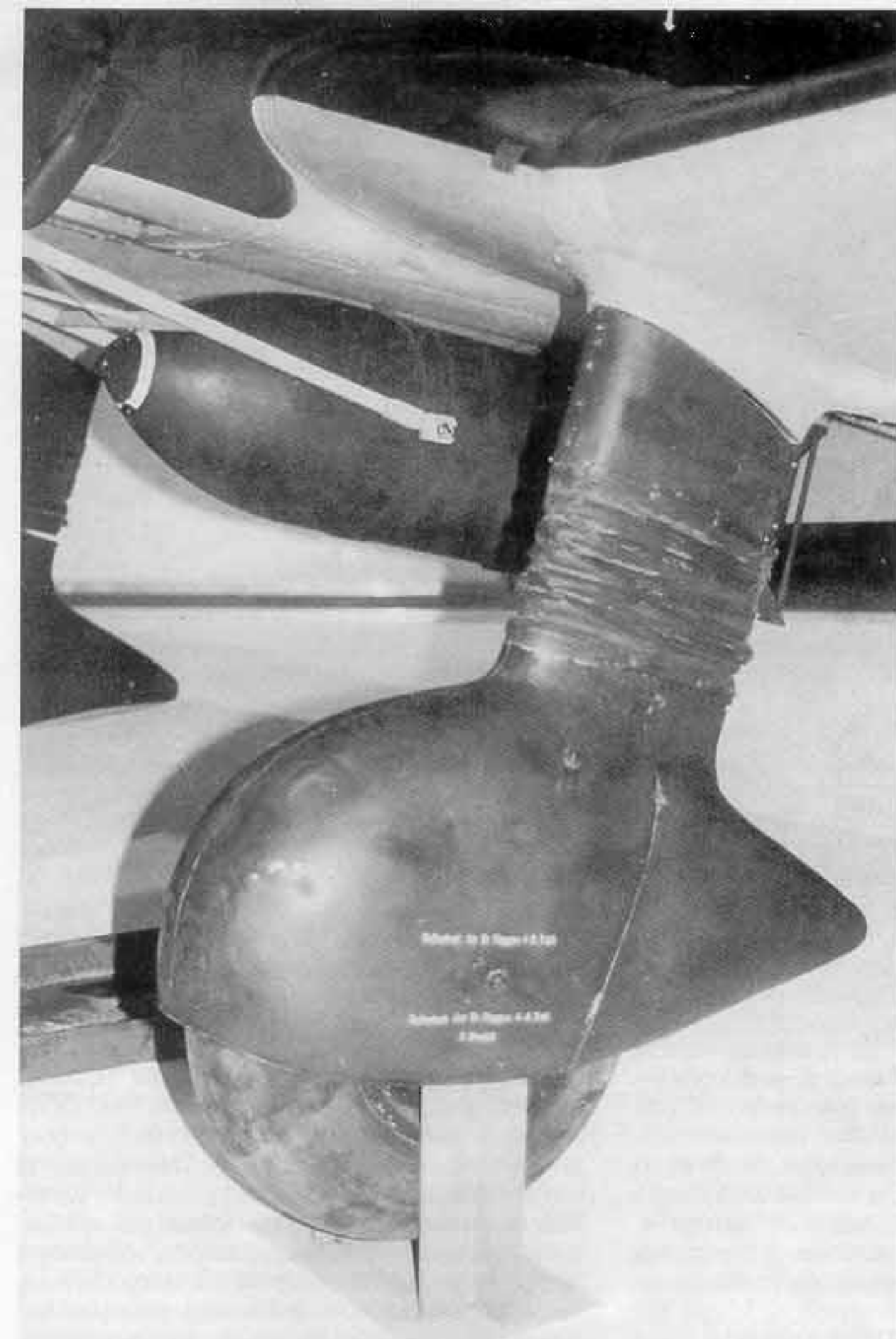
Podwozie główne samolotu Ju 87 D-5. Widoczna bomba 250 kg umieszczona pod kadłubem.
