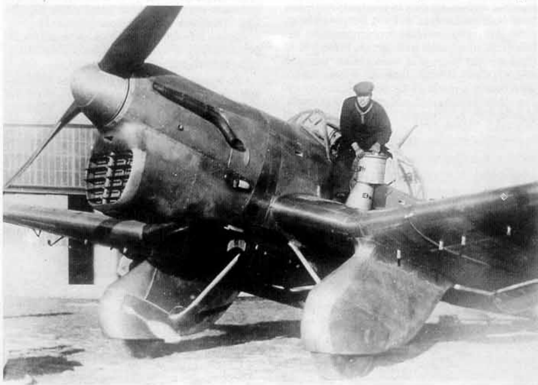
Ju 87 V1 ze zmodyfikowaną, większą chłodnicą pod silnikiem. Warto zwrócić uwagę na węzły mocowania hamulców aerodynamicznych.
