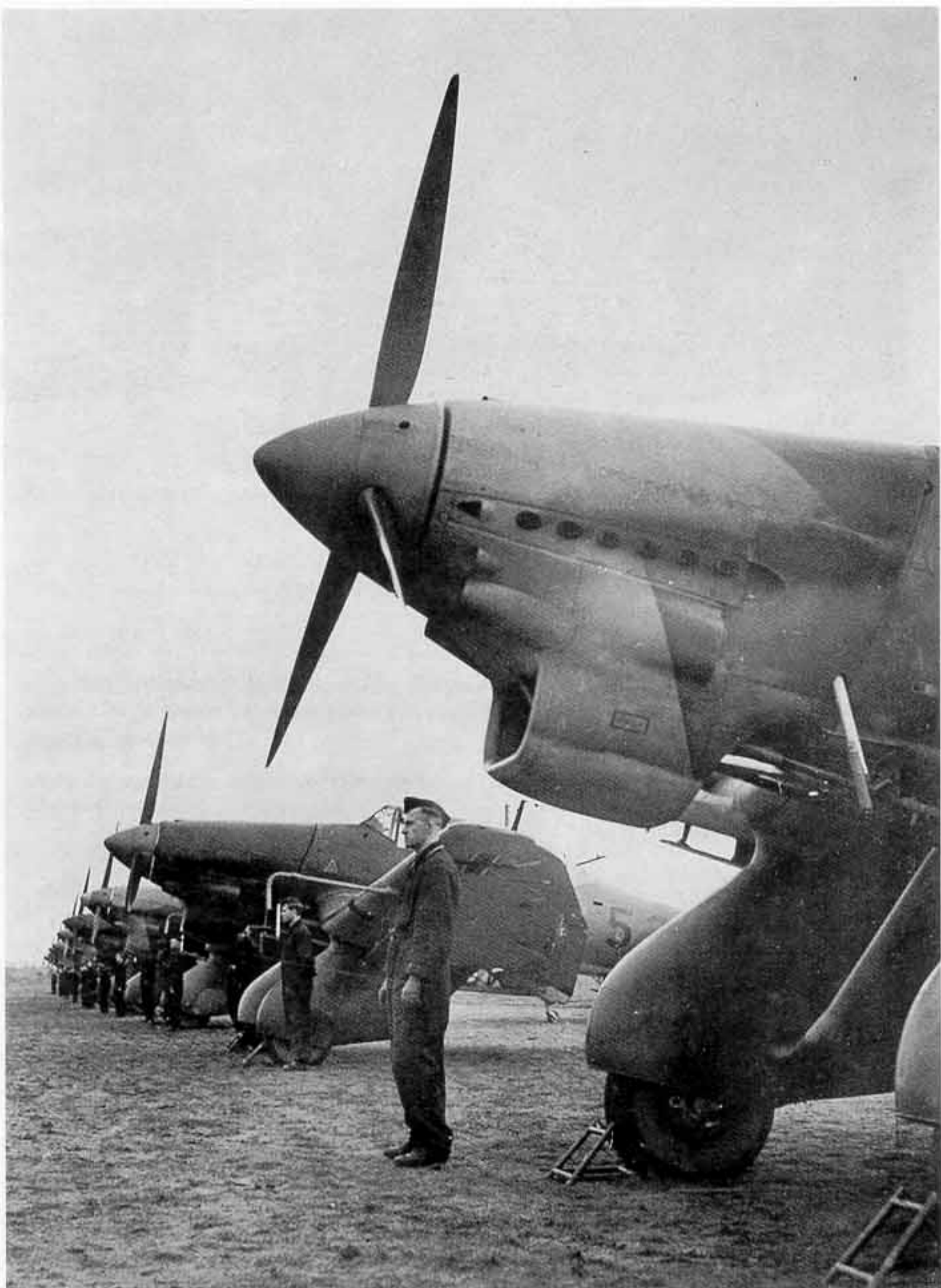
Powyżej: Nos Ju 87 A-1 jednej z niemieckich jednostek. Zdjęcie to doskonale prezentuje szereg szczegółów, włącznie z nietypowym otworem w kolpaku. (Z zb. R. Michulca)
