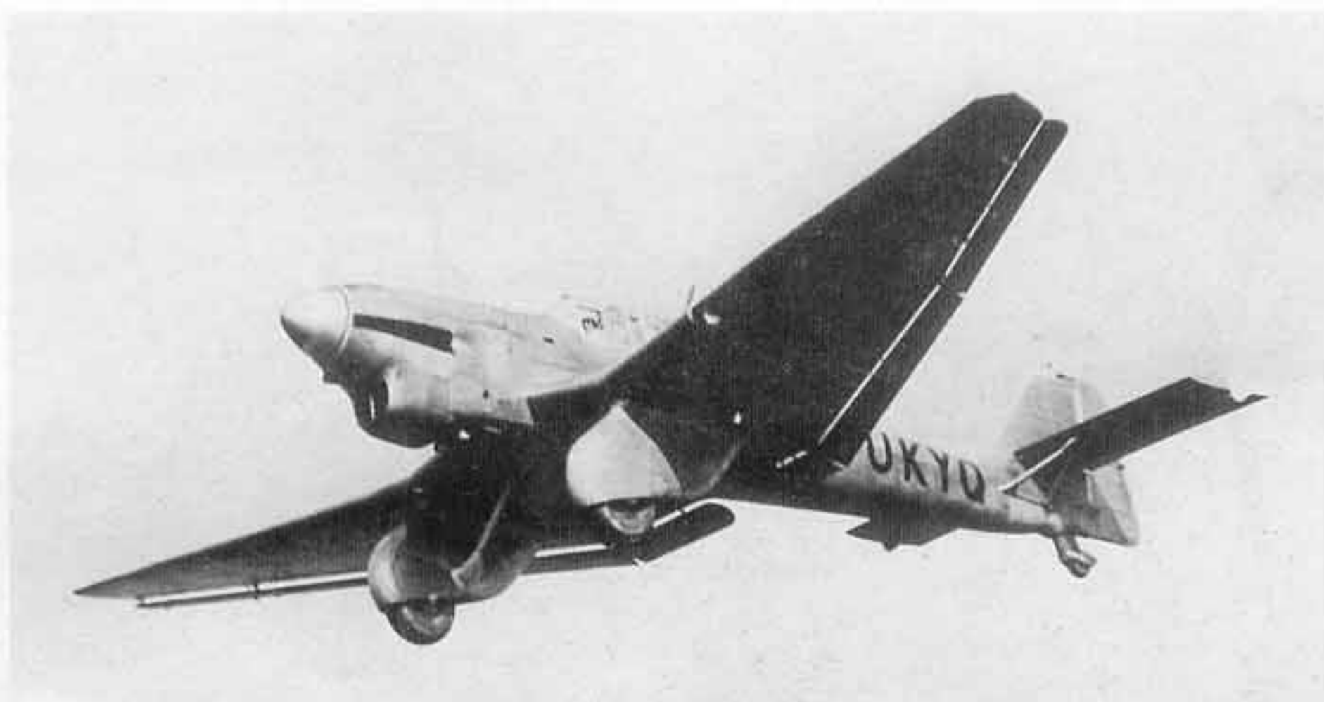
Ju 87 V3, D – UKYQ w locie. Samolot ten, tak jak i jak jego poprzednik V2, posiadał już pojedynczy statecznik pionowy.
