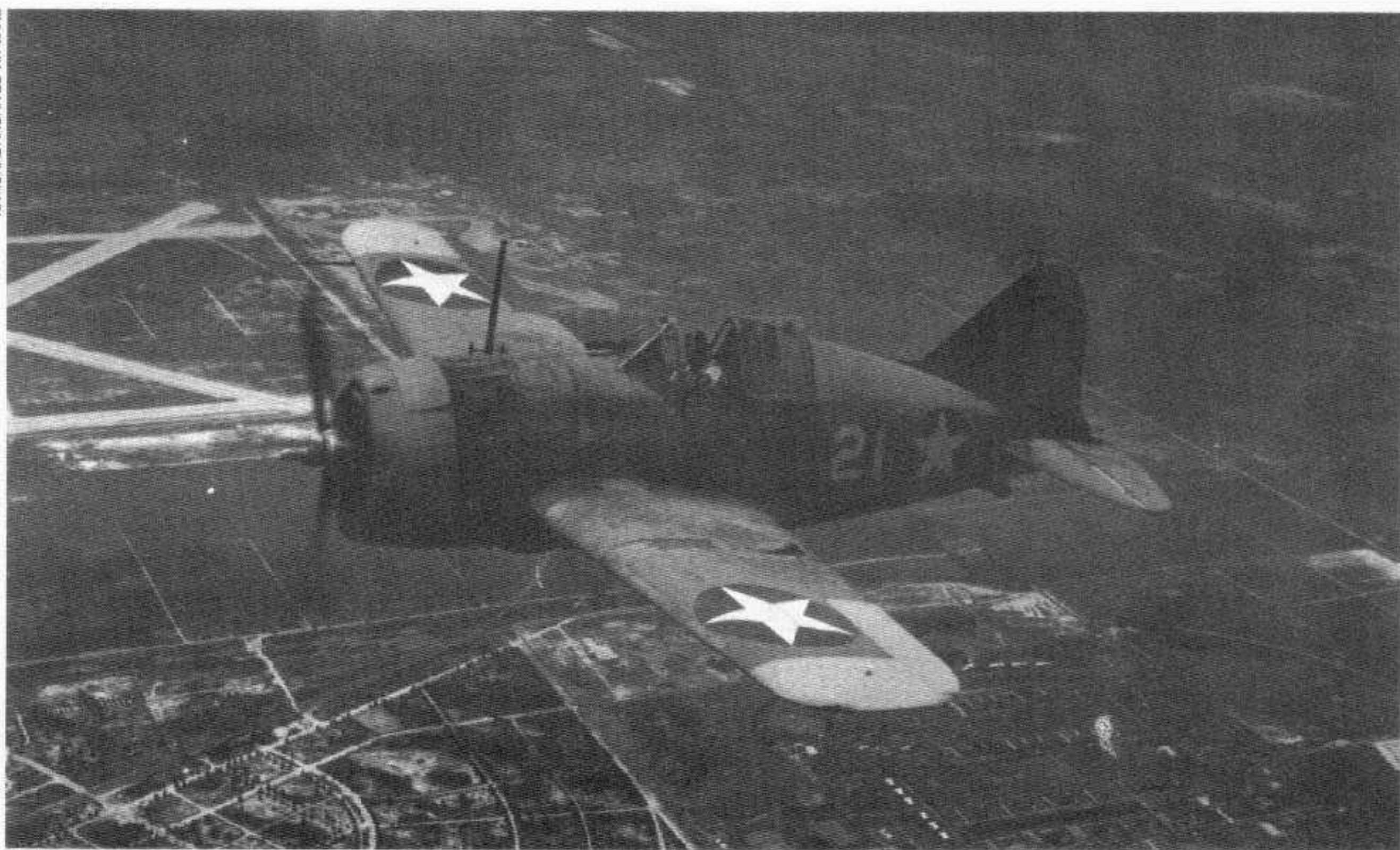
F2A-3, pilotowany przez kmdr ppor. J. C. Cliftona z Naval Air Station Pensacola na Florydzie. Końcówki skrzydeł i statecznik malowano na kolor jasnoszary. Tylna część osłony kabiny pilota zamalowana. Samolot służył do szkolenia pilotów.
