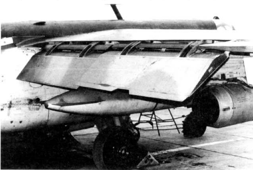
Po lewej: Wychylone dwuszczelinowe kłapy skrzydłowe.
