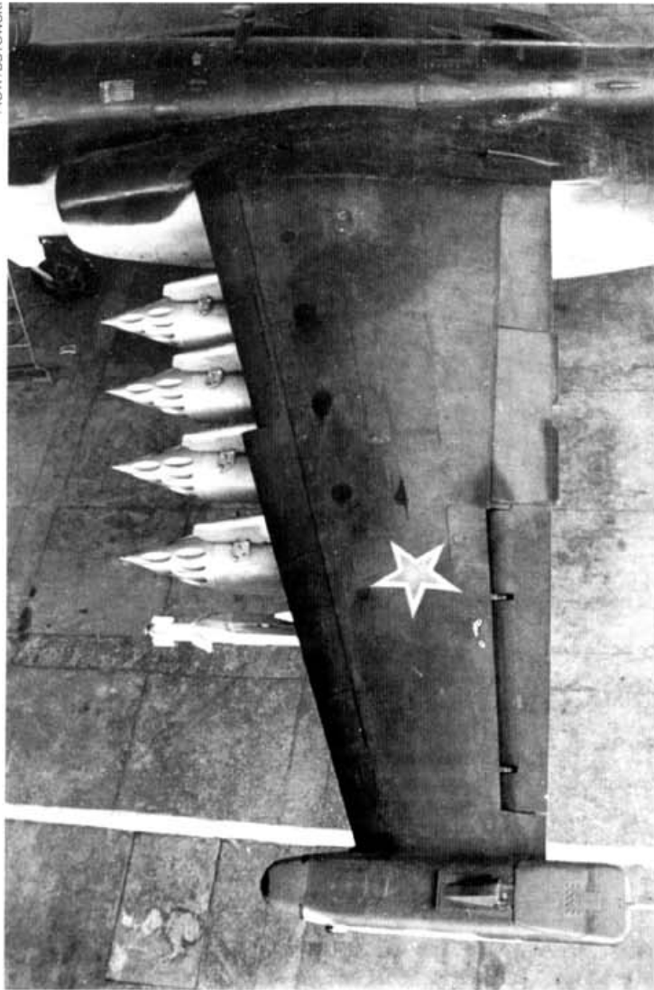
Skrzydło w widoku z góry. Widać uskok krawędzi natarcia, a na krawędzi spływu segmenty klap oraz długą lotkę.
