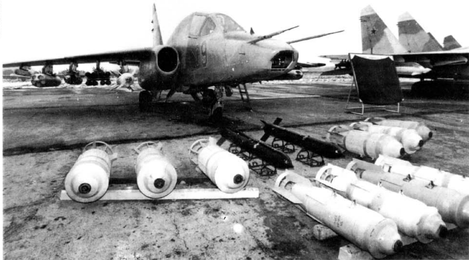
Powyżej i poniżej: Su-25TM na pokazie dla przywódców Wspólnoty Niepodległych Państw w Maculiszczach w lutym 1992 r. Samolot niesie pod skrzydłami rakiety „Wichr”, Ch-29, S-25L, R-60 oraz wyrzutnie B-13. Przed samolotem wyłożone jest uzbrojenie niekierowane: rakiety S-24 oraz bomby FAB-500 i FAB-250.
