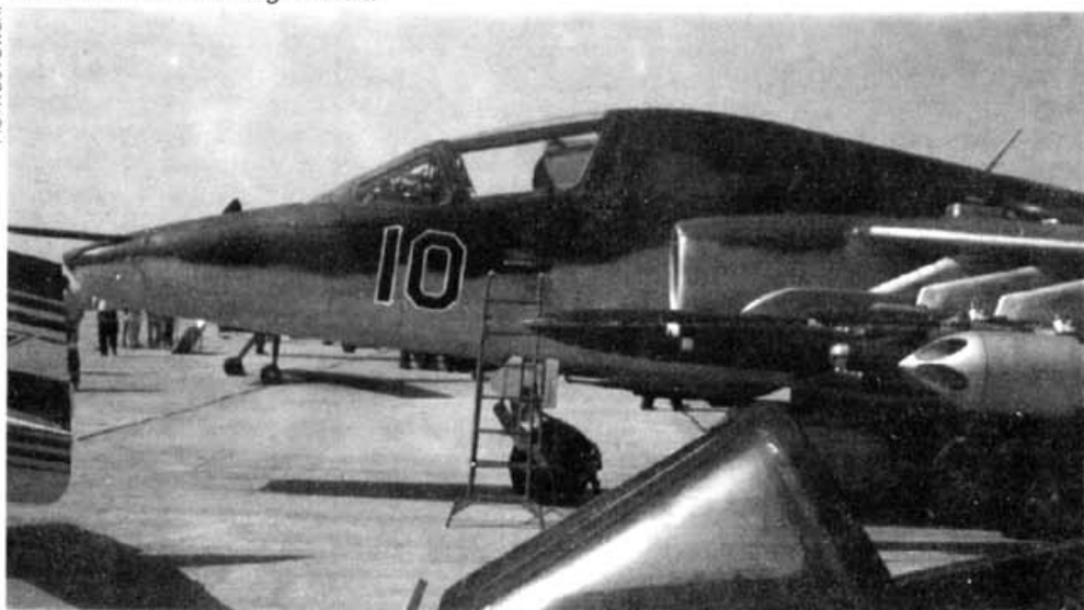
Su-34 (Su-25T) ma konstrukcję analogiczną do szkolno – bojowego Su-25UB, ale w miejsce tylnej kabiny została umieszczona elektronika i dodatkowe paliwo.
