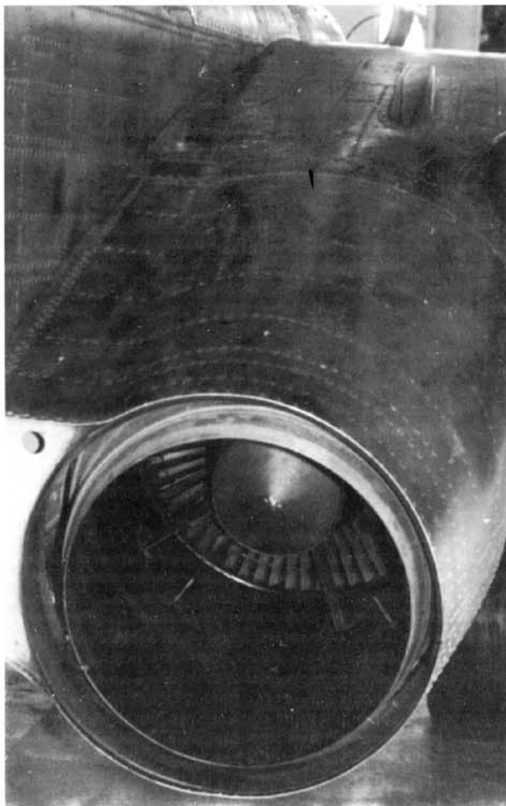
Gondola silnika R-95Sh w widoku z tyłu.
