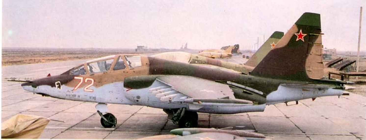
Powyżej: Su-25UB o numerze bocznym 72 i numerze fabrycznym 36188. Proszę zwrócić uwagę na dodatkowe wyrzutnie flar zakłócających na gondoli silnika, a także na wizerunek niedźwiedzia na przodzie kadłuba.
