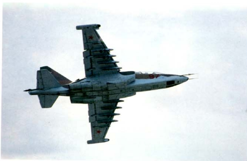
Poniżej: Samolot Su-25TM o numerze fabrycznym 01014 wystawiony w sierpniu 1992 r. w Ramienskoje (Żukowski) pod Moskwą. Pod skrzydłami są zaczepione, patrząc od kadłuba: rakietka przeciwokrętowa Ch-31, wyrzutnia APU-8 z raketami przeciwpancernymi Wichr, kierowana laserowo rakietka S-25L, wyrzutnia B-13 z pięcioma raketami niekierowanymi S-13 i na koniec niewielka R-60 klasy powietrze – powietrze. Pod kadłubem kontener z aparaturą termowizyjną Chod.
