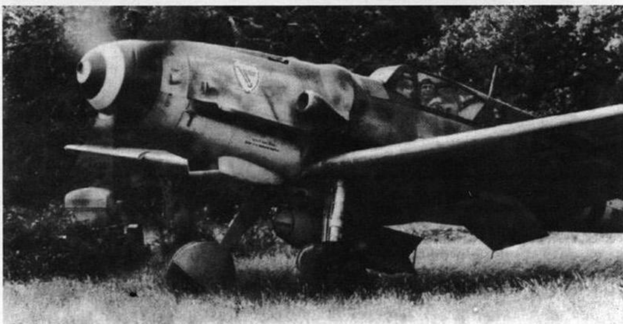
Powyżej: Bf 109 G-5/R1 - prawdopodobnie samolot Maj. Heiza Bära ze Stab. JG 3 nietypowo uzbrojony w bombę SD 500 na zaczepie Sch 500/IXb.
