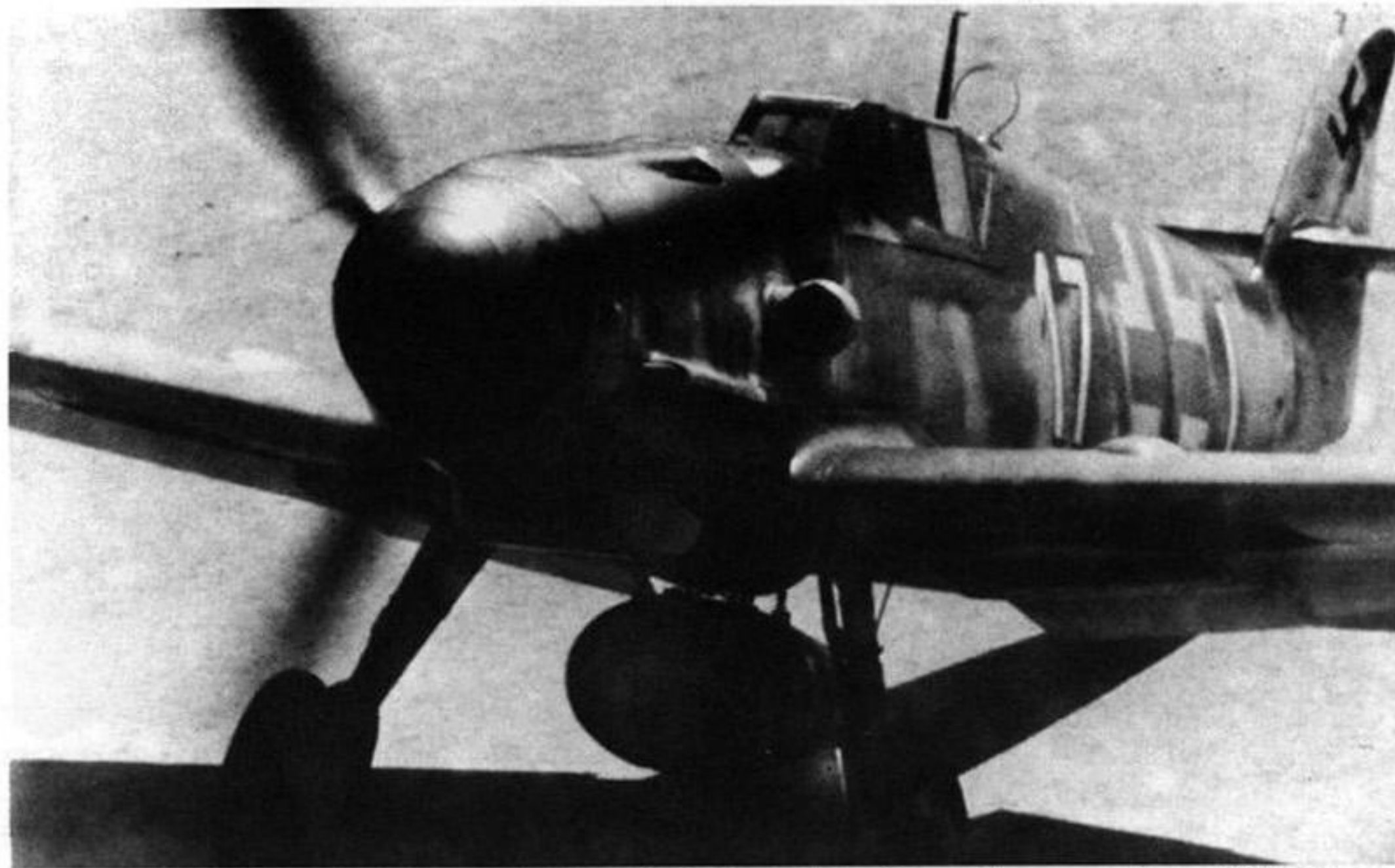
Bf 109 G-6/R3. Pod kadłubem podwieszony dodatkowy zbiornik z paliwem o pojemności 300 l.
