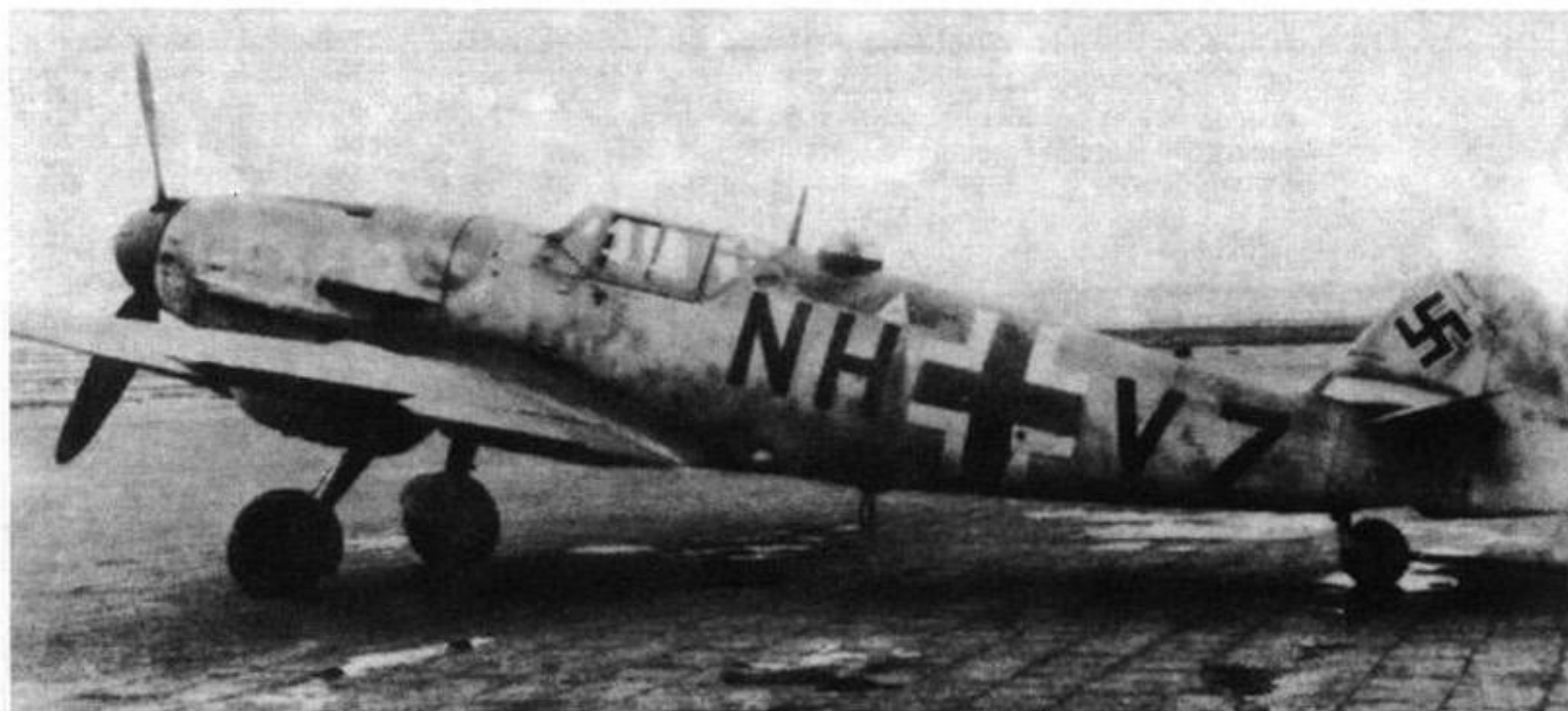
Powyżej: Bf 109 G-6/N (W.Nr 27412) wyposażony w radar FuG 350 Naxos-2, wykrywający impulsy brytyjskich radarów H2S.
