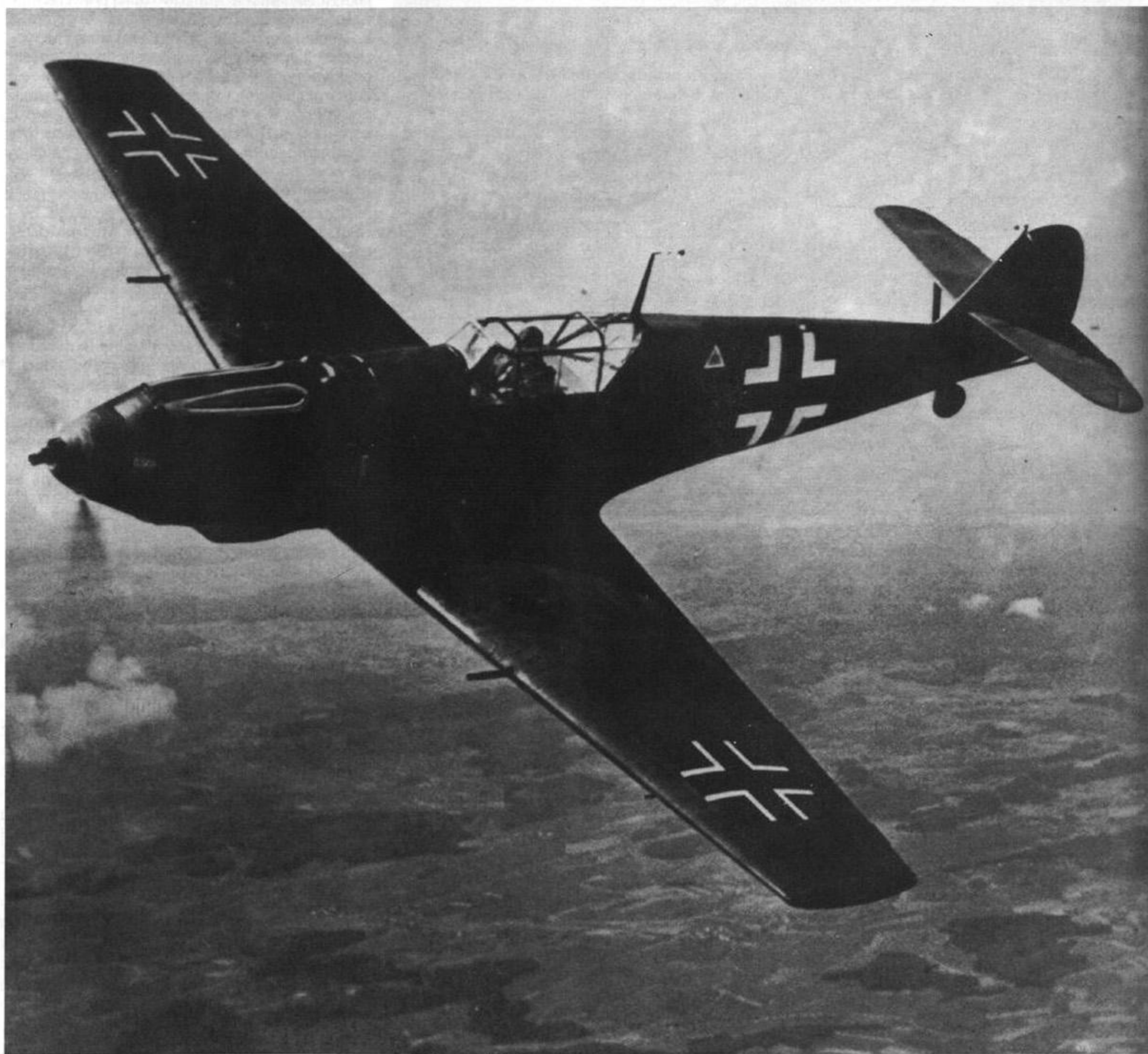
Bf 109 V20 (E-08) w locie. Samolot ten stanowił wzorec dla nieprodukowanej seryjnie odmiany Bf 109 E-2.
