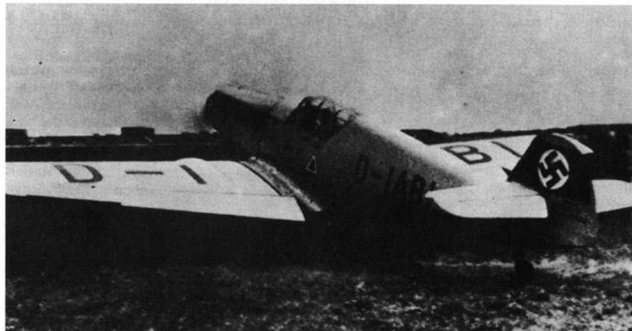
Powyżej i poniżej: Pierwszy prototyp Bf 109 V-1, noszący oznaczenie cywilne D-IABI na lotnisku Ausbürg-Haunstetten. Samolot posiadał silnik Rolls-Royce Kestrel.
