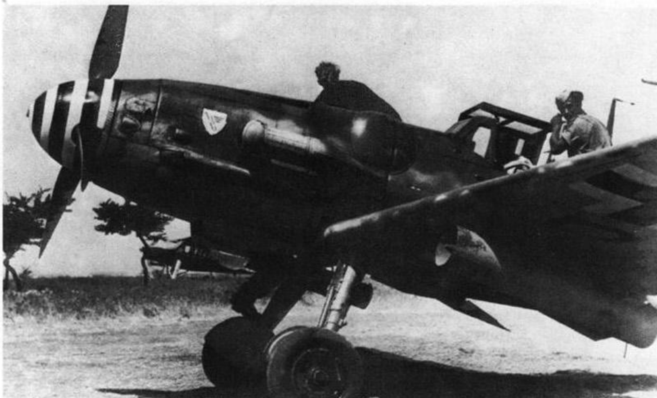
Bf 109 G-5/Trop. z JG 3 Udet, wyposażony w podskrzydłowe wyrzutnie niekierowanych pocisków rakietowych W. Gr 21 kalibru 210 mm. Na masce silnika widoczne godło pułku.
