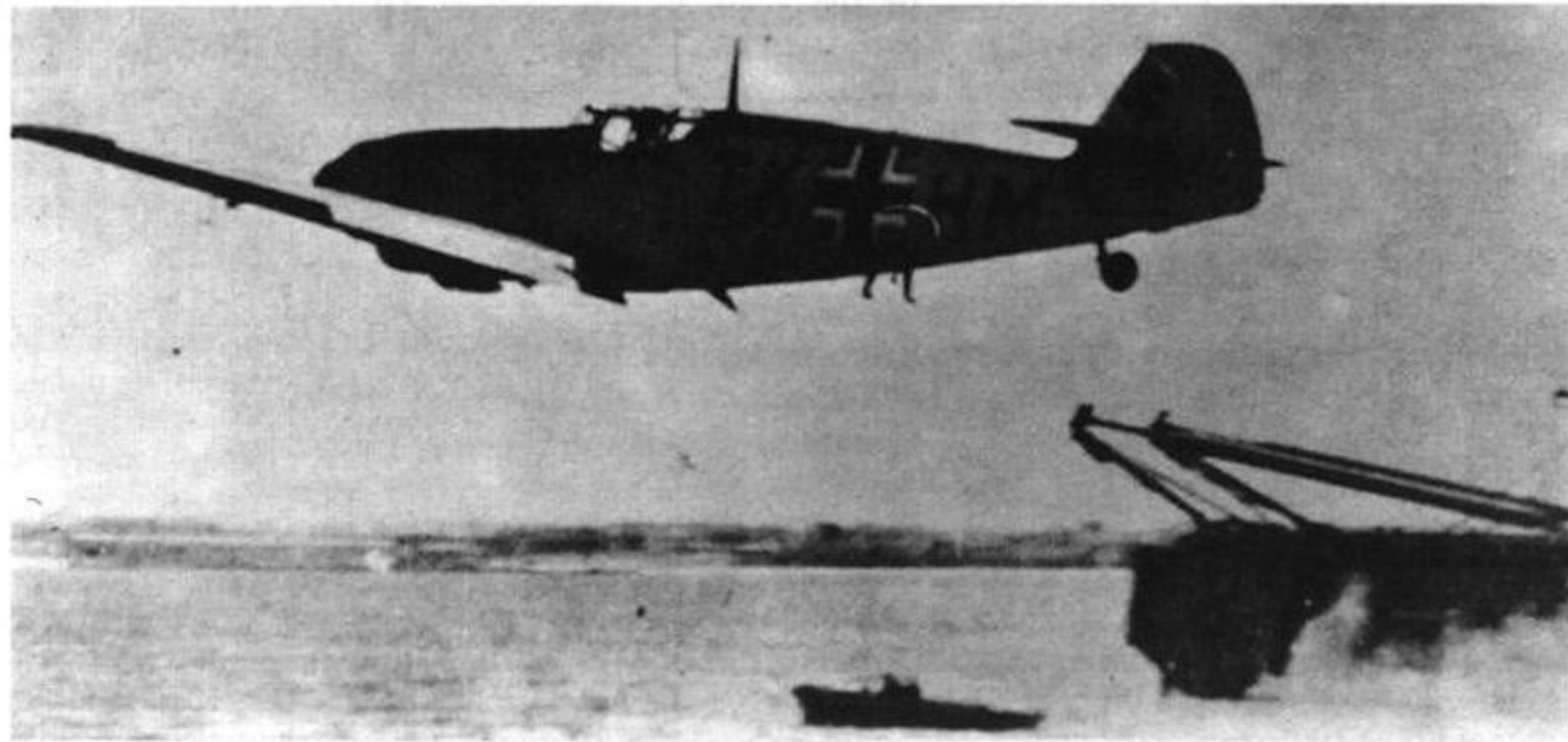
Bf 109 T-0 podczas jednego z próbnych startów z katapulty. Pod krzyżem na kadłubie widoczne zaczepy do katapulty.
