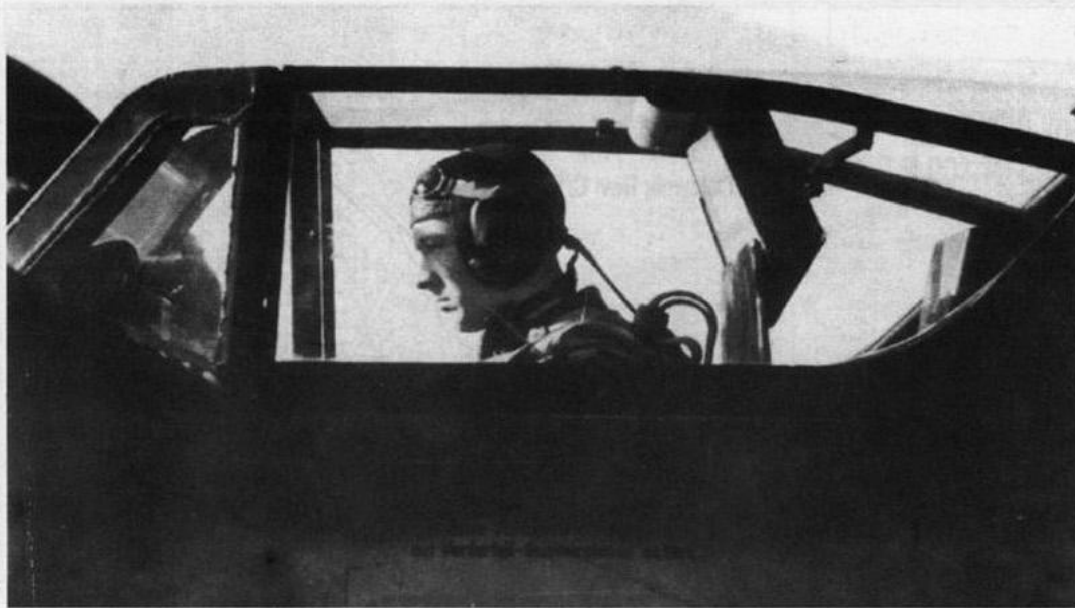
Oslona kabiny późnych odmian Bf 109, tzw. Erla Haube . Za głową pilota widoczna gruba szyba pancerna, tzw. Galland Panzer .
