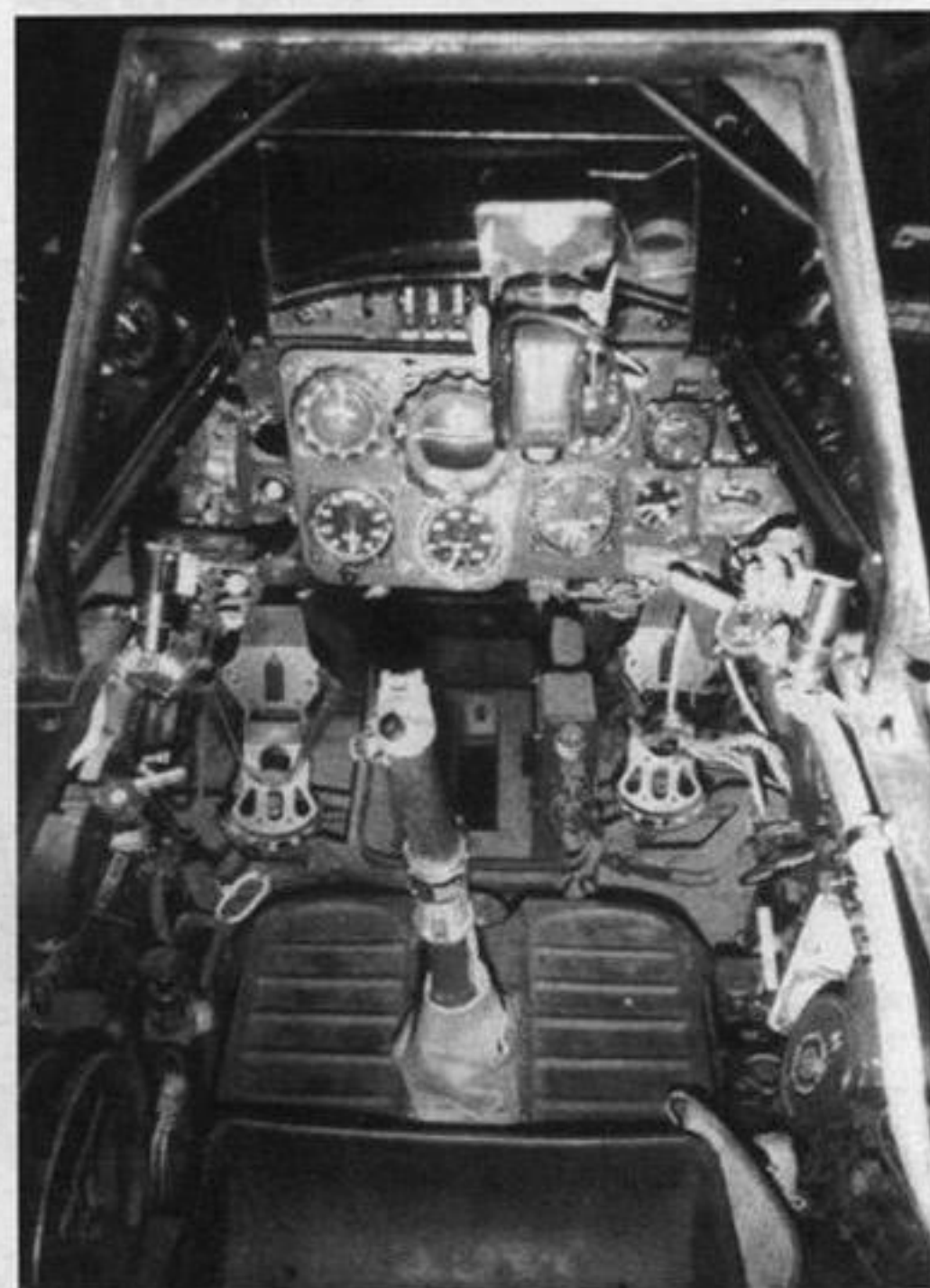
Powyżej: Kabina pilota Bf 109 G-6. Na zdjęciu egz. muzealny ze zdemontowanym działkiem kadłubowym.
