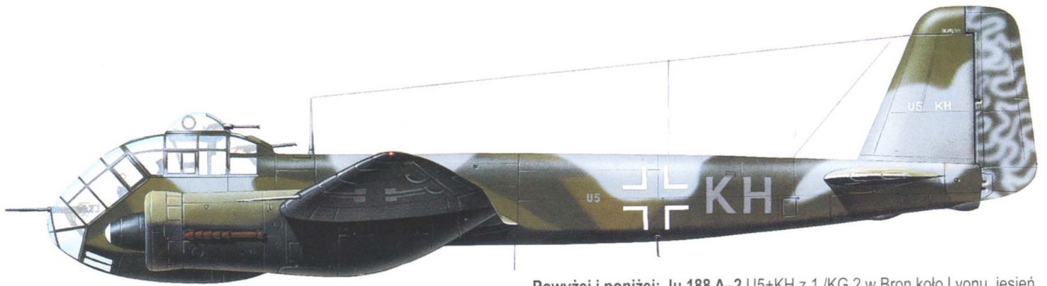
Powyżej i poniżej: Ju 188 A-2 U5+KH z 1./KG 2 w Bron koło Lyonu, jesień 1944 roku. Samolot nosi standardowy kamuflaż (RLM 65/70/71) pokryty plamami RLM 76 na górnych powierzchniach i czarnym kolorem na powierzchniach dolnych.
