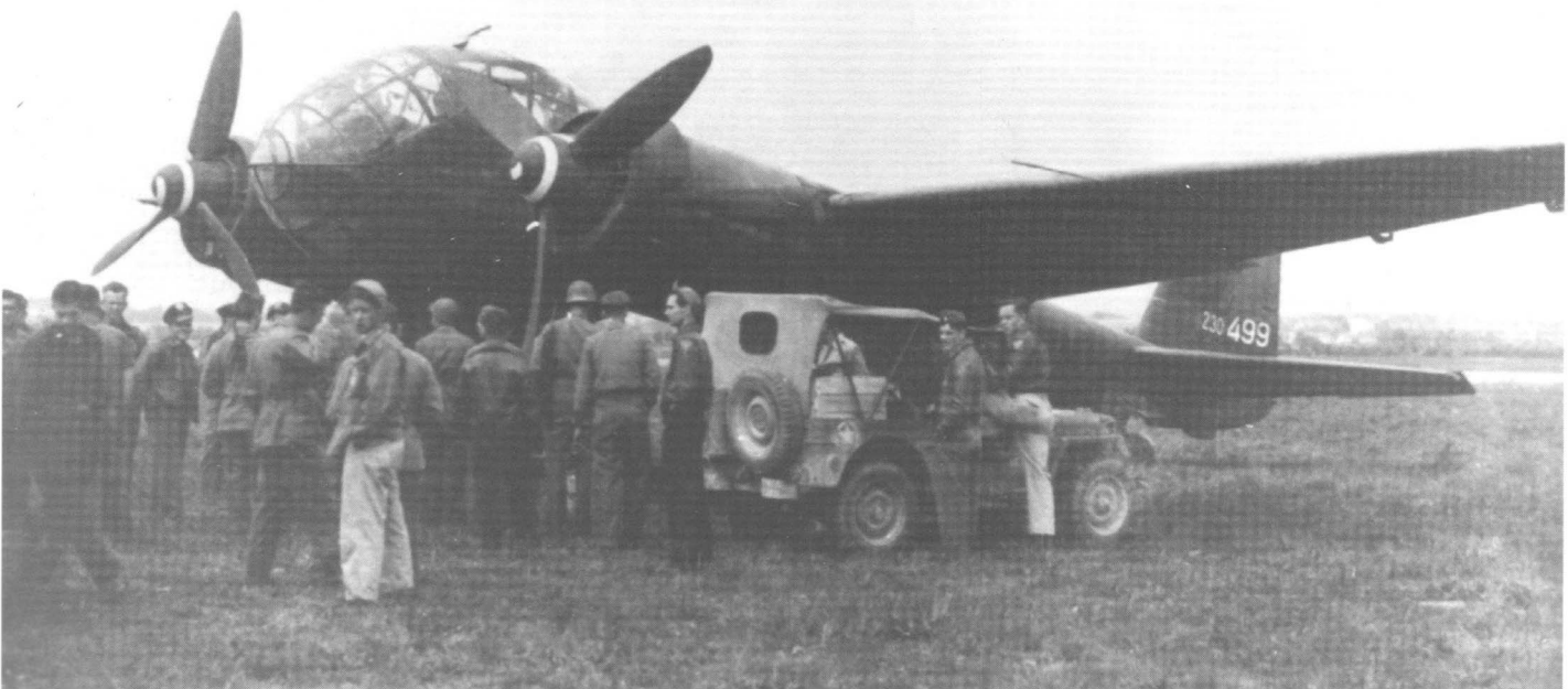
Jeden z Ju 388L pozostawionych przez Niemców na lotnisku operacyjnym Luftwaffe. Warto zwrócić uwagę na element wystający pod lewym skrzydłem. Wydaje się, że może być to antena radaru ostrzegawczego typu FuG 217.
