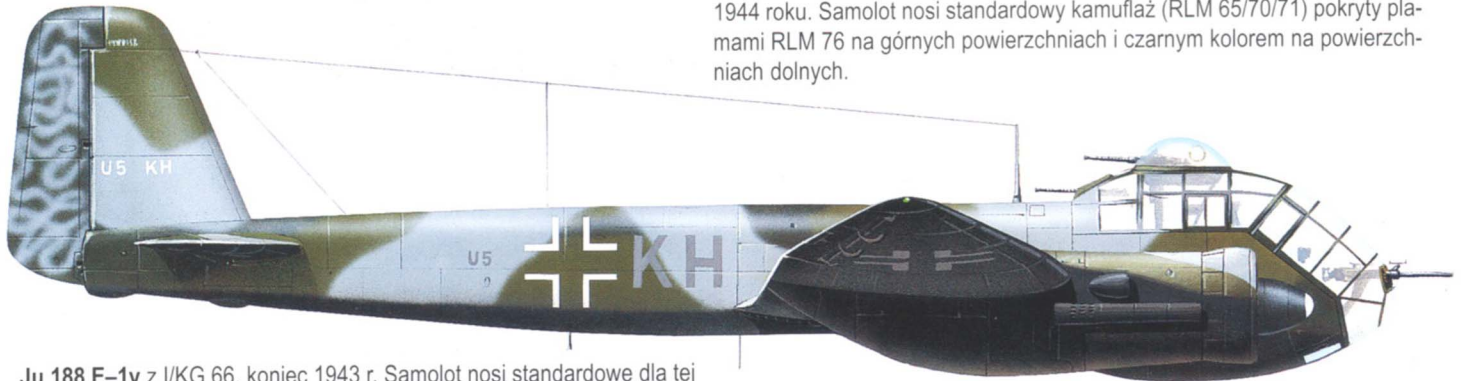
Ju 188 E-1y z I/KG 66, koniec 1943 r. Samolot nosi standardowe dla tej jednostki malowanie, skomponowane w oparciu o kolor czarny i jasnoszary RLM 76. Znaki przynależności państwowej na kadłubie i dolnych powierzchniach skrzydeł w kolorze RLM 77.
