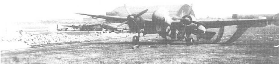
Jeden z Ju 388L pozostawionych przez Niemców na lotnisku operacyjnym Luftwaffe. Warto zwrócić uwagę na element wystający pod lewym skrzydłem. Wydaje się, że może być to antena radaru ostrzegawczego typu FuG 217.
