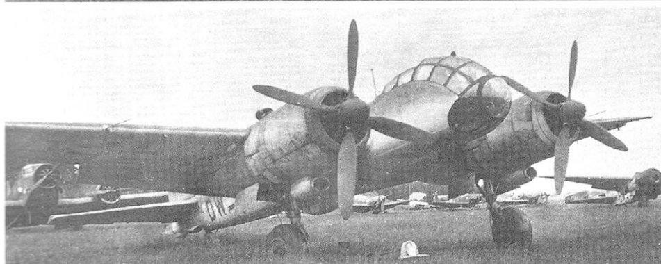
Jeden z prototypów Ju 188 S/T, a potem Ju 388 zdobyty przez Amerykanów w Niemczech, w maju 1945 r. Wyraźnie widać gondolę dla uzbrojenia pod kadłubem oraz kod DW+?? namalowany na kadłubie i skrzydle.
