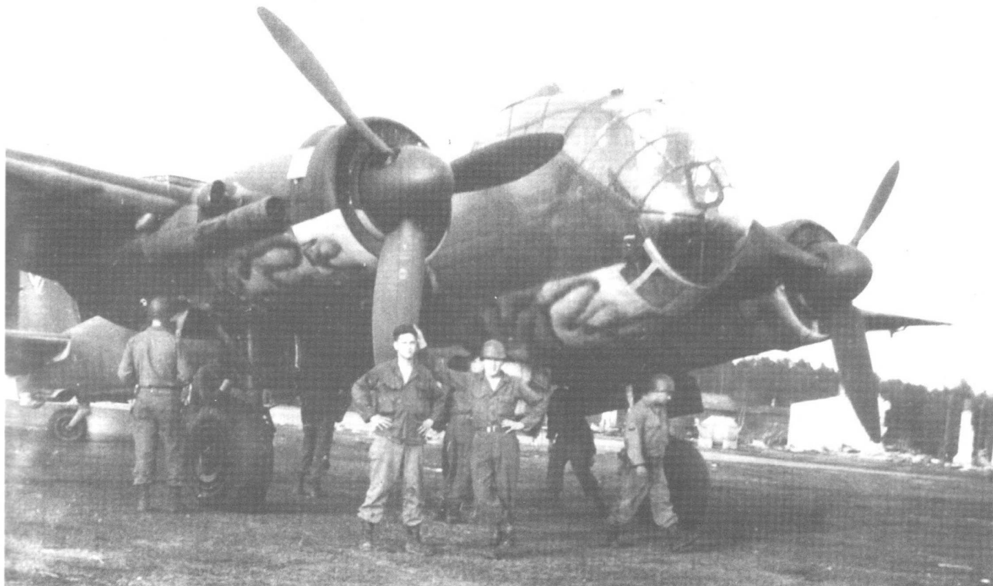
Ju 188 D-2 znaleziony przez Amerykanów w Ebendorf koło Magdeburga w maju 1945 roku. Mimo, że samolot został przystosowany do lotów w nocy, to jednak jego dolne powierzchnie pomalowano niezbyt dokładnie w zawijsy „Wellenmuster“. Prawdopodobnie użyto do tego czarnej farby.
