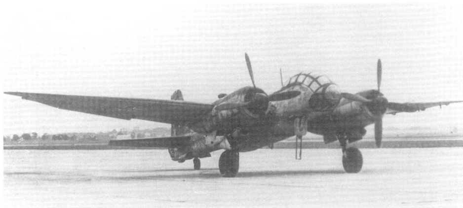
Poniżej: Ju 388 L-1 wystawiony w jednej z amerykańskich baz, wciąż noszący niemieckie znaki, ale z kodem już zmienionym na T2-4010. Warto zwrócić uwagę na aliancki radionamiernik zabudowany na górze kadłuba. Zmianom uległa prawdopodobnie także część oryginalnej instalacji radiowej i radiowo-nawigacyjnej.
