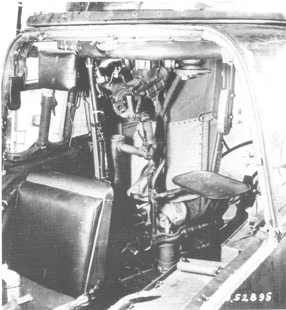
Poniżej: Wczesna wersja stanowiska tylnego strzelca z opancerzoną obrotnicą MG 131.
