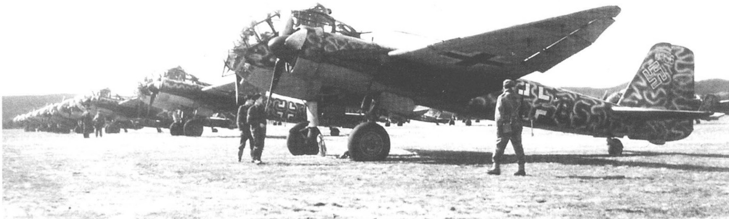
Szereg torpedowych Ju 88A z KG 26 na jednym z lotnisk Norwegii, tuż po zakończeniu działań wojennych. Wszystkie maszyny noszą taki sam kamuflaż, złożony z jasno niebieskich zawijasów, naniesionych na standardowy kamuflaż 70/71. Kody samolotów były ograniczone tylko do dwóch końcowych liter (eskadry i samolotu). Na pierwszym samolocie dobrze widoczne są anteny urządzenia FuG 101.
