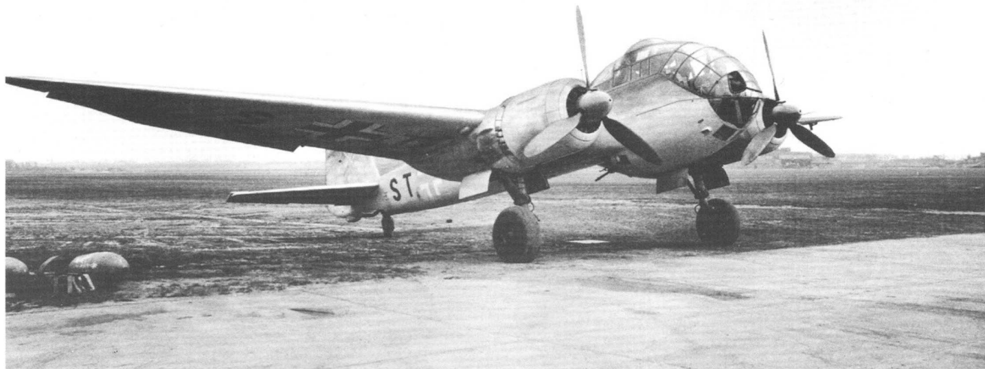
Powyżej i poniżej: Ju 188E przebudowany na samolot dyspozycyjny dla E. Milcha. W tylnej komorze bombowej zabudowano niewielkąabinę pasażerską z dwoma okrągłymi oknami po obu stronach kadłuba. Na powyższym zdjęciu dobrze widoczny jest kaem MG 131 zainstalowany w miejsce standardowego działka MG 151/20, oraz okienko zamiast celownika bombowego. Na lewo od niego widoczny jest wyrzutnik lusek.
