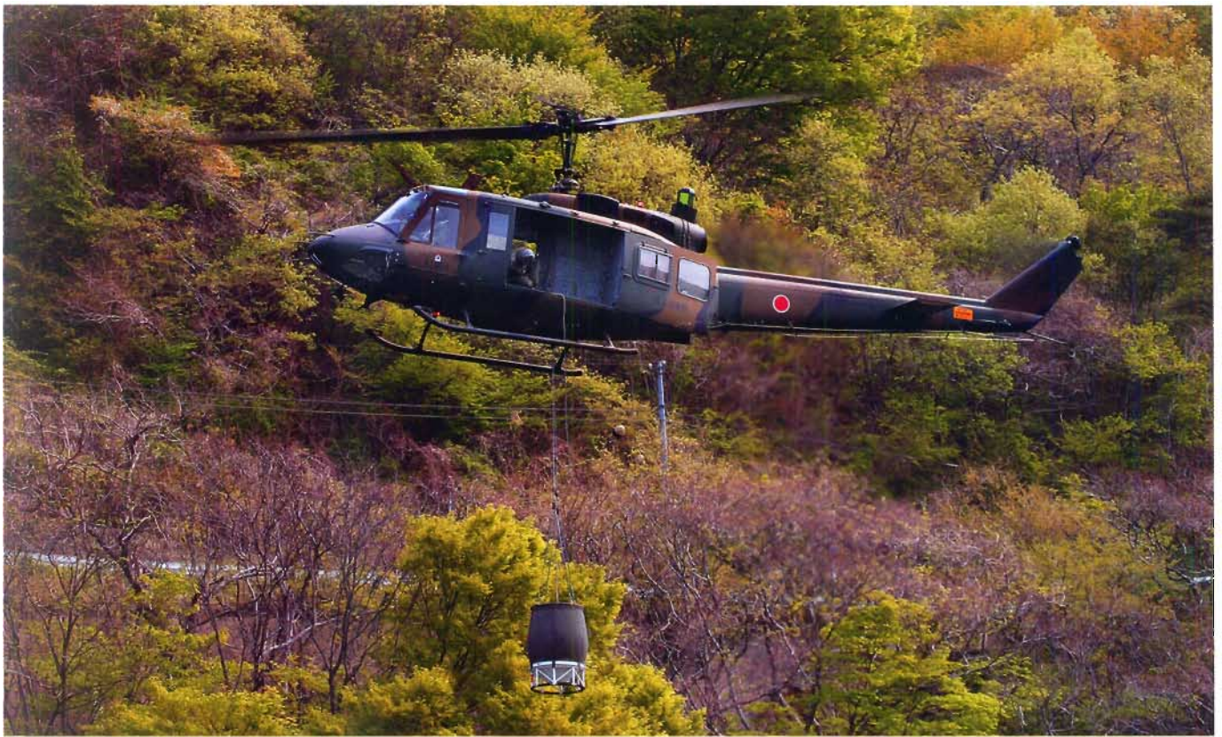
▲ Śmigłowiec TH-1H należący do Sił Powietrznych Japonii podczas ćwiczeń przeciwpożarowych. Zwraca uwagę pojemnik na wodę, która jest uzupełniana z naturalnych zbiorników wodnych / Kazuteru Sugawara
