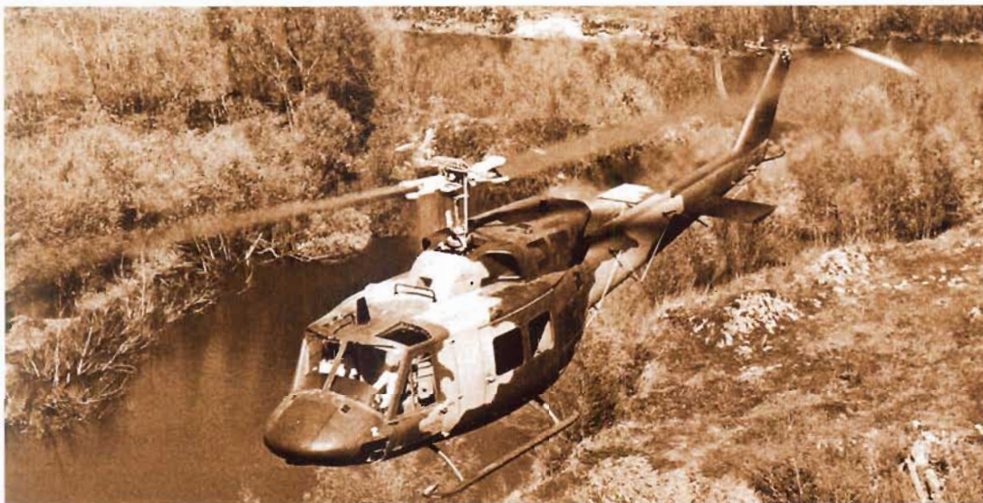
▲ UH-1N podczas ćwiczeń w środkowych Stanach Zjednoczonych. Podwójne silniki Pratt & Whitney dają łączną moc 1800 KM (1343 kW), pozwalając na osiągnięcie maksymalnej prędkości 205 km/h. Natomiast pułap lotu tego śmigłowca to 5275 m n.p.m. / Bell
