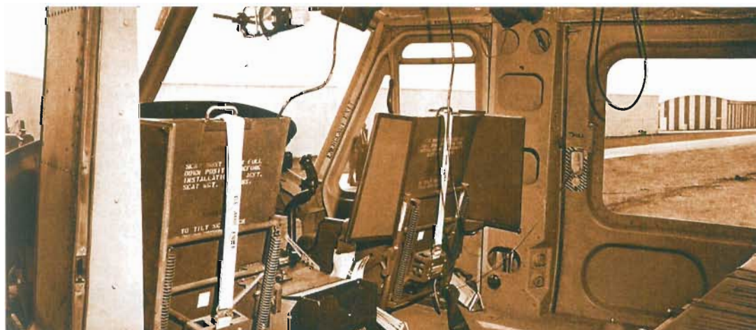
◀ Wnętrze Hueyów B, C i M było takie samo. Na tym zdjęciu dobrze widoczne są płyty pancerne chroniące pilotów, które zaczęto montować podczas wojny w Wietnamie / Bell
