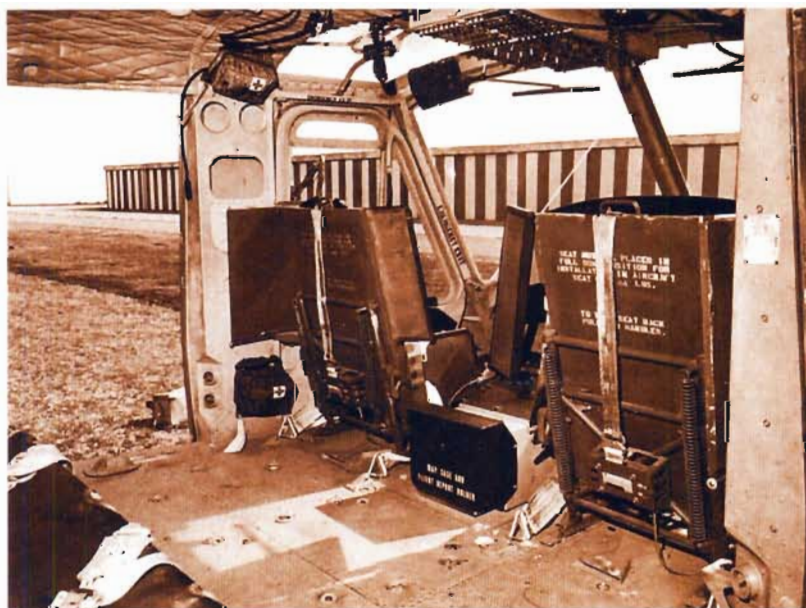
▲ Konstrukcja Hueya zapewniała doskonały widok nie tylko z kabiny pilotów, ale również z przedziału transportowego. Zwracają uwagę opancerzone fotele UH-1B / Bell
