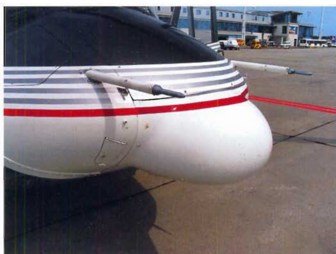
▲ Najbardziej charakterystyczny element całej rodziny Hueyów — szeroki i płaski nos. Na zdjęciu doskonale widać rurki Pitota oraz radar pogodowy / Patryk Janda
