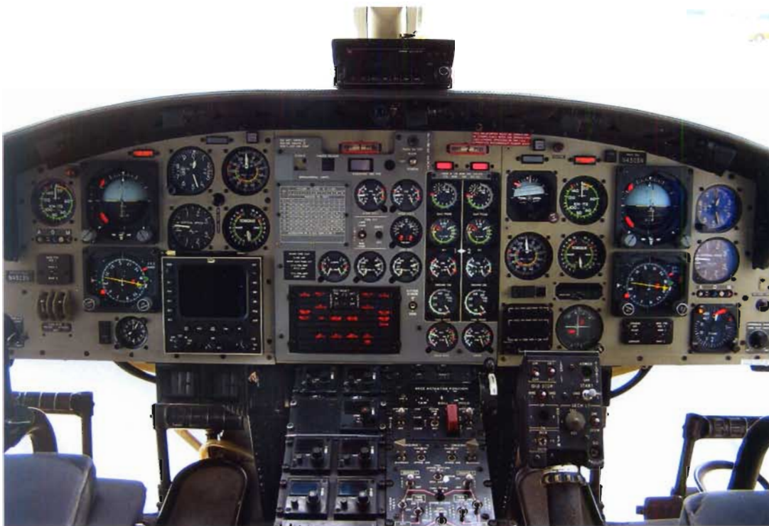
◀ Główny panel śmigłowca Bell 412 HP. U dołu zdjęcia można zauważyć napis BELL na pedalach / Patryk Janda
