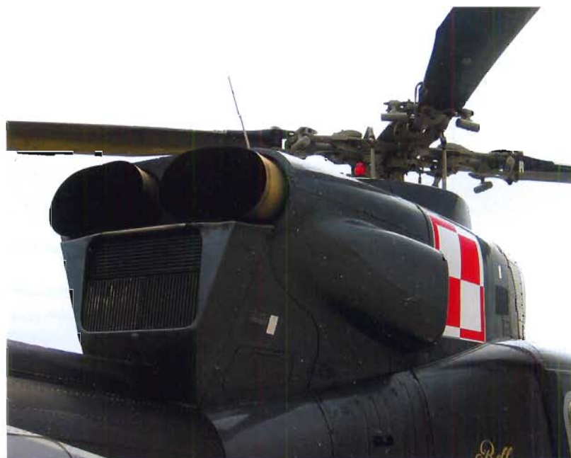
▲ Przedział silnikowy w ujęciu od tyłu z prawej strony. Widoczne są dwie dysze wydechowe odprowadzające spaliny z turbin / Patryk Janda
