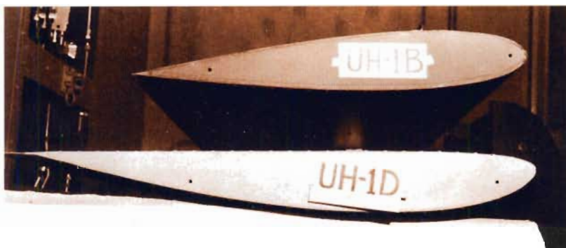
▲ Porównanie stateczników poziomych śmigłowca UH-1B i UH-1D. Wraz z „rozciągnięciem” kadłuba wersji D powiększono również powierzchnię usterzenia poziomego / Bell
