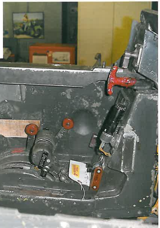
◀ Przednia lewa część kabiny pilota odrestaurowywanego He 219. Widoczne są dźwignie sterowania silnikami oraz pokręta trymerów (pośrodku zdjęcia) / Jim Rotramel via Marek Ryś
