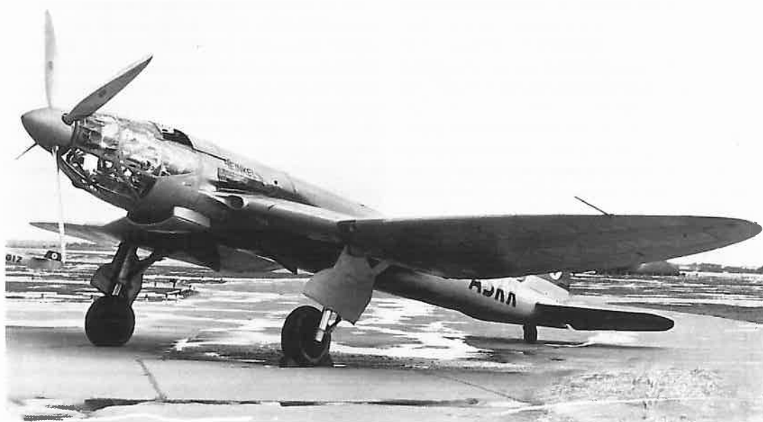
▲► Protoplasta koncepcji P 1055 — He 119, którego napęd stanowił 24-cylindrowy silnik rzędowy DB 606, stanowiący połączenie dwóch DB 601 z dodatkowym wspólnym reduktorem. Na obu zdjęciach widoczny jest drugi prototyp — He 119 V2
