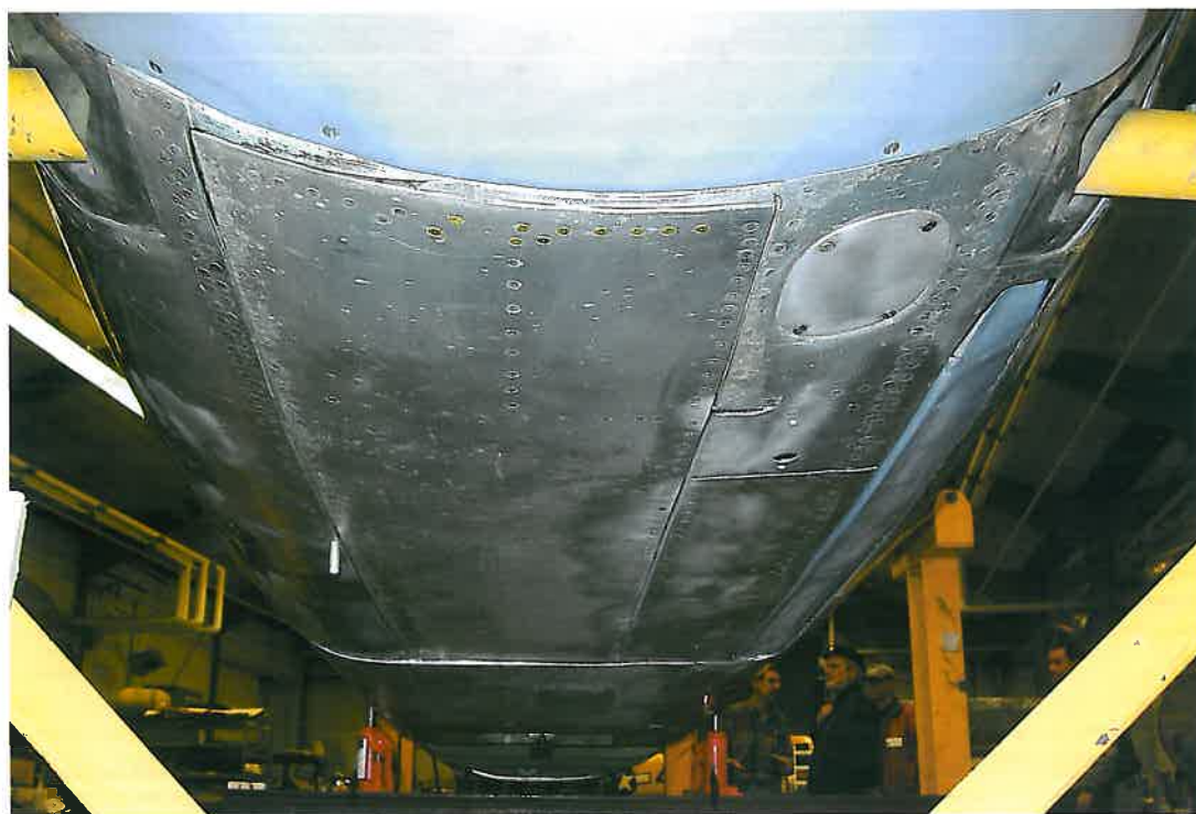
◀▲ Dolna część kadłuba He 219 podczas prac renowacyjnych / Howard Mason via Marek Ryś
