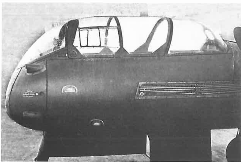
▲ Przednia część kadłuba pierwszego prototypu He 219 ze zdjętymi bocznymi panelami. W tylnej części osłony widoczny jest otwór na karabin maszynowy MG 131, z którego ostatecznie zrezygnowano
