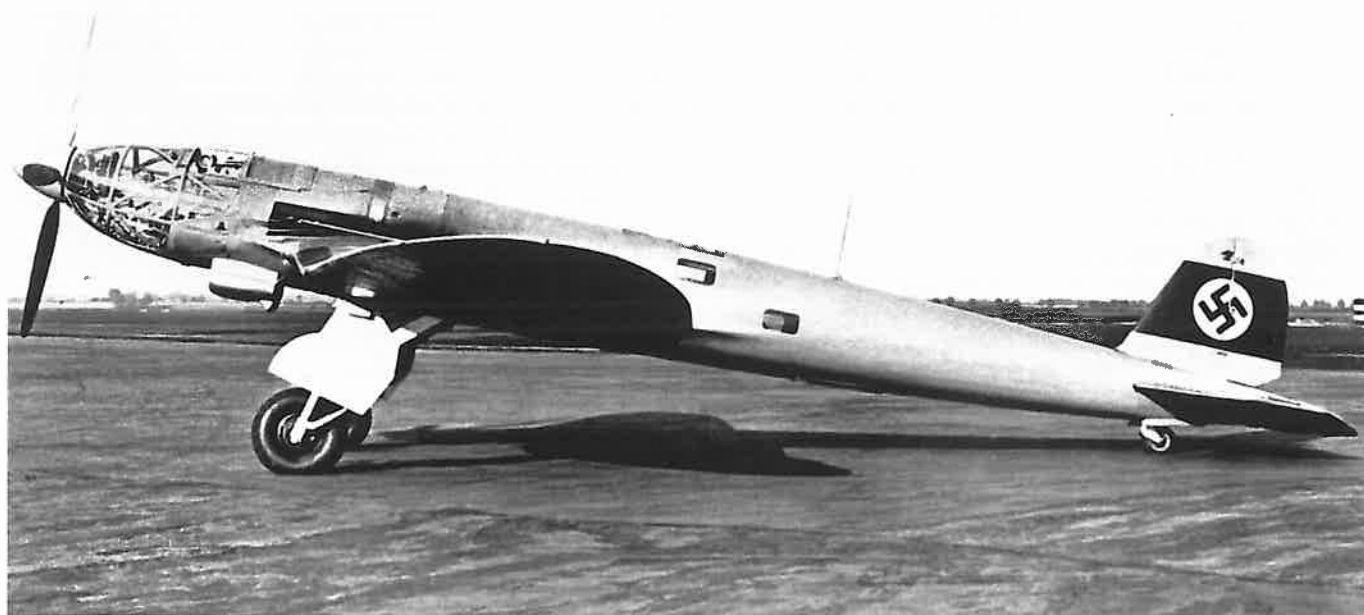
▲► Protoplasta koncepcji P 1055 — He 119, którego napęd stanowił 24-cylindrowy silnik rzędowy DB 606, stanowiący połączenie dwóch DB 601 z dodatkowym wspólnym reduktorem. Na obu zdjęciach widoczny jest drugi prototyp — He 119 V2
