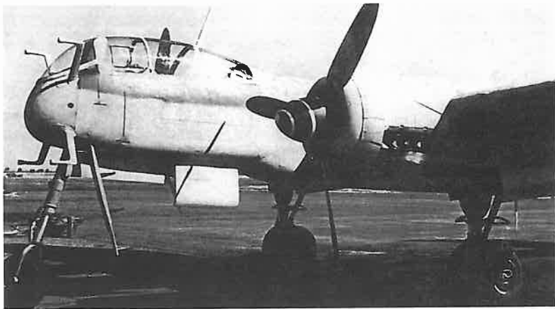
◀ Jeden z He 219 A-2 w Oranienburgu, ze zdjętymi z rur wydechowych tłumikami płomieni i ze zdemontowanymi antenami radaru
