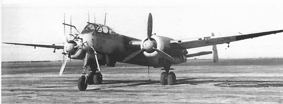
◀▲ Dwa ujęcia He 219 A-016 (V16), W.Nr. 190016, RL+AJ, uznawanego za prototyp wersji A-5/R1. Samolot wyposażony jest w zestaw składający się z radaru FuG 220 (A) Lichtenstein SN2 oraz FuG 212 Lichtenstein C1
