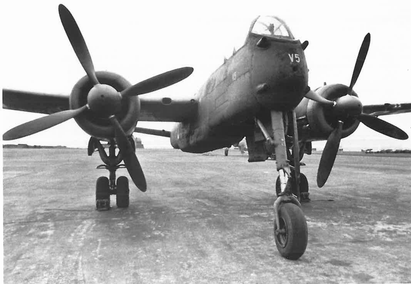
▲ Nieco tajemniczy He 219 V5 W.Nr. 190005, GE+FN, wyposażony w czteropłatowe śmigła i z uskokiem pod kadłubem
