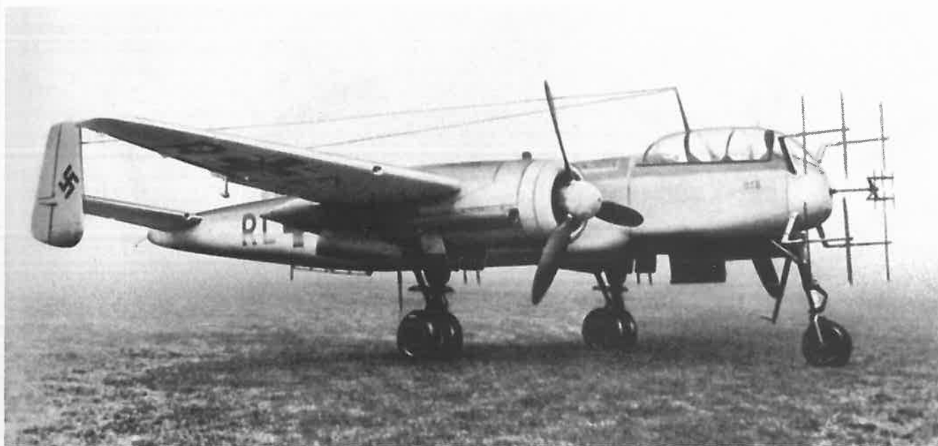
◀▲ Dwa ujęcia He 219 A-016 (V16), W.Nr. 190016, RL+AJ, uznawanego za prototyp wersji A-5/R1. Samolot wyposażony jest w zestaw składający się z radaru FuG 220 (A) Lichtenstein SN2 oraz FuG 212 Lichtenstein C1
