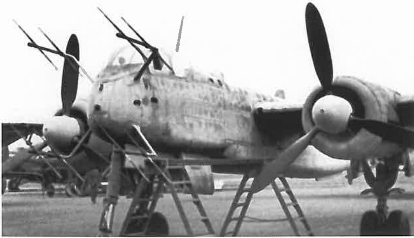
▲ He 219 A-7 lub A-5 z radiolokatorem FuG 220 późnych serii z ukośnymi dipolami anten. Zdjęcie zrobiono w Farnborough po wojnie.
