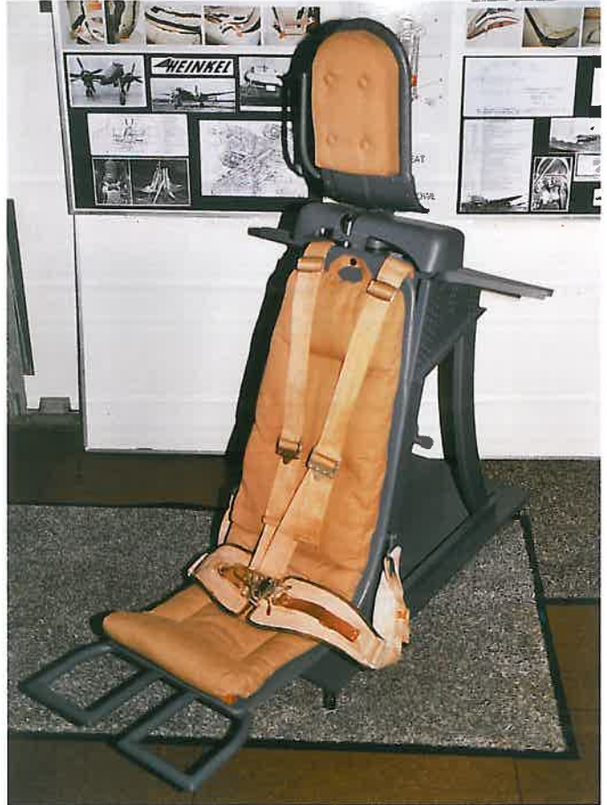
Rekonstrukcja fotela wyrzucanego pomysłu Heinkla zastosowanego w He 219 / Museum Flugsicherheit und Rettung e.V. via Marek Ryś
