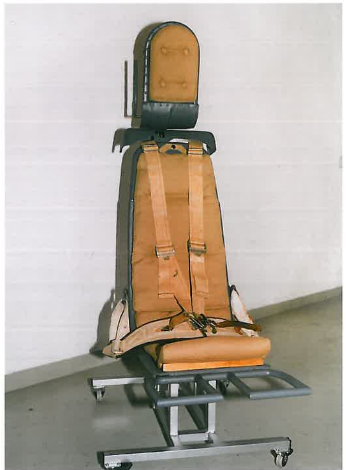
Rekonstrukcja fotela wyrzucanego pomysłu Heinkla zastosowanego w He 219 / Museum Flugsicherheit und Rettung e.V. via Marek Ryś
