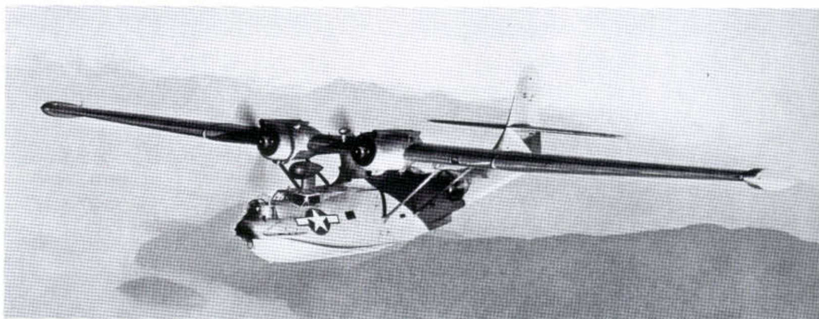
► PB2B-2 — jeden z kilku używanych przez US Navy. Posiadał on ogon Nomada , kopułkę radaru i wieżyczkę „Eyeball” oraz instalację przeciwooblodzeniową / National Archives
