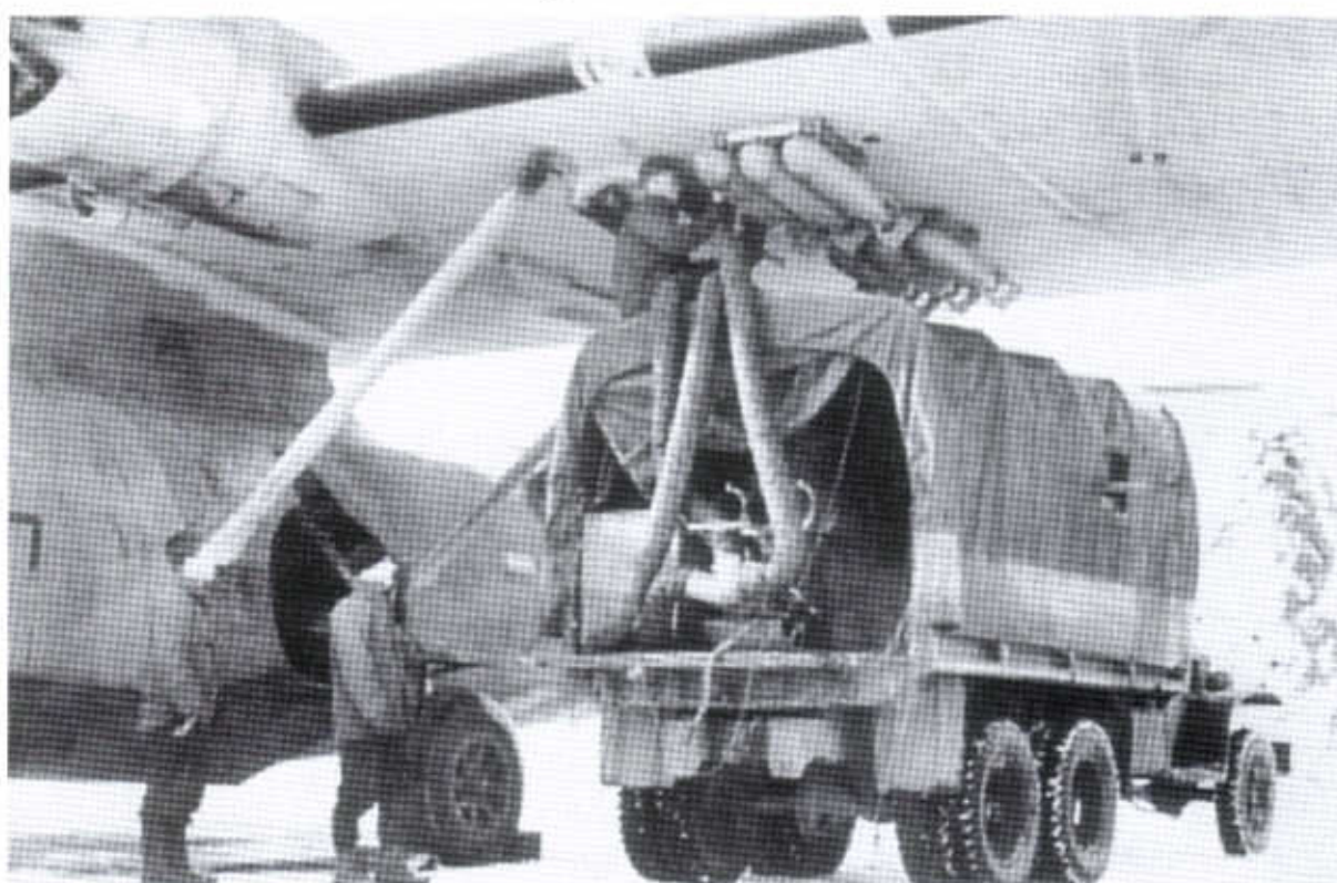
▼ Na Alasce mechanicy musieli pracować w bardzo niskich temperaturach, więc często wykorzystywali do pomocy prowizoryczne namioty. Pod skrzydłem PBY-5 dwie bomby głębinowe. Widać również antenę radaru Yagi / National Archives
