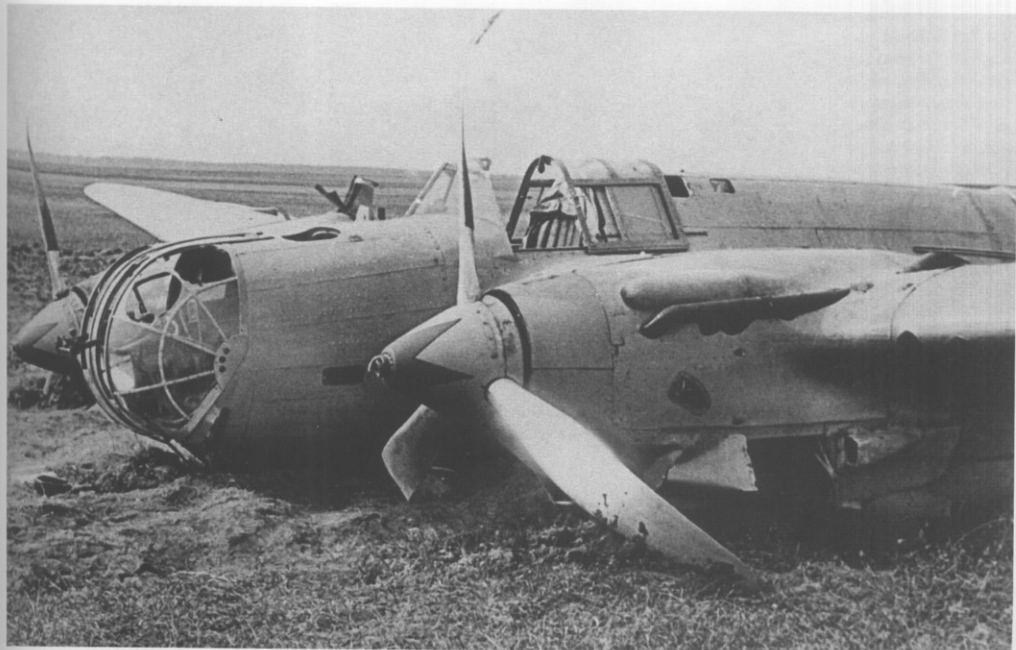
▲► SB-2 tzw. bis zmuszony do lądowania przez Niemców latem 1941 roku. Samolot nosi stary typ kamuflażu, który przestał być наносzony w połowie 1940 roku. Uwagę zwracają czerwone gwiazdy w czarnych obwódkach, namalowane na kołpakach. Na tylnych częściach łopatek śmigiel widać wyraźnie czarną farbę / CAN via R. Michulec
