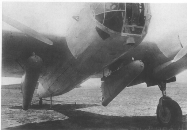
▲ SB-2M-103 ze zbiornikami na substancje chemiczne WAP-500 w czasie prób państwowych, przeprowadzonych w okresie od 27 lipca do 19 września 1938 roku / via W. Kulikow
