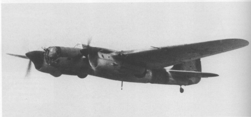
▼ SB-2M-103 wykorzystywany jako holownik szybowca A-7. Szybowiec mocowany jest na hoku sztywnym / via W. Kulikov
