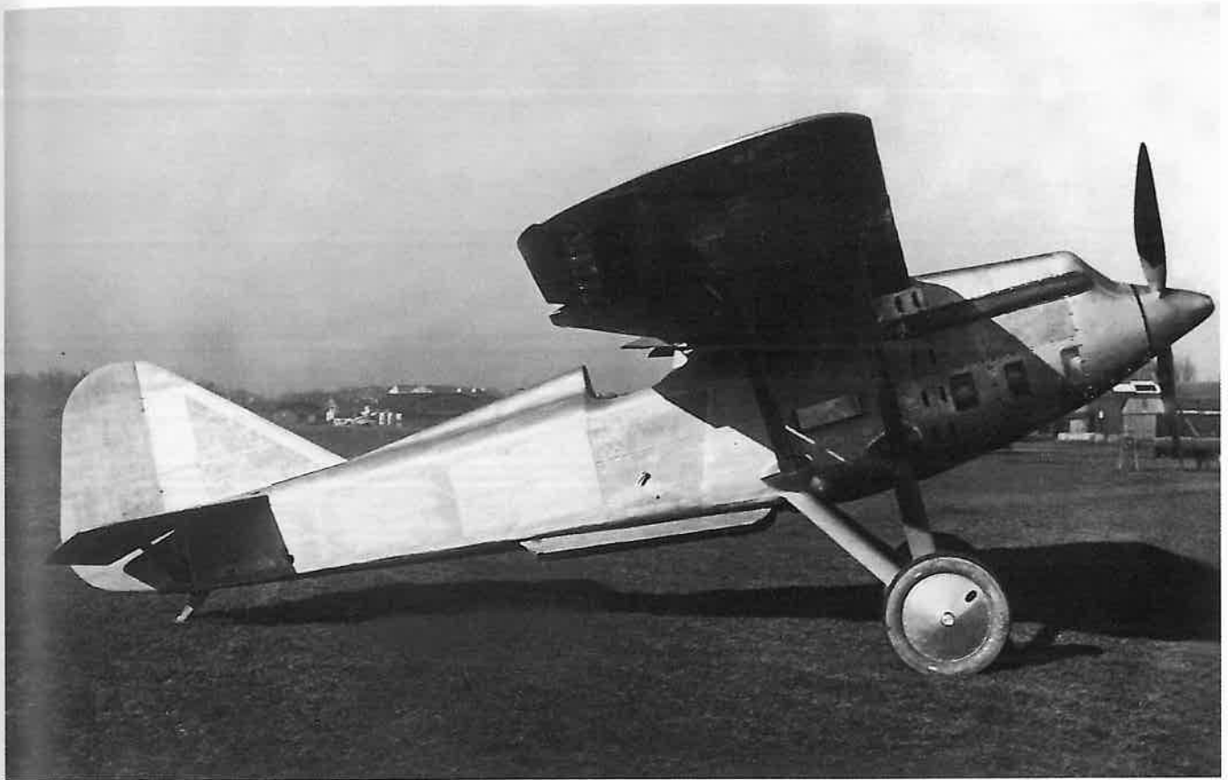
Powyżej: PZL P.8/II w swej pierwszej wersji z chłodnicą pod kabiną. Above: The PZL P.8/II in its initial version with the radiator under the cockpit. (via T. Żychiewicz)
