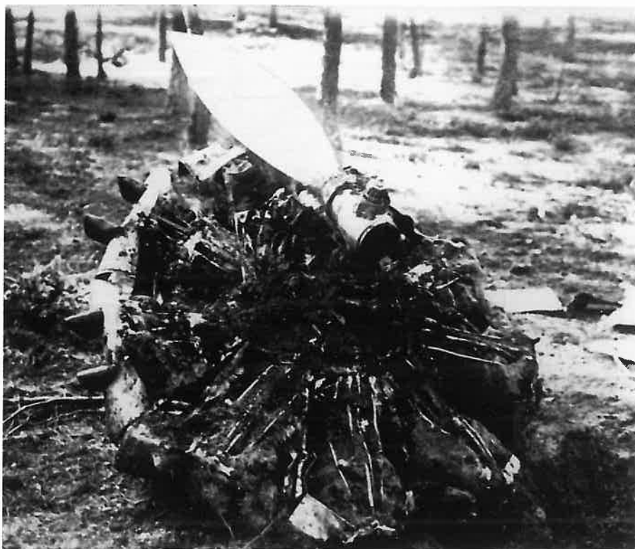
Powyżej: Silnik urwany w locie. Widoczny pierścień i rury wydechowe. Above: The engine torn off in flight. Note the ring and the exhausts.
