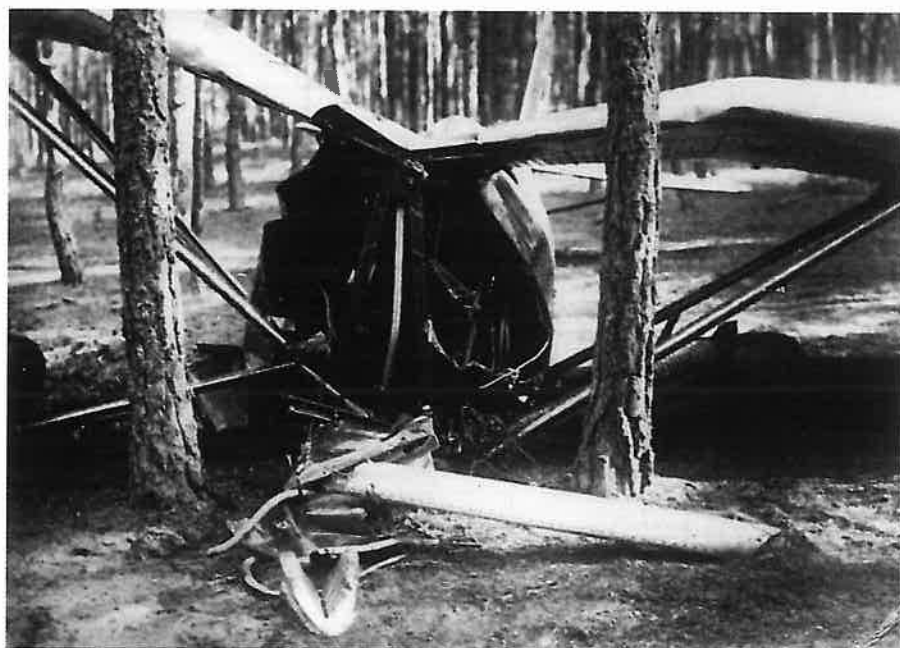
Powyżej: Silnik urwany w locie. Widoczny pierścień i rury wydechowe. Above: The engine torn off in flight. Note the ring and the exhausts.
