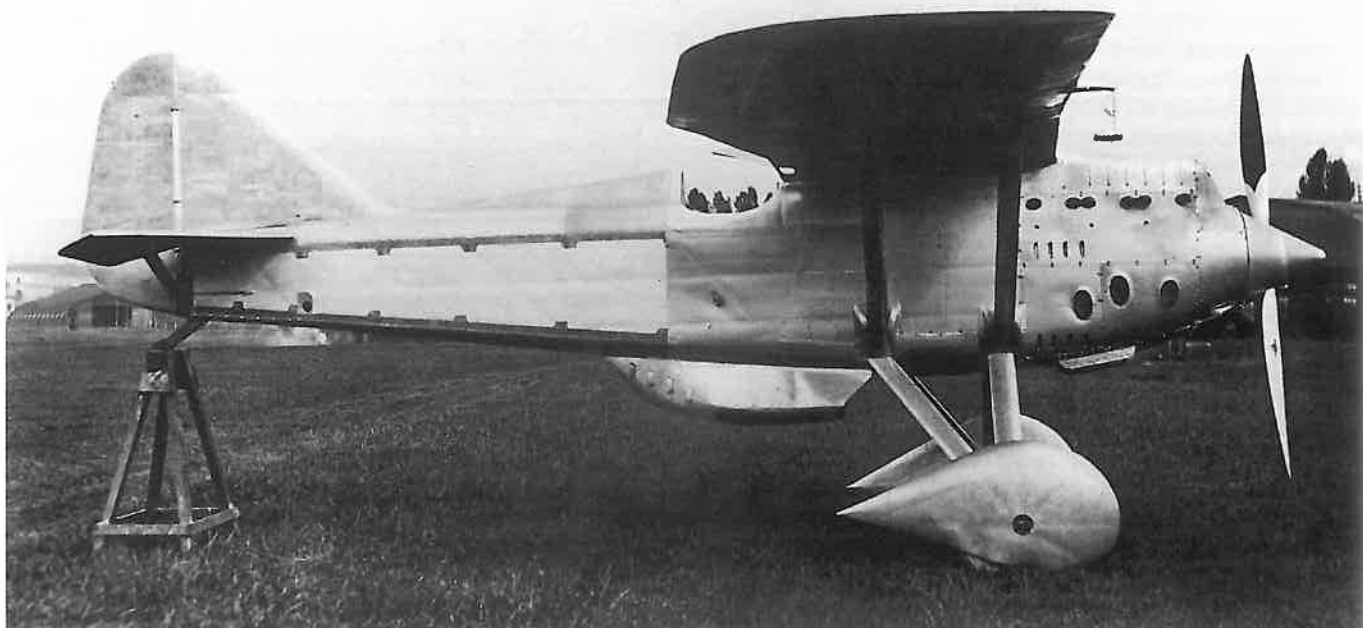
Powyżej: Niwelacja PZL P.8/I. Above: Rigging the PZL P.8/I.
