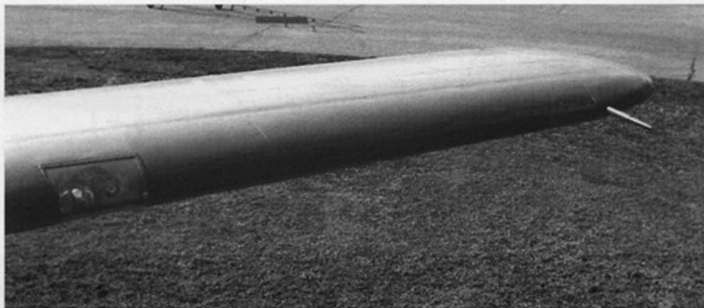
Po lewej: Końcówka lewego skrzydła samolotu Do 335 A-02 z widoczną rurką Pitota i reflektorem do lądowania.
