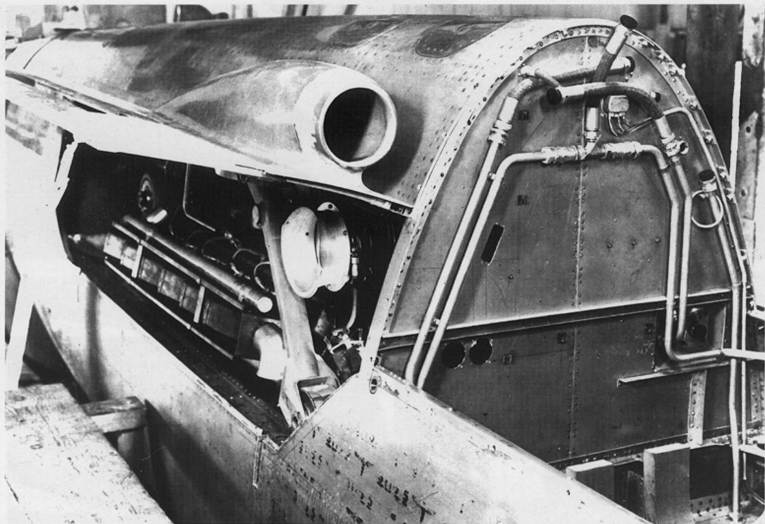
Powyżej: Otwarta prawa osłona tylnego silnika DB 603 na będącym w remoncie Do 335 A-02. Na pokrywie widoczny jest wlot powietrza do sprężarki. Na grodzi kadłuba widoczne są rurki instalacji paliwowej.
