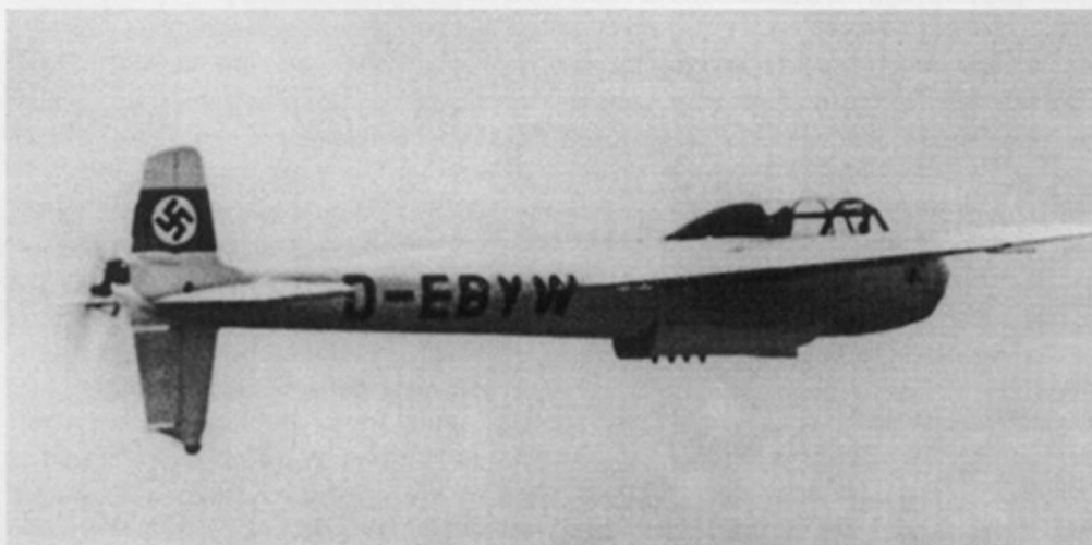
Göppingen Gö 9 w locie — doświadczalny samolot w programie konstrukcji ze śmigłem pchającym.
