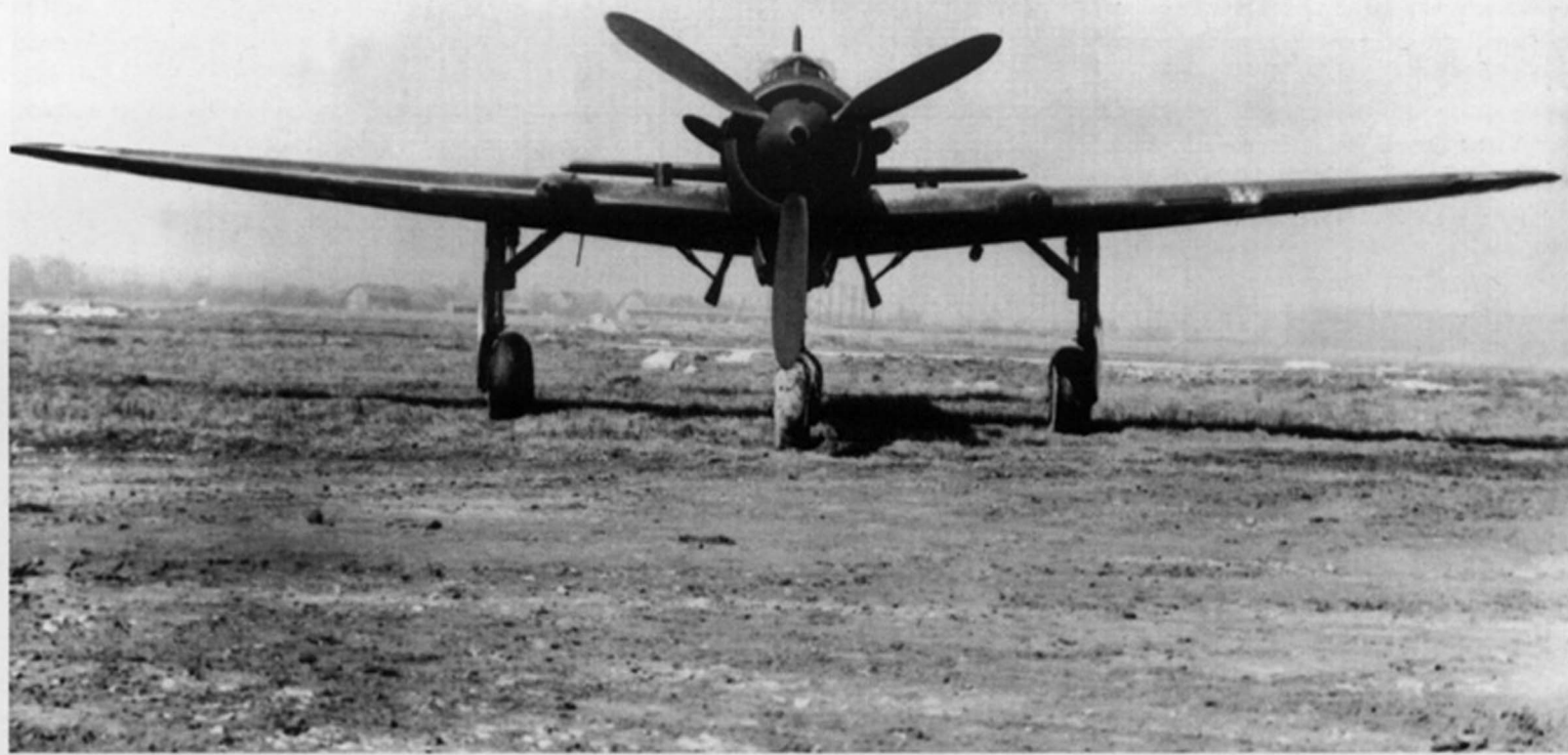
Do 335M13 w widoku z przodu. Na prawym skrzydle przy kadłubie widoczny jest zasobnik z kamerą. Na tym zdjęciu wyraźnie widać, że skrzydła mają powiększoną rozpiętość.
