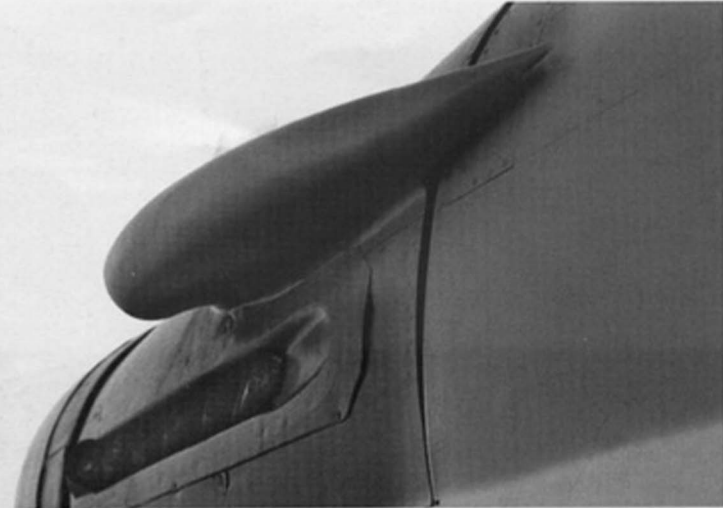
Powyżej: Wlot powietrza do sprężarki przedniego silnika samolotu Do 335 A-02.
