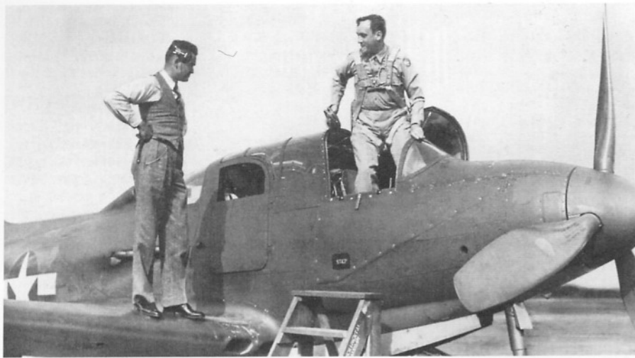
Jeden z pierwszych P-39, przebudowanych na samolot treningowy. Pilot doświadczalny wymienia uwagi z kontrolerem lotów. Zwraca uwagę zaciemniona tylna kabina.
