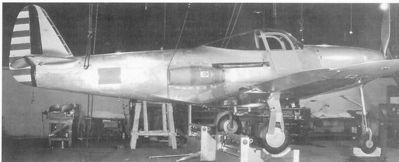
Prototyp XP-39 w pierwotnej konfiguracji podczas ważenia przed demontażem do transportu do Wright Field. Pod skrzydłem pośrodku widoczne są wyloty spalin z turbosprężarki.
