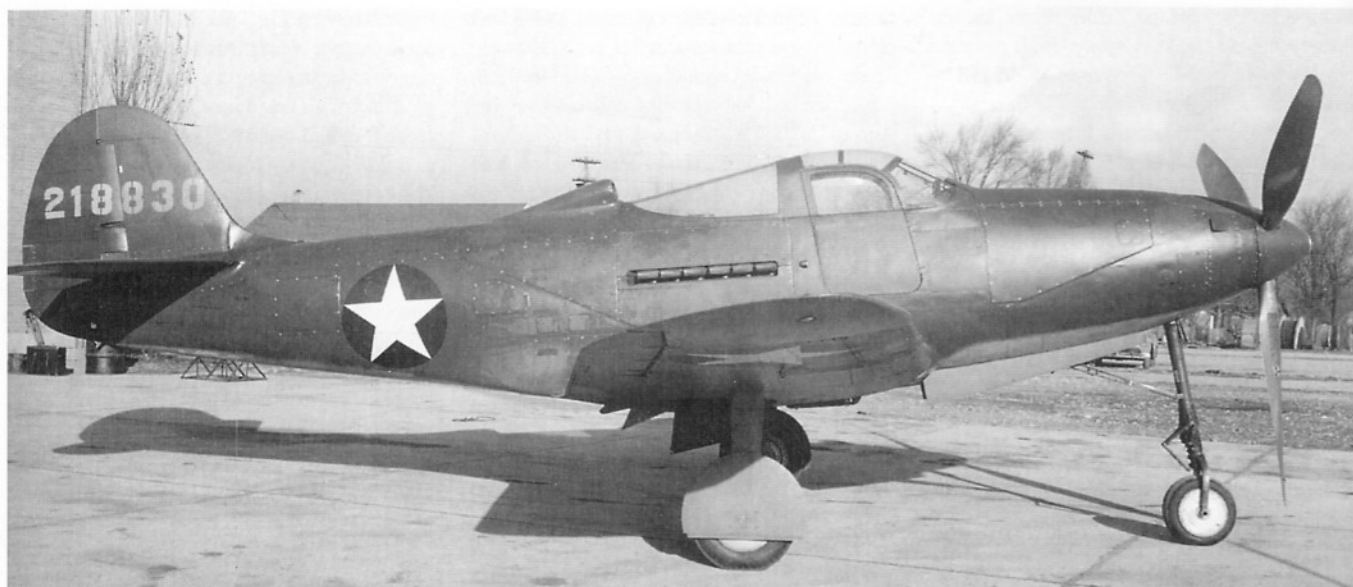
P-39N-5, używany przez Allison Division of General Motors do testowania różnych wariantów silników V-1710.
