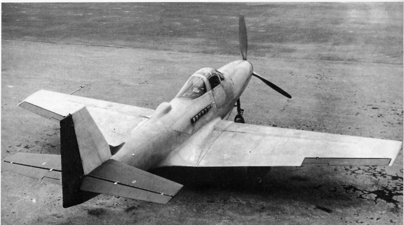
Drugi prototyp XP-39E z inną pletwą grzbietową przed statecznikiem pionowym.
