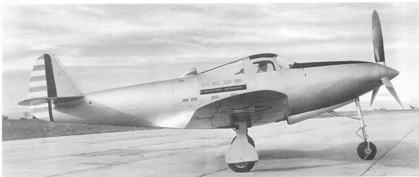
XP-39 z nową, niższą osłoną kabiny z małym chwytem powietrza do gaźnika za kabiną. W celu wyeliminowania refleksów świetlnych na tablicy przyrządów, górny panel owiewki kabiny zamalowany na czarno.
