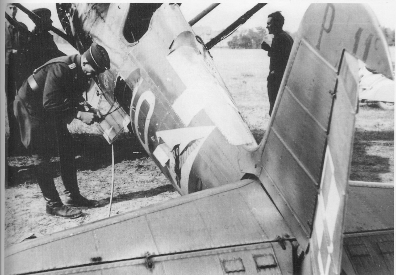
Widoczny wyremontowany kadłub. Na szczycie owiewki za kabiną zagadkowy walcowy element. Otwarte drzwiczki pomieszczenia radiostacji i apteczki (JBC)
