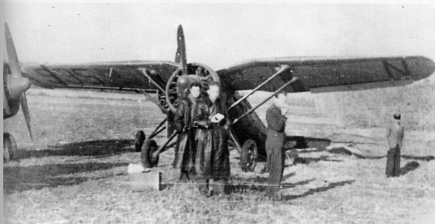
P.11c nr 935-N z zamalowanymi od spodu skrzydeł szachownicami i lewym kołem szprychowym od samolotu Breguet XIV (wziętym od wózka lotniskowego). Po 10.9.1939 - lotnisko Młynów.
