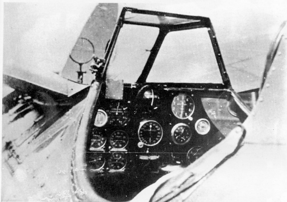
Tablica przyrządów węgierskiego P.11a ze zmienioną busolą
