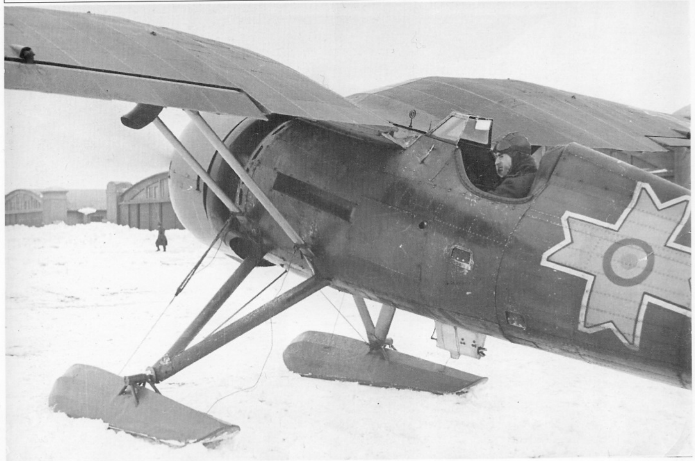
P.11F nr 122 z bliska. Pod kadłubem mocowanie zaczepu do holowania rękawa. Widoczna belka z celownikiem. (DB)
