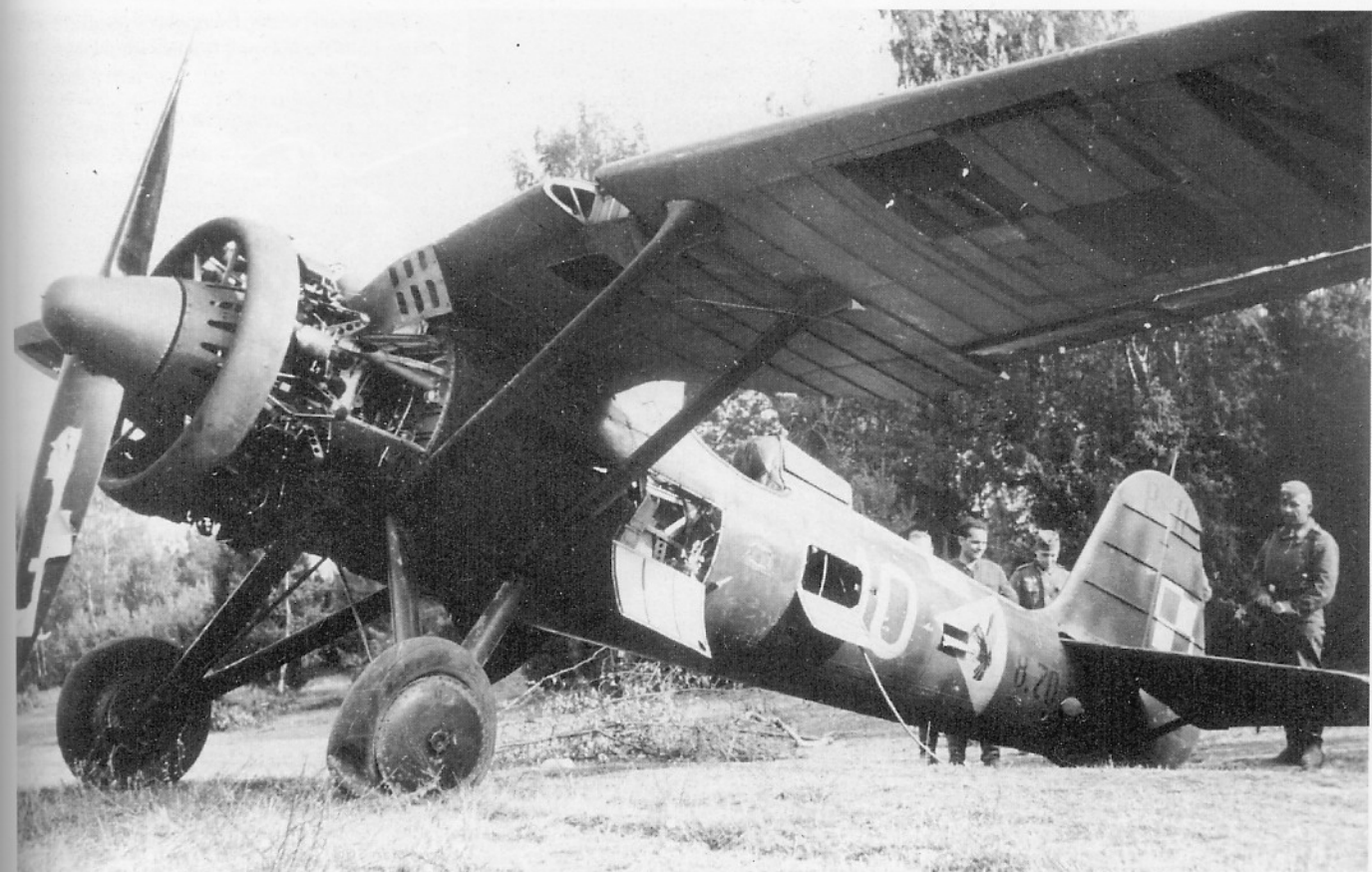
P.11c na 10 (8.70) ppor. H. Dudwała zdobyty przez Niemców. Śmigło ma już rozdarte płócienne pokrycie
