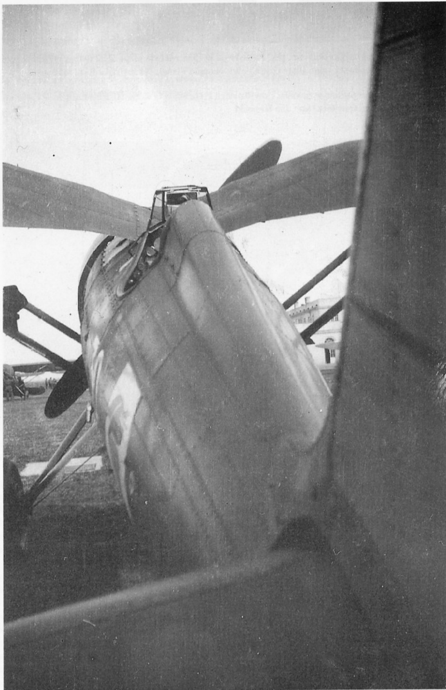
Toruński P.11c z numerem 70 na kadłubie. Z lewej strony zdjęcia widoczny fragment fotokarabinu na zastrzale. W tym ujęciu doskonale widać kształt owiewki za kabiną o spłaszczonych bokach (Mf)
