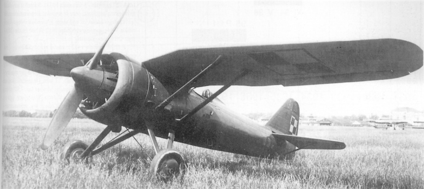
Powyżej: P.11/III 6-D po przeróbce na wzorec P-11a. Na tyle kadłuba czerwony numer 6-D. Samolot miał wąski statecznik pionowy jak P.7a i prototypy P.11 oraz osłonę silnika z kolektor- em spalin na przedniej krawędzi. Lotnisko mo- kotowskie 1933r.
