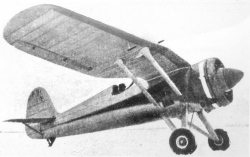
Po prawej: Czwarty prototyp P.11/IV po pomalowaniu na biało-czerwono, z oznaczeniem P.11c. Samolot ma kro- płowy kółpak śmigła i koła balonowe ze zdjętymi pokry- wami
