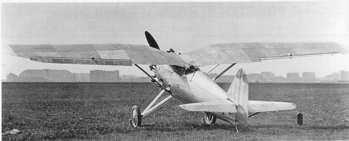
P.11/I bez pierścienia na silniku i bez owiewki za kabiną. Widoczny jednoczęściowy wiatrochron (FZL)
