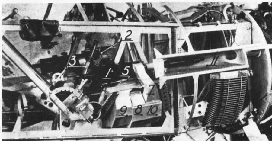
Sposób zainstalowania karabinu maszynowego w kadłubie P.11c oraz chłodnicy oleju na jego burcie (FZL)
