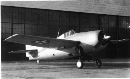
XF4F-6 (BuNo 7031) z silnikiem P&W R-1830-90 z dwubiegową lecz jednostopniową sprężarką, przebudowany z seryjnego F4F-3. Samolot był produkowany seryjnie jako F4F-3A — nie posiadał chwytu powietrza do gaźnika nad silnikiem.
