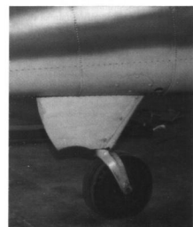
Kółko ogonowe brytyjskiego Wildcata VI z pneumatykiem dostosowanym do twardej nawierzchni startowej.
