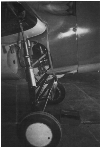
Powyżej: Podwozie samolotu Martlet I . Widoczne są szerokie rury wylotowe silnika.
