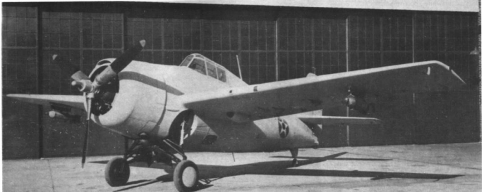
Powyżej: Wczesny F4F-4 Wildcat z bombami na dodatkowych zaczepach podskrzydłowych. Pod prawym skrzydłem widoczna bomba 50-funtowa (22,7 kg), zaś pod lewym bomba 100-funtowa (45,3 kg). Na końcówce lewego skrzydła widoczna rurka Pitota z zmienionym w tej wersji samolotu kształcie.
