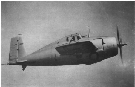
Poniżej: Przebudowany egzemplarz BuNo 0383 z prototypowym silnikiem Pratt & Whitney XR-1830-76 już jako XF4F-3 w pierwotnej konfiguracji, kwiecień 1939 roku.
