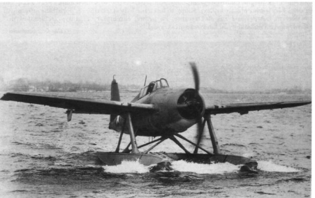
F4F-3S na próbach. Samolot nie posiada jeszcze pletwy ustateczniającej pod tylną częścią kadłuba.
