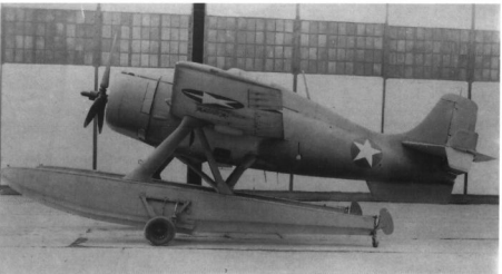
Pierwszy i jedyny egzemplarz F4F-3S (BuNo 4038), noszący nieoficjalną nazwę Wildcatfish został przebudowany z seryjnego F4F-3 w zakładach Edo Corporation. Na zdjęciu górny samolot w pierwotnej konfiguracji, na dolnym zaś z dodatkową pletwą ustateczniającą pod tylną częścią kadłuba, dodaną podczas prób.
