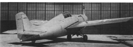
Powyżej: Pierwszy seryjny F4F-3 (BuNo 1844) z uzbrojeniem nad silnikiem.
