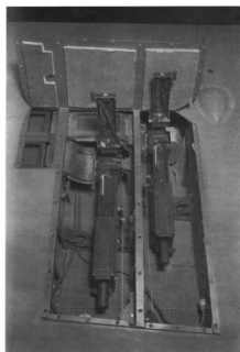
Poniżej: Te same karabiny maszynowe po wyjęciu z zamocowań. Dobrze widoczne prowadniki taśm amunicyjnych i otwory wyrzutowe łusek.
