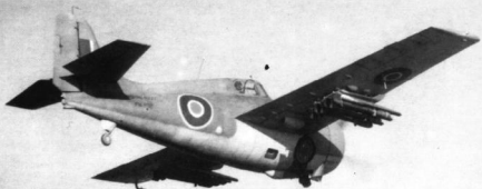
Martlet IV (FN 202) — odpowiednik amerykańskiej wersji F4F-4. Pod skrzydłami widoczne prowadnice z rakietami, będące jednym z brytyjskich wariantów uzbrojenia tego samolotu.
