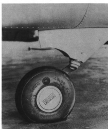
Duże pneumatyczne kółko ogonowe Wildcata Marines przystosowanego do operowania z lotnisk polowych.
