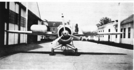
Powyżej: Próby fabryczne nadmuchiwanego awaryjnego pływaka skrzydłowego XF4F-2 w 30 minut po uruchomieniu instalacji.
