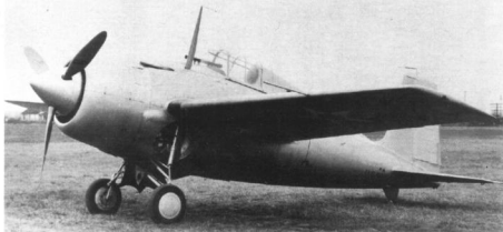
Powyżej: XF4F-3 w trakcie prób z szerokim kotłakiem śmigła w maju 1939 roku. Zwracając uwagę łopaty śmigła bez późniejszych charakterystycznych nakładek.
