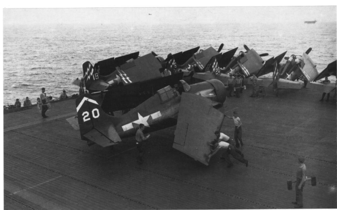
Składanie skrzydła FM-2 na pokładzie lotniskowca eskortowego USS Hogget Bay (CVE-75) 2 lipca 1945 r. samolot ten należał do grupy lotniczej (prawdopodobnie VC-98) lotniskowca USS Lunga Point (CVE-94). W tle Wildcaty z macierzystej grupy VC-99 z Hogget Bay .
