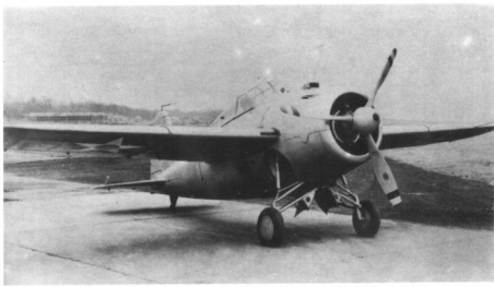
Powyżej: XF4F-2 ze zmienioną osłoną silnika, marzec 1938 roku. Samolot posiada jeszcze zaokrąglone końcówki skrzydeł i usterzenia.
