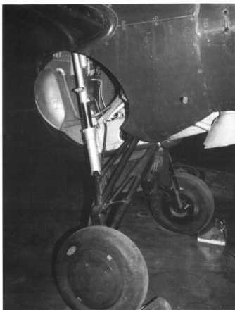
Powyżej: Podwozie samolotu Martlet I . Widoczne są szerokie rury wylotowe silnika.
