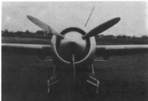
Powyżej: XF4F-3 w trakcie prób z szerokim kotłakiem śmigła w maju 1939 roku. Zwracając uwagę łopaty śmigła bez późniejszych charakterystycznych nakładek.
