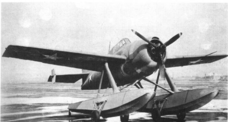
Pierwszy i jedyny egzemplarz F4F-3S (BuNo 4038), noszący nieoficjalną nazwę Wildcatfish został przebudowany z seryjnego F4F-3 w zakładach Edo Corporation. Na zdjęciu górny samolot w pierwotnej konfiguracji, na dolnym zaś z dodatkową pletwą ustateczniającą pod tylną częścią kadłuba, dodaną podczas prób.
