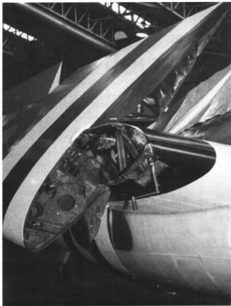
Powyżej i powyżej po prawej: szczegóły miejsca składania skrzydeł F4F-4 (Foto powyżej: M. Rusiecki, po prawej: Grumman)
