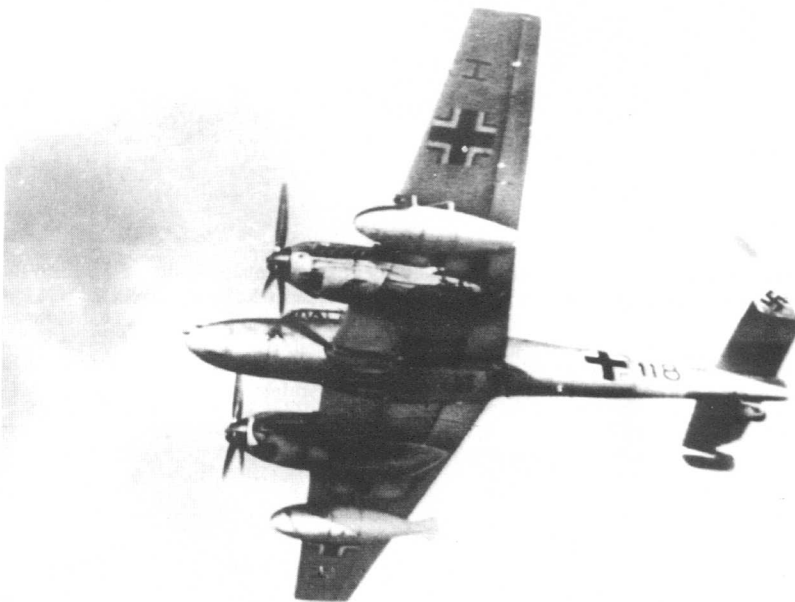
Powyżej: Messerschmitt Bf 110 D-3 ze zbiornikami dodatkowymi o pojemności 900 dm 3 , prawdopodobnie z jednostki szkolnej o czym świadczy jedynie numer na kadłubie. Na nosie i pod skrzydłami widoczne oznaczenie 8./ZG 26 do której uprzednio należał samolot.
