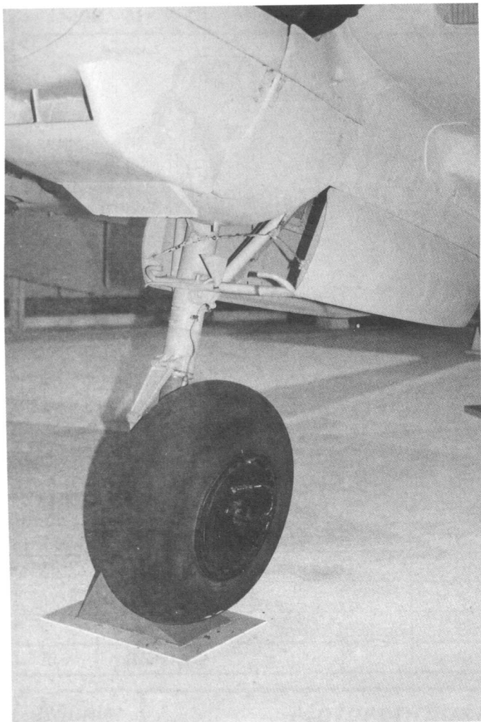
Goleń podwozia głównego i fragment osłony silnika z chłodnicą oleju Bf 100 G-4.
