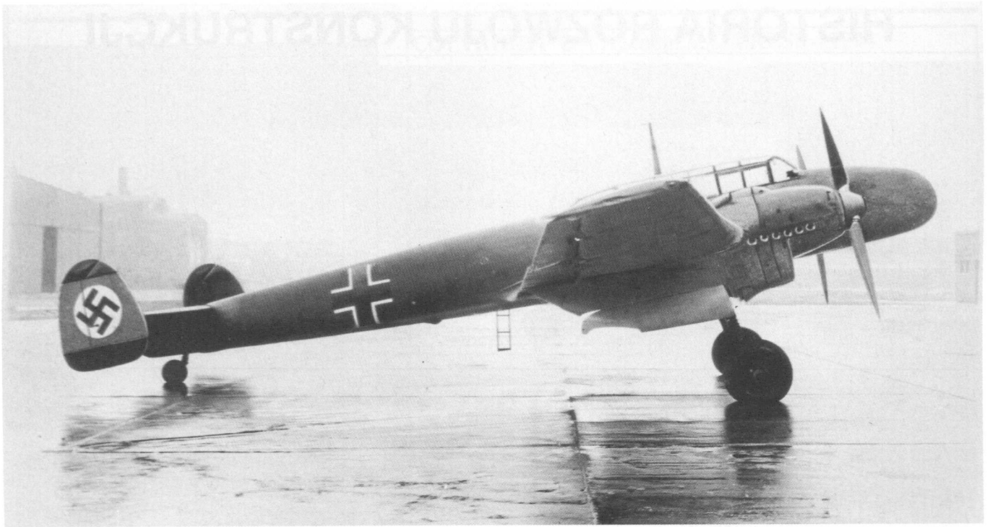
Powyżej: Messerschmitt Bf 110 A-01 z silnikiem Junkers Jumo 210 Da.
