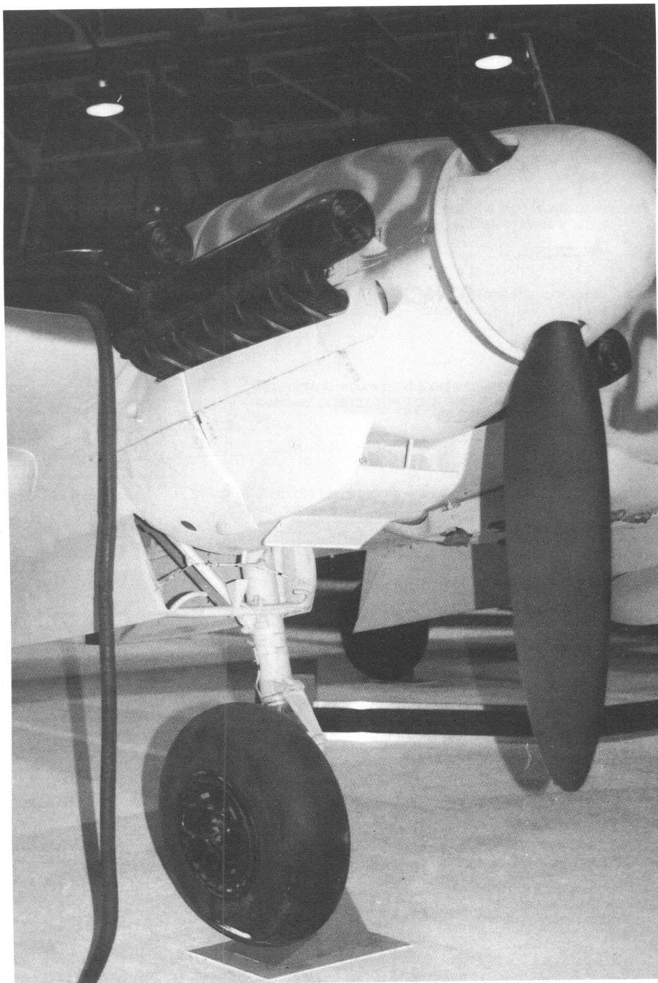
Widok na zespół silnik - śmigło - podwozie samolotu Messerschmitt Bf 110 G-4.
