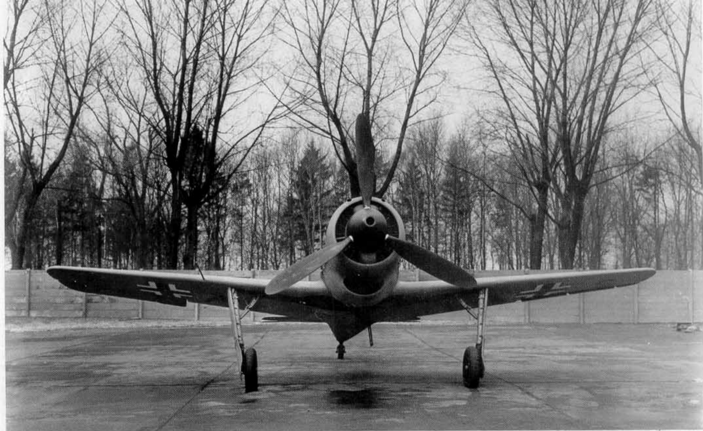
Fw 190 V13, tym razem w widoku z przodu. Warto zwrócić uwagę na otwór w kołpaku i wyloty MG 17 na osłony chłodnicy. (FW Neg.Nr. 16498)
