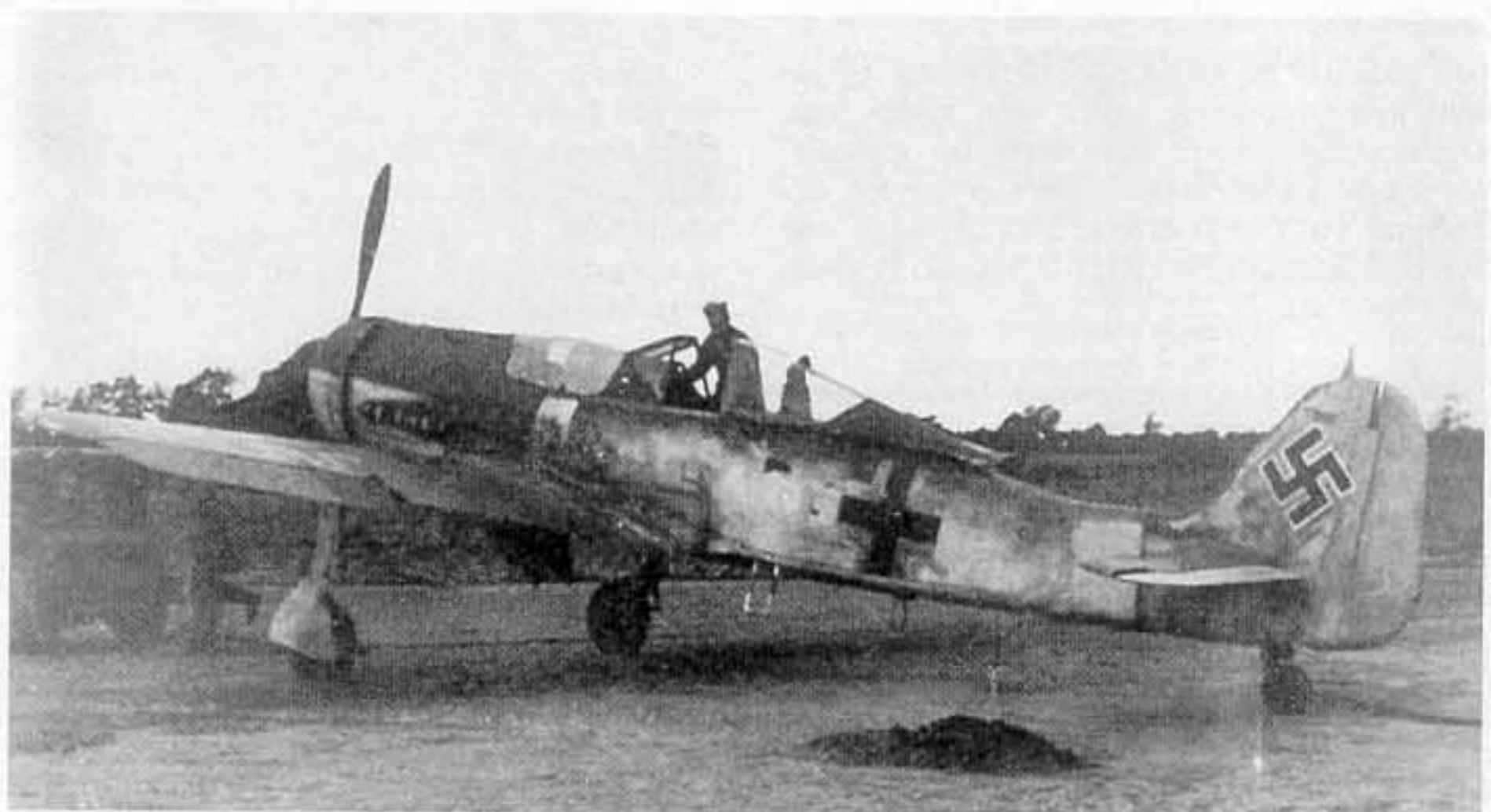
Powyżej i poniżej: Dwa ujęcia Fw 190V53, W.Nr 170003, kod radiowy DU+JC. Samolot ma już zdemonstrowane uzbrojenie w zewnętrznych częściach skrzydeł.
