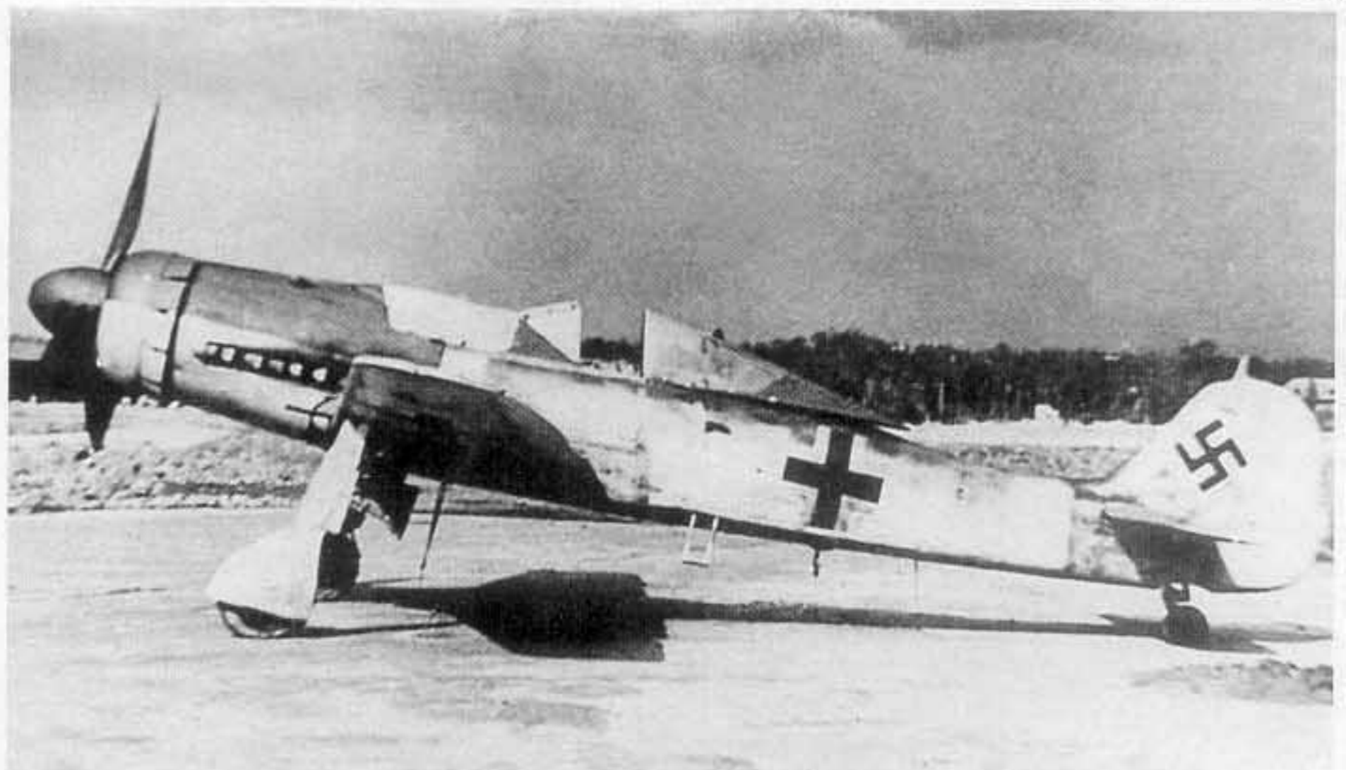
Powyżej i poniżej: Dwa ujęcia Fw 190V53, W.Nr 170003, kod radiowy DU+JC. Samolot ma już zdemonstrowane uzbrojenie w zewnętrznych częściach skrzydeł.
