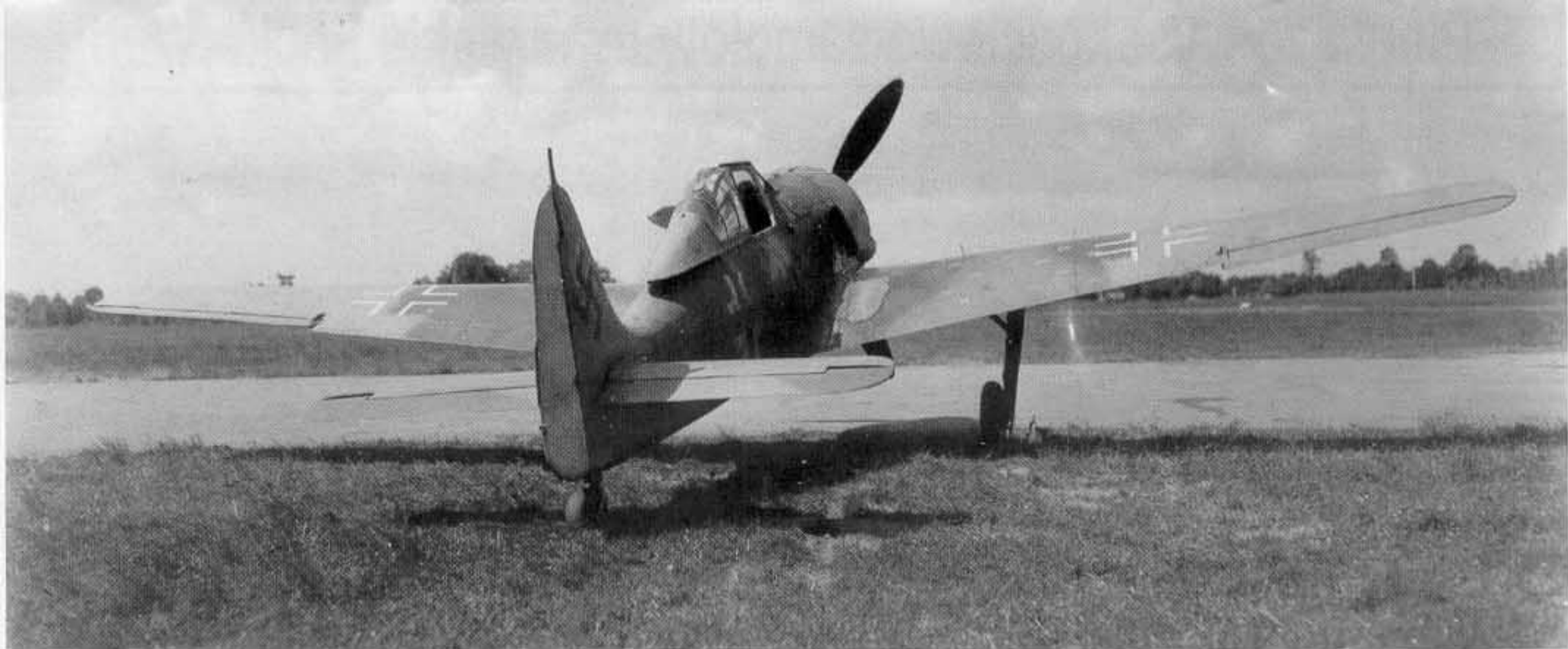
Fw 190V 27, W.Nr.0047 z silnikiem BMW 801 D-2 z instalacją GM 1. Widoczna jest owiewka kabiny ciśnieniowej z dodatkowym ożebrowaniem. Zwraca uwagę większa rozpiętość skrzydeł. (FW Neg.Nr.18567). (MVT via M. Krzyżan)
