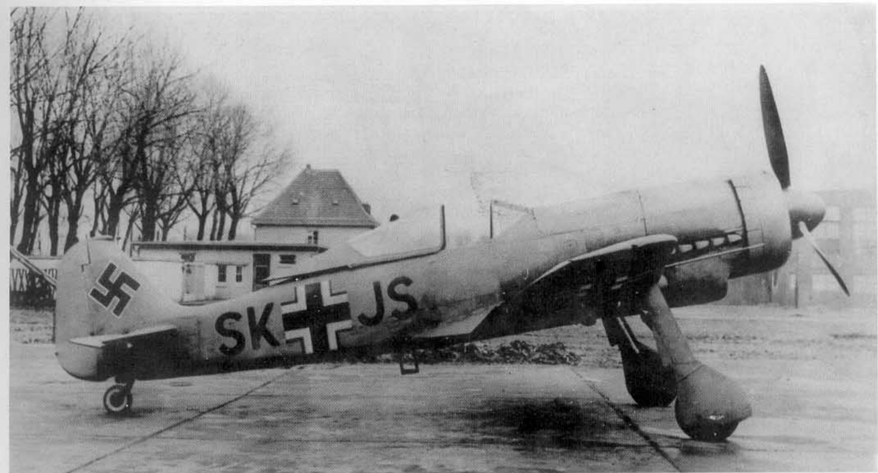
Fw 190V13, W.Nr. 0036, SK+JS w widoku z boku. Samolot powstał na bazie Fw 190 A-0 i był napędzany silnikiem DB 603 A.
