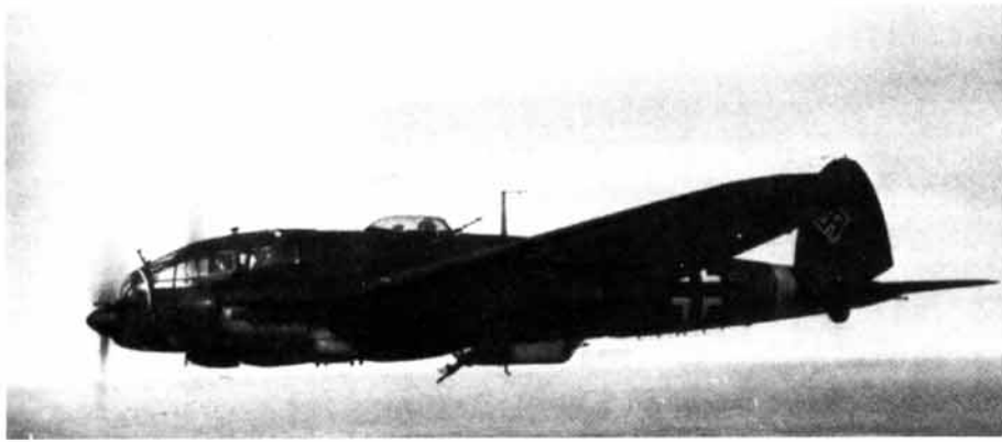
He 111 H-5 z KG 53, lato 1941 roku. W dolnej gondoli wyraźnie widoczne działko MG FF kalibru 20 mm.
