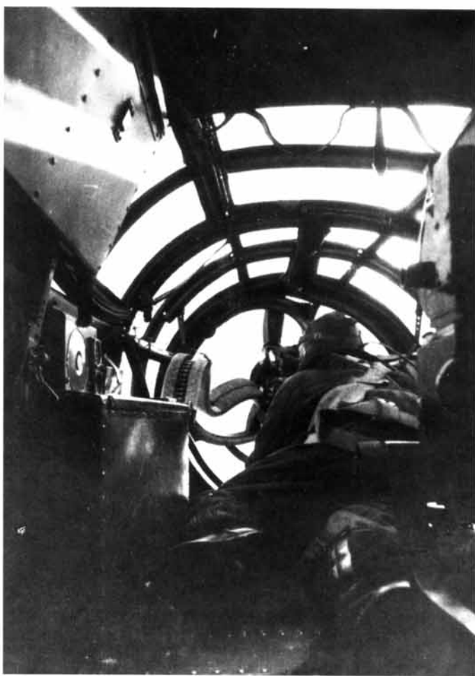
Kabina nawigatora pierwszej generacji He 111. W nosie zamontowany MG 17, który w odróżnieniu od MG 15 zasilany był taśmą amunicyjną.
