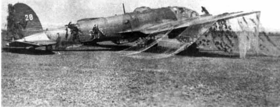
Powyżej: Jeden z rumuńskich He 111 H-3 zamaskowany siatką na ukraińskim lotnisku, jesień 1941 roku. Samolot bez uzbrojenia i anteny DF, przeznaczony prawdopodobnie do transportu VIP-ów.
