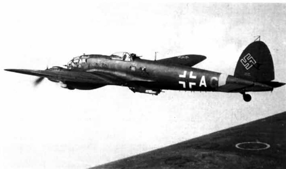
He 111 H-16. Zwraca uwagę zamknięte stanowisko górnego strzelca i nowy maszt antenowy na stateczniku pionowym, stanowiące elementy charakterystyczne późnych serii He 111 H.
