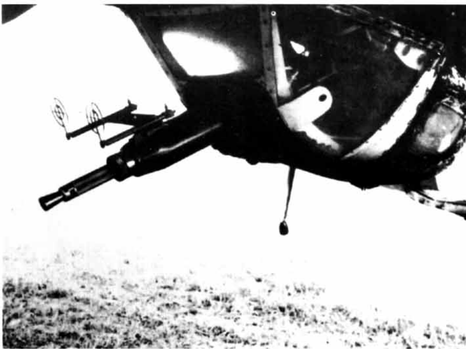
Poniżej: Przed zainstalowaniem działka w przednim stanowisku strzeleckim umieszczono je w niektórych seriach produkcyjnych w dolnej gondoli.
