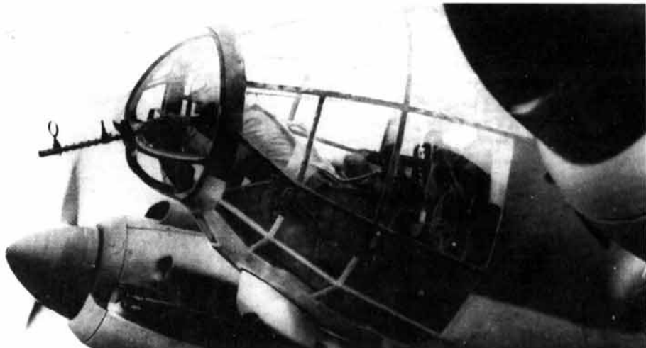
Powyżej: Zbliżenie kabiny pilota z przednim stanowiskiem strzeleckim, wyposażonym w kaem MG 17. Widoczna leżąca pozycja strzelca.
