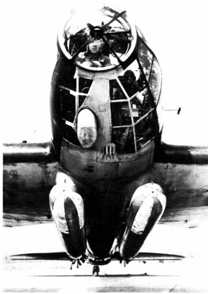
Zbliżenie He 111 H-6 z dwoma ćwiczebnymi torpedami na zewnętrznych pylonach. Model H-6 był podstawową wersją He 111.
