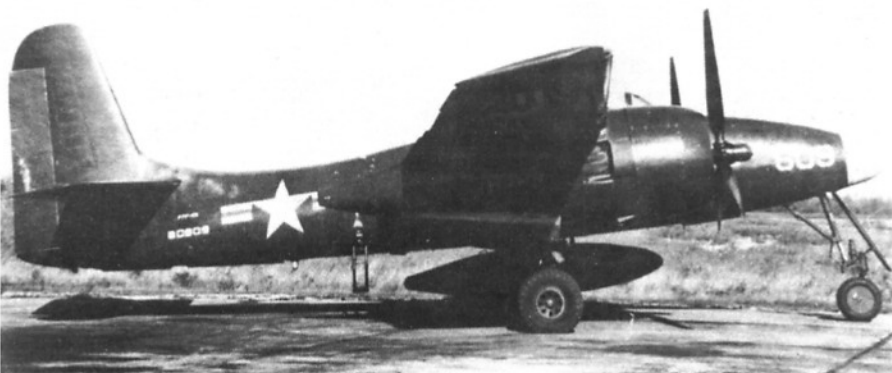
Poniżej: F7F-4N (BuNo 80609) - pierwszy seryjny egzemplarz tej wersji. Na nosie trzy ostatnie cyfry numeru seryjnego. Kopuła radaru malowana na biało.
