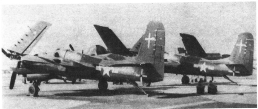
Para F7F-4N (BuNo 80610 i BuNo 80609) w NATC Patuxent River, przygotowana do prób pokładowych. Białe krzyże na kadłubie i stateczniku pionowym oraz białe prostokątki służyły do namierzania przy startach i lądowaniach. Samoloty zabezpieczone przed opadnięciem na ogon przez opuszczone haki do lądowania
