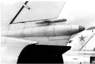
Poniżej po lewej: Ta sama część, należąca do wcześniejszej wersji Su-15 Flagon-A. (Piotr Butowski) Poniżej po prawej: Późniejsze wersje samolotu Su-15 otrzymały nad pojemnikiem ze spadochronem hamującym anteny urządzeń elektronicznych. (Piotr Butowski)
