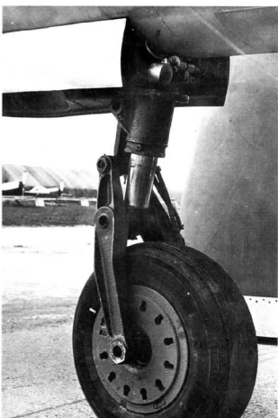
Powyżej i poniżej: Przednie podwozie w samolotach wczesnych wersji ma pojedyncze koło. (Walerij Patikow)
