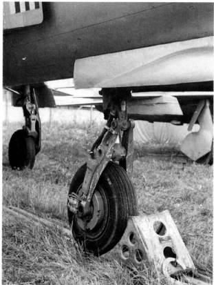
Powyżej i poniżej: Przednie podwozie w samolotach wczesnych wersji ma pojedyncze koło. (Walerij Patikow)
