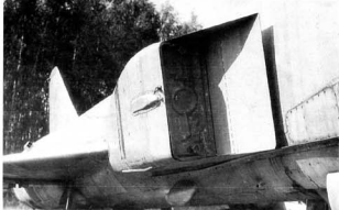
Powyżej po lewej i prawej: Wlot powietrza T-58D-2, wystający poza obrys kadłuba. (Walerij Patnikow - zdj. lewe, Piotr Butowski - zdj. prawe)
