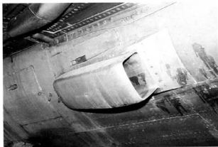
Poniżej po prawej: Dodatkowe wloty powietrza na boku kadłuba. (Piotr Butowski)
