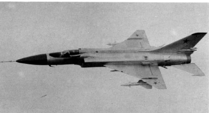
Su-15TM Flagon-F w locie bojowym. Zwracając uwagę wychylone hamulce aerodynamiczne w tylnej części kadłuba. (Szwedzkie Siły Powietrzne)
