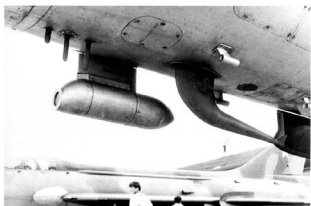
Poniżej po prawej: Niewielka gondola z fotokarabinem, przed nią trójpalczasta antena urządzenia „swój-obcy” SRZO-2 IFF, a z prawej antena aparatury Łazur. (Piotr Butowski)
