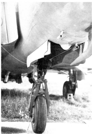
Powyżej i poniżej: Przednie podwozie w samolotach wczesnych wersji ma pojedyncze koło. (Walerij Patikow)
