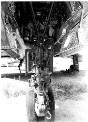
Powyżej po lewej i prawej: Przednie podwozie w samolotach Su-15T i Su-15TM posiada kółka zdwojone. (Walerij Pańkow)
