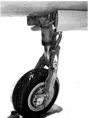
Powyżej i poniżej: Przednie podwozie w samolotach wczesnych wersji ma pojedyncze koło. (Walerij Patikow)
