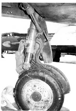
Powyżej i poniżej: Detale goleni i wneki podwozia głównego samolotu Su-15 Flagon-A w widoku z dołu. (Piotr Bułowski)
