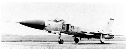
Su-15TM Flagon-F z ostrołukowym kształtem osłony radaru. (Archiwum)
