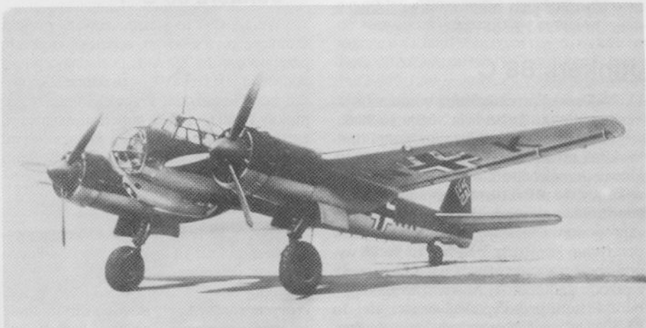
Poniżej Ju 88 A-14 - uzbrojony w działko MG FF w gondoli podkadłubowej. Wersja fabryczna, różniąca się od przebudowanych seryjnych Ju 88 A-4 wyrzutnikiem łusek z działka w miejscu okienka w gondoli podkadłubowej.
