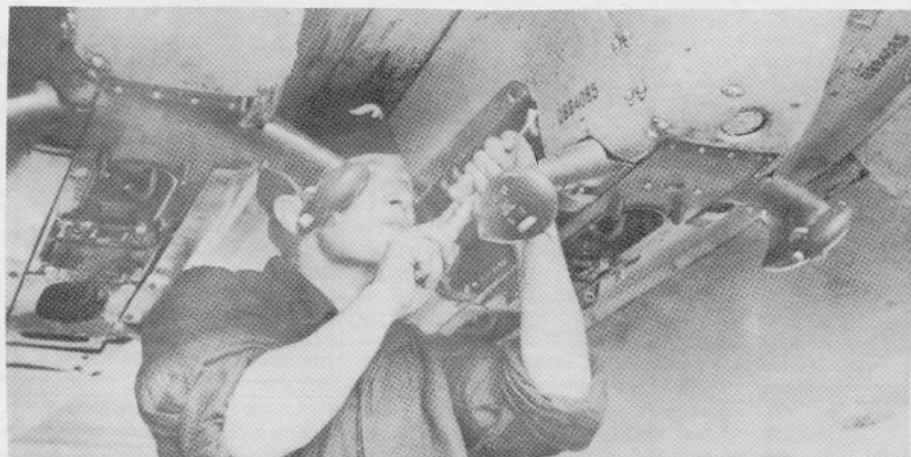
Powyżej: Grzbietowe stanowisko Ju 88 A-4. Poniżej: Podskrzydłowe wyrzutniki bombowe ETC 500.
