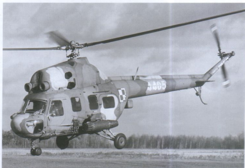
Powyżej: W pierwszej połowie lat siedemdziesiątych do służby wprowadzono uzbrojone wersje Mi-2URN z wyrzutniami rakiet niekierowanych. (zdj. M. Rusiecki) Poniżej: W próbach była też wersja Mi-2US wyłącznie z uzbrojeniem strzelckim, ale ostatecznie nie znalazła ona szerszego zastosowania. (arch. M. Rusiecki)
