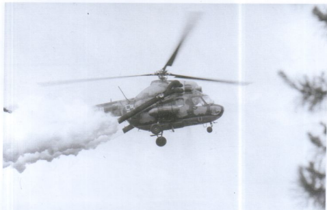
Powyżej: Wśród specjalistycznych wersji śmigłowca Mi-2 była m.in. odmiana „Hekla” z systemem WDW-80 do stawiania zastłon dymnych. (zdj. WAF)
