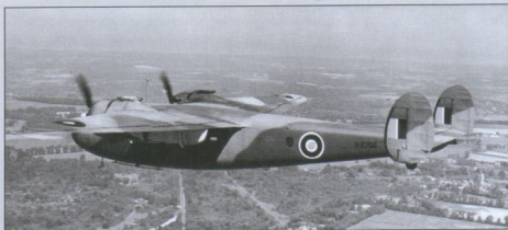
Powyżej: Flamingo R2766 w locie. Maszyna ta dotrwała w służbie do 1945 r. Zwraca uwagę dodatkowe okno w kadłubie, niewidoczne na egzemplarzu R2765.
