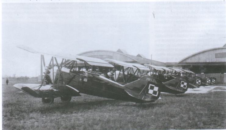
Poniżej: Gotowe samoloty seryjne PWS-5t2 na lotnisku w Białej Podlaskiej. Zwraca uwagę brak łożeń na dolnych płatach i powiększone oszklwienie kabiny obserwatora. (arch. A. Morgala)
