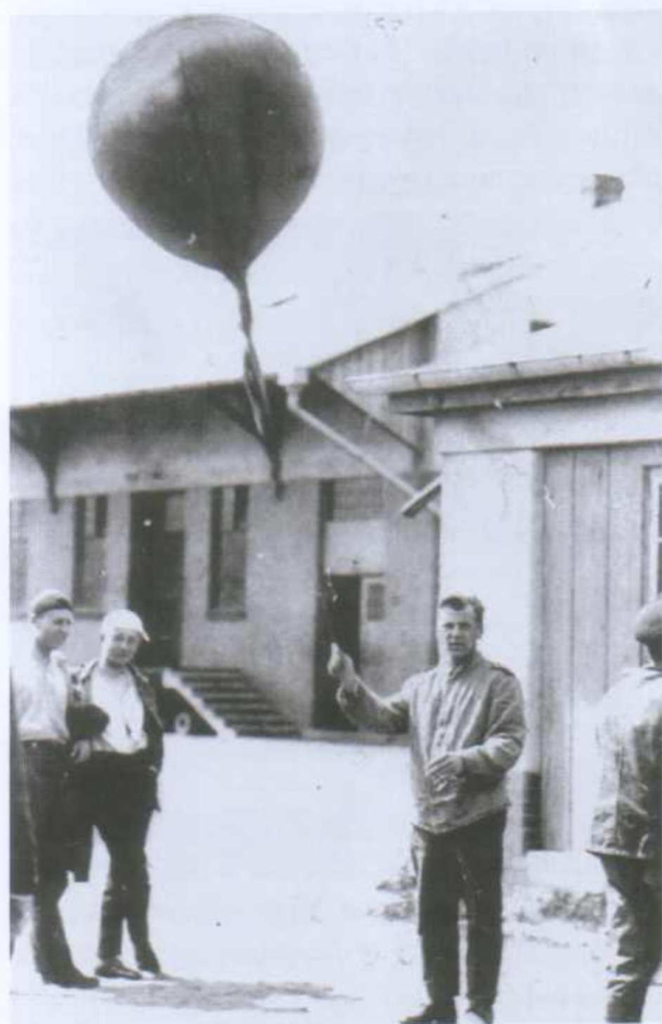
Powyżej: Balon sonda produkcji francuskiej, sklepany z wielu brytów, przed startem spod hali sterowcowej w Toruniu. (arch. A. Morgała)
