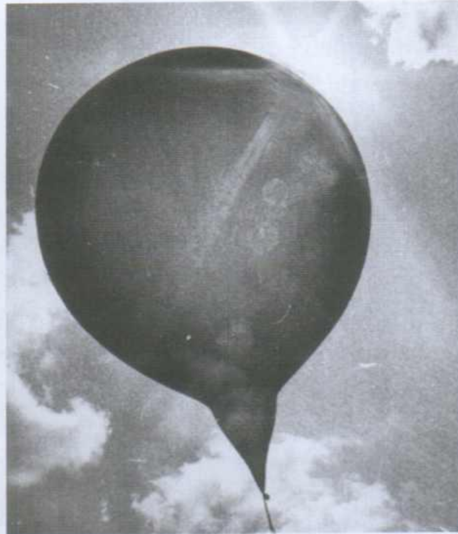
Poniżej z prawej: Wyprodukowany w Polsce jako jednolita całość balon radiosonda mający powłokę o średnicy 3,0 do 14,0 metrów. (arch. A. Morgała)
