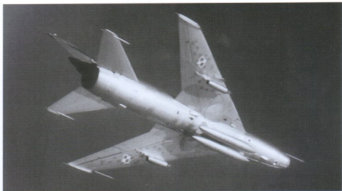
Powyżej: Su-7BKL uzbrojony w wyrzutnie UB-16-57 dla niekierowanych rakiet S-5. (arch. W. Hołys) Poniżej: Obsługa techniczna samolotów Su-7 przed lotami. Widać różne sposoby otwierania kabin w dwóch różnych wersjach. Oba samoloty zostały złomowane w bazie w Mierzęcicach w latach 90-tych. (arch. W. Hołys)
