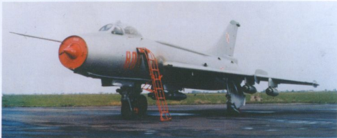
Poniżej: Su-7BKL uzbrojony w wyrzutnie UB-16-57 na niekierowane pociski S-5. (zdj. W. Hołys)
