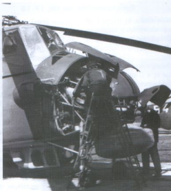
Powyżej: Obsługa zespołu napędowego śmigłowca Mi-4ME w Darłównu.
