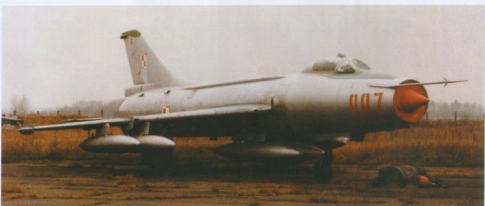
Powyżej: Su-7BKL „807” sfotografowany w Mierzęcicach w 1993 r. w nietypowej konfiguracji z sześcioma pdwieszonymi zbiornikami paliwa. Na tej maszynie testowano opony polskiej produkcji Stomil-Dębica dla Su-7 i Su-22. (zdj. G. Skowronski)
