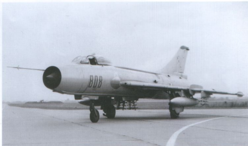
Powyżej: Su-7BKL „808”. Widoczne są belki APU-IGU, na których można było podwieszać po 7 rakiet S-3K. (zdj. W. Hołysz)
