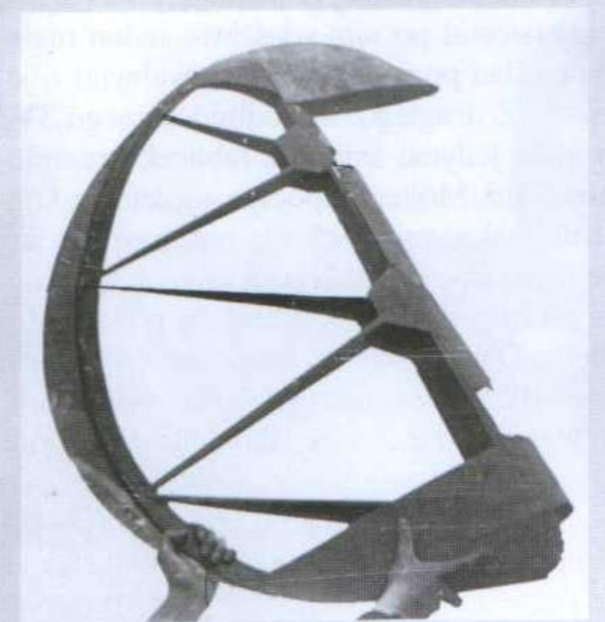
Powyżej: Ster kierunku seryjnego 3V11 wykonany z drewna. (zdj. A. Morgala) Obok: Nie oszklone osłony kabiny samo- lotu Me-410. (zdj. A. Morgala)
