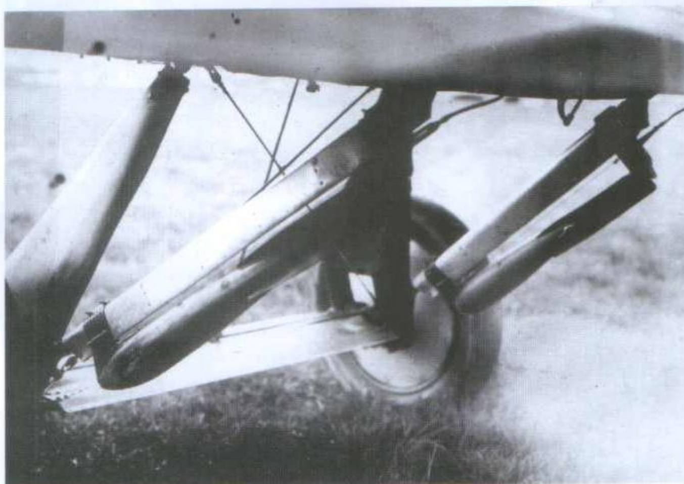
Poniżej: Wyrzutniki podgoleniowe sierżanta Pokrzywki z bombami (z lewej) i bez nich (z prawej).
