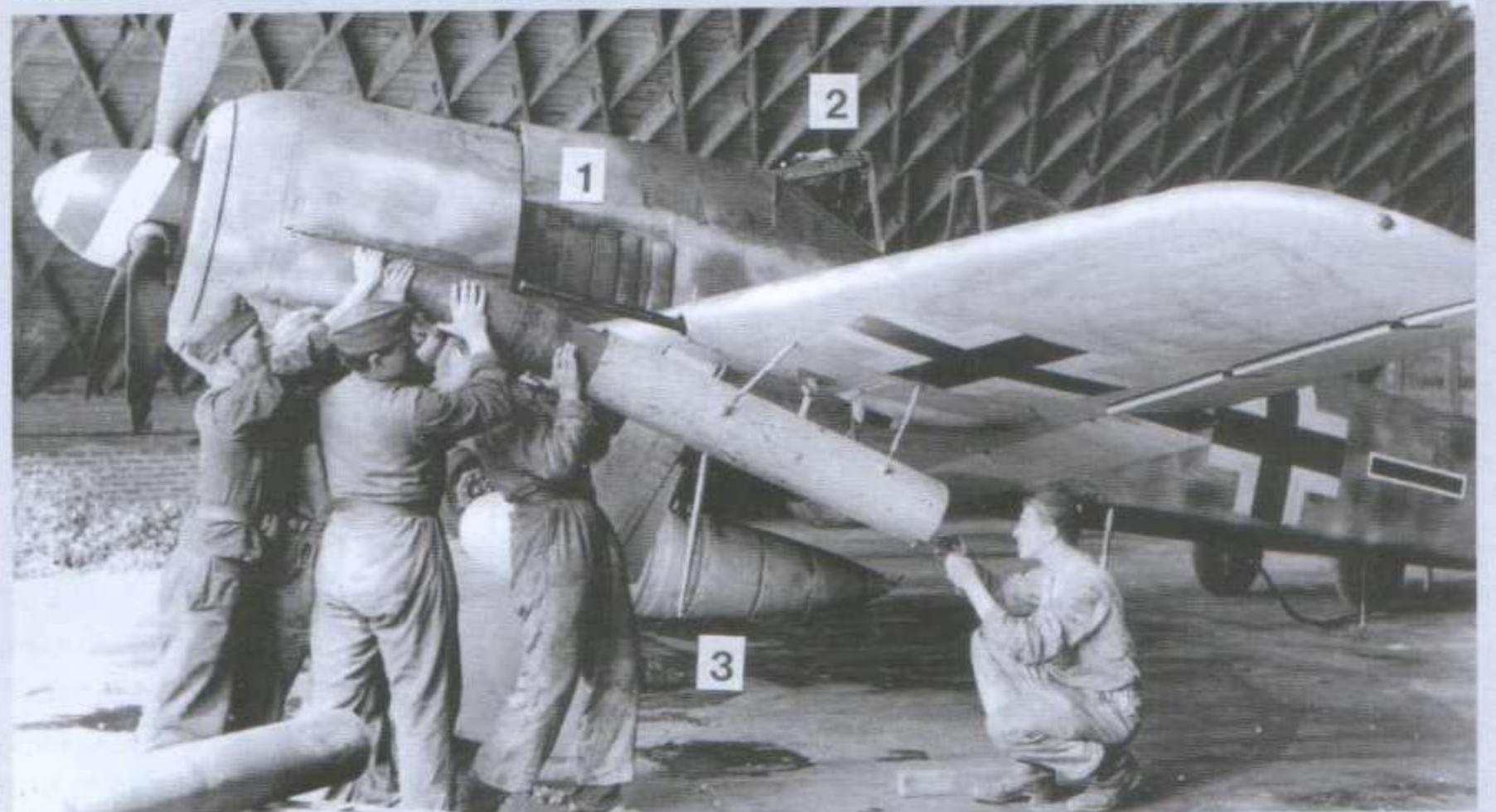
Powyżej: Elementy konstrukcji myśliwca Fw-190: 1. Klapy chłodzenia powietrznego silni-ka, 2. Wiatrochron z szybą pancerną, 3. Podwieszany zbiornik paliwa. (arch. A. Morgala)
