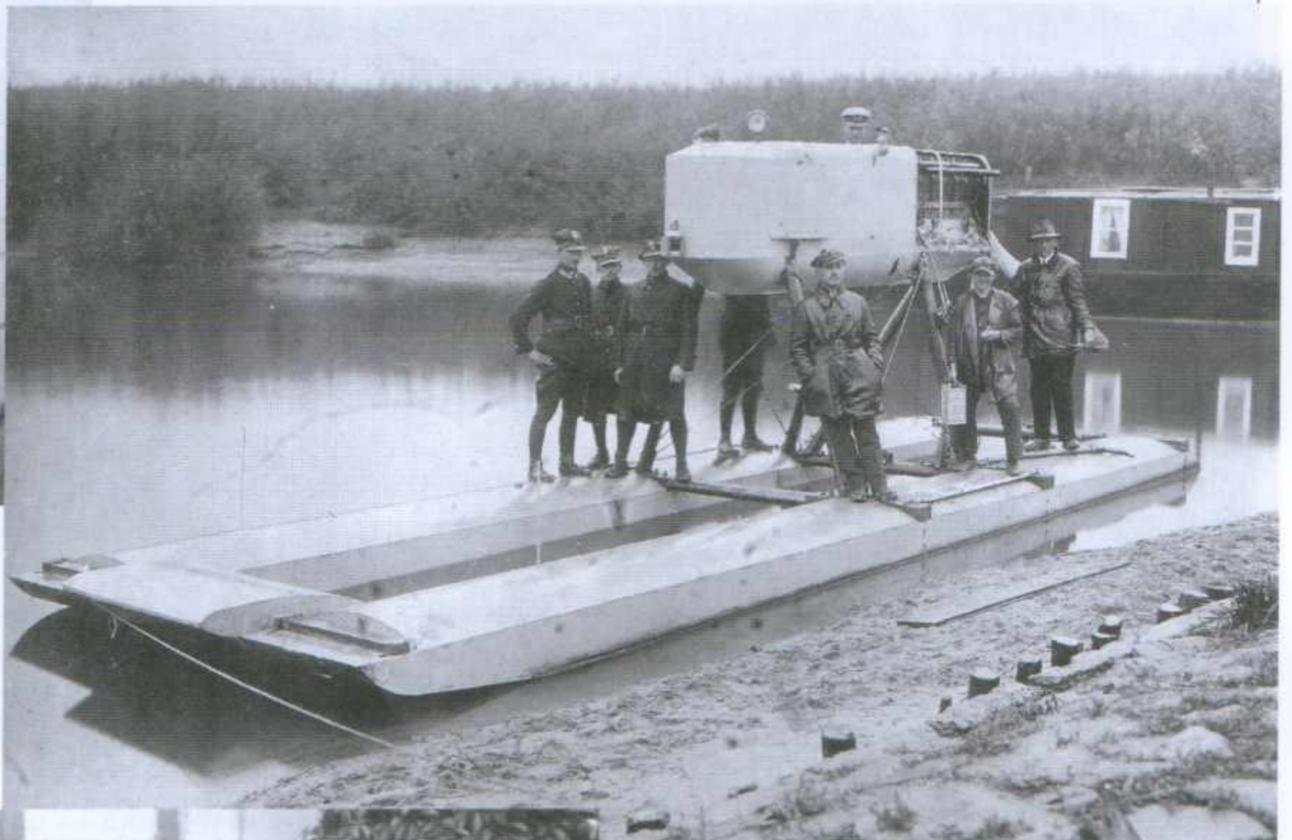
Powyżej: Próby ślizgacza na rzece Pinie. W środku stoi porucznik Stankiewicz. Ślizgacz nieznannej produkcji w układzie kataramarana z gondolą załogi na wspornikach i z napędem lotniczym. W 1925 roku zakupiono za granicą kilka egzemplarzy takich maszyn. Pełniły one służbę w Plutonie Lotniczym Flotylli Rzecznej w Pińsku.
