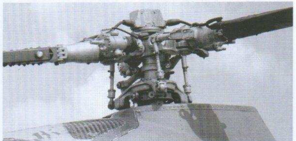
Powyżej: Pchające śmigło ogonowe z metalowymi łopatkami o resursie 1500 godzin. Poniżej: Trójłopatowy wirnik nośny z piastą przegubową i regulowanymi cięgłami połączonymi z tarczą sterującą.
