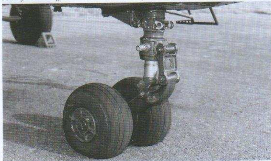
Powyżej: Główna goleń podwozia z kołem hamowanym KT96. Poniżej: Przednia goleń z kołami niehamowanymi K-350.
