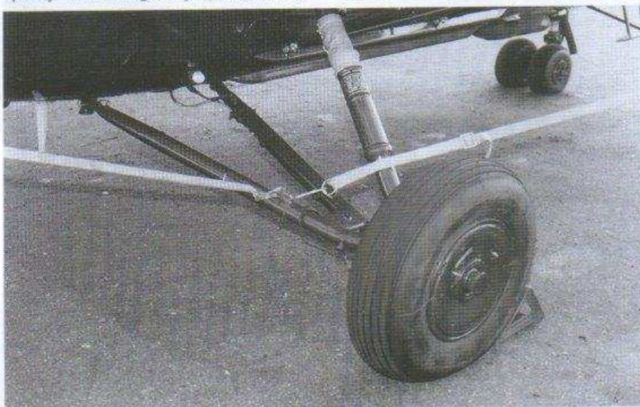
Powyżej: Główna goleń podwozia z kołem hamowanym KT96. Poniżej: Przednia goleń z kołami niehamowanymi K-350.
