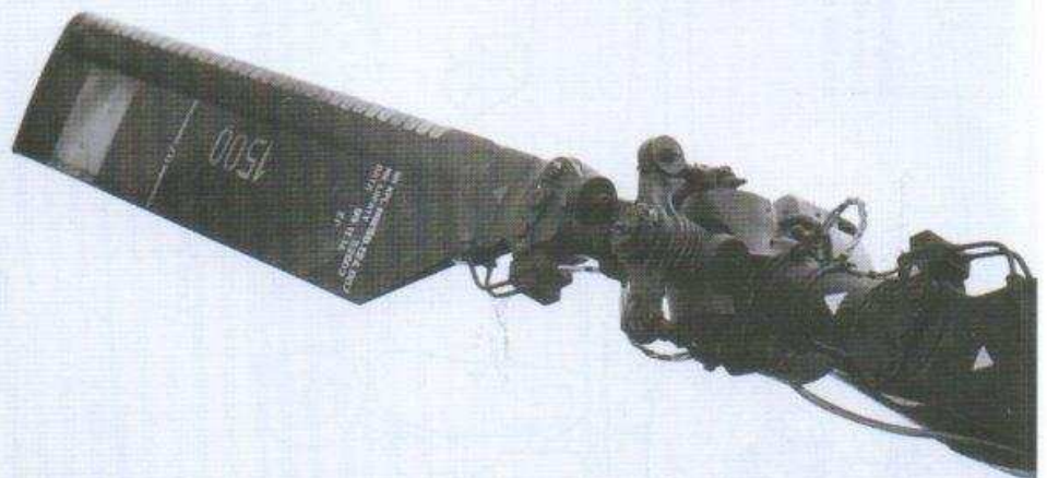
Powyżej: Pchające śmigło ogonowe z metalowymi łopatkami o resursie 1500 godzin. Poniżej: Trójłopatowy wirnik nośny z piastą przegubową i regulowanymi cięgłami połączonymi z tarczą sterującą.
