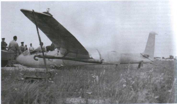
Powyżej: „Bocian Puls” podczas naziemnych prób działania zespołu napędowego. (arch. ILOT) Poniżej: „Bocian Puls” w locie w rejonie Gołclawia. (arch. ILOT)
