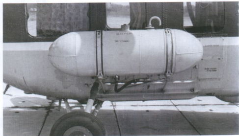
Powyżej: Zbiornik dodatkowy starego typu na Mi-2RM nr 2947, sfotografowanym w Darłowie w 1988 r. Poniżej: Reflektor-szerpacz na prawej burcie śmigłowca ratowniczego Mi-2RL nr 4512.
