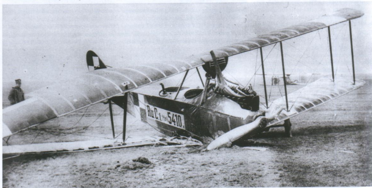
Poniżej: Szkolny Rumpler C.I (Mark) 5410/17 z silnikiem Mercedes D.III uszkodzony na Ławicy w 1919 r. Dobrze widoczny układ plam kamuflażu (3 lub 4 kolory) na kadłubie. (arch. W. Sankowski)
