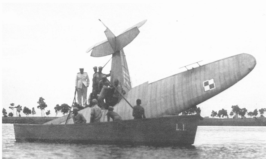
Powyżej: Wyciągnięty z morza R-XIII ter/hydro nr 711 uszkodzony w trakcie wodowania zakończonego urwaniem pływaków w 1936 r. (arch. M. Konarski).
