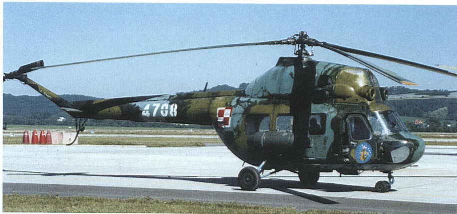
Powyżej: Mi-2 nr 4708 z 13. PLT w maju 1999 r. Widoczne ubytki farby i miejscowe uzupełnienia kamuflażu w postaci lat. Na drzwiach godło jednostki. (zdj. A. Gołąbek)
