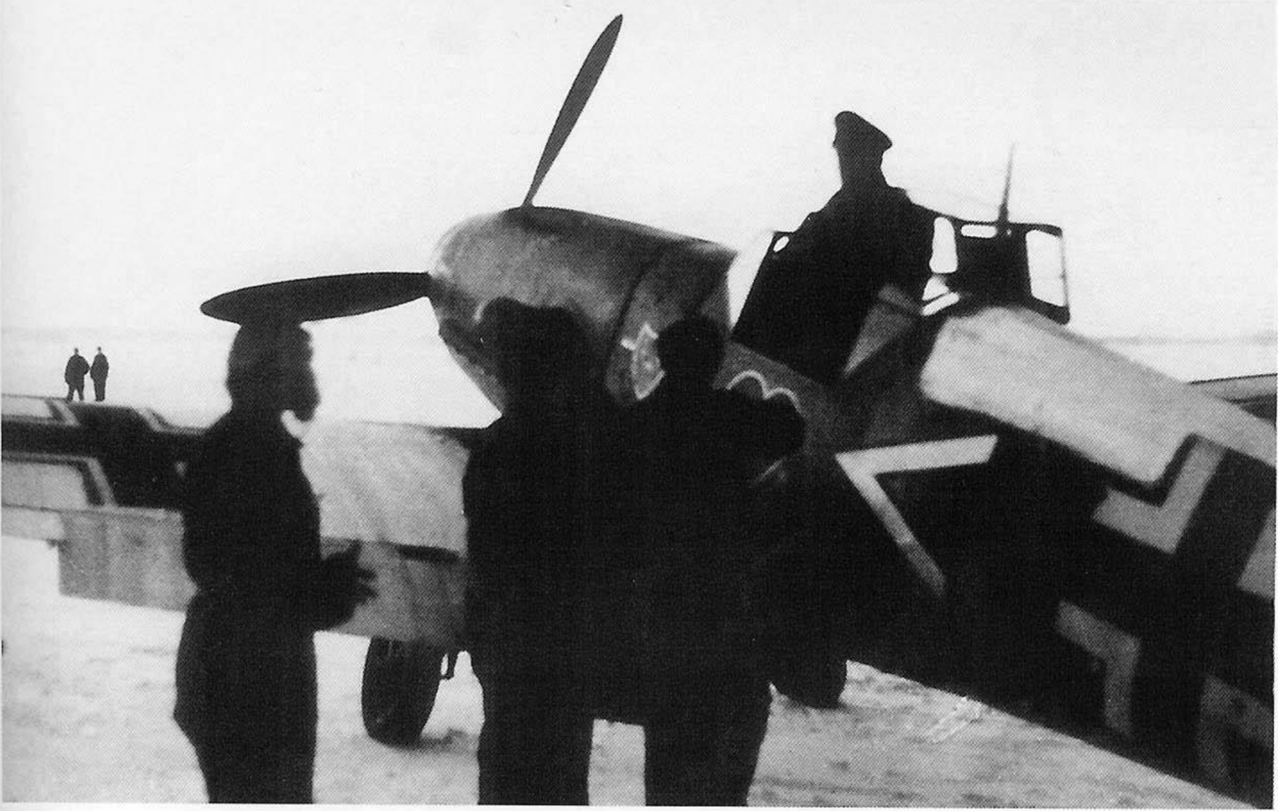
Me 109F z JG 54 sfotografowany zapewne zimą 1942/43, kiedy to w jednostce nanoszono bardzo specyficzne formy zimowego kamuflażu w postaci białych powierzchni zakrywających tylko górne powierzchnie płatowca (skrzydła, stateczniki i grzbiet kadłuba, ale już bez maski silnika).
