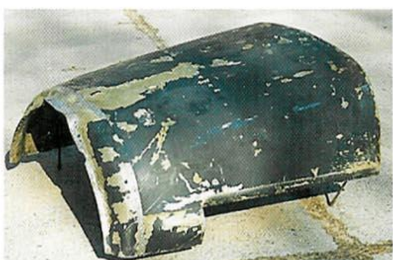
▲ Osłona dolnej części okapotowania silnika. Widoczne są wycięcie dla kolektorów spalin i miejsce łączenia z osłoną czołowej chłodnicy oleju. Warto zwrócić uwagę, że w górnej części fragment jest prosty, a tylko po bokach osłona jest obła. ▼
