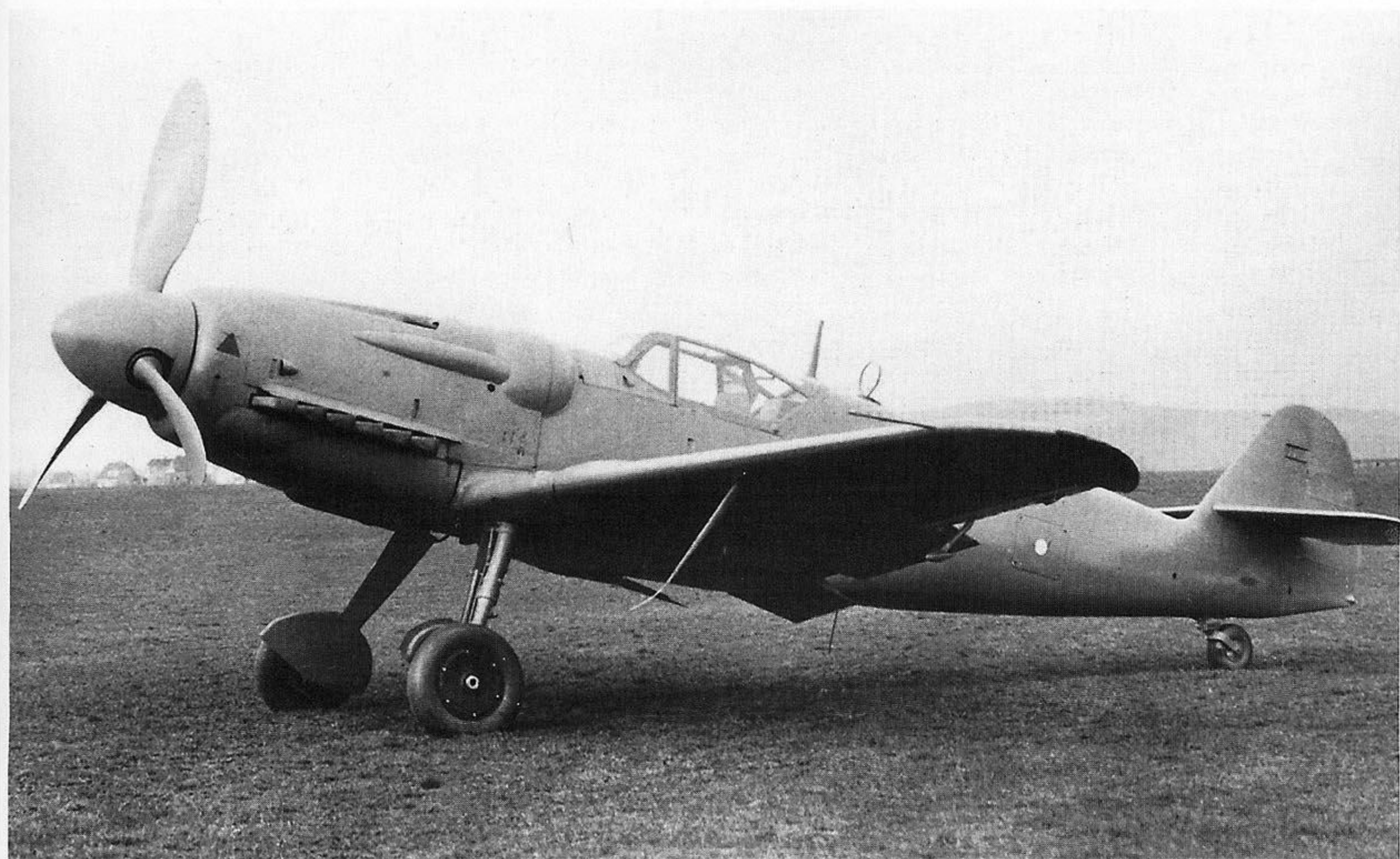
Dwa ujęcia pierwszego S-199, który pełnił rolę prototypu, jeszcze z niemieckim typem osłony kabiny, zwanym „Erla-haube“. Poza silnikiem, S-199 wizualnie niczym nie różnił się od S-99 vel Me 109 G-10.
