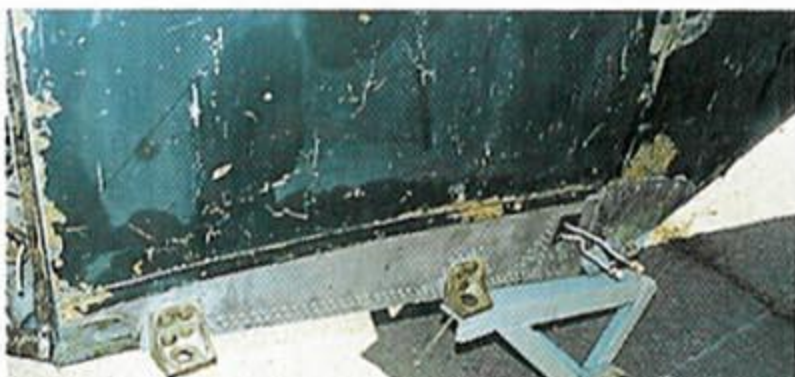
▲ Miejsce łączenia lewego skrzydła. Widoczne są dwa węzły mocowania i podłączenie instalacji w tyle.
