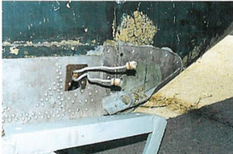
▲ Miejsce łączenia lewego skrzydła. Widoczne są dwa węzły mocowania i podłączenie instalacji w tyle.
