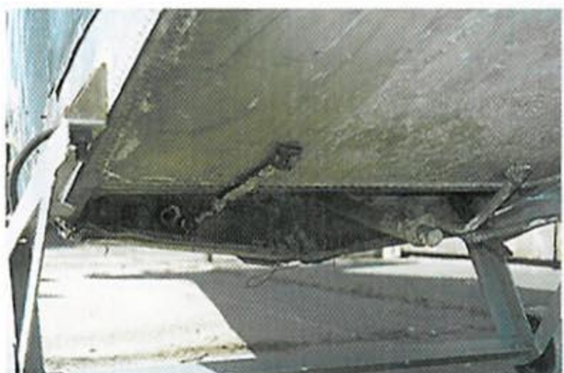
▲ Podłączenia do instalacji skrzydłowych, głównie instalacji chłodzenia cieczy
