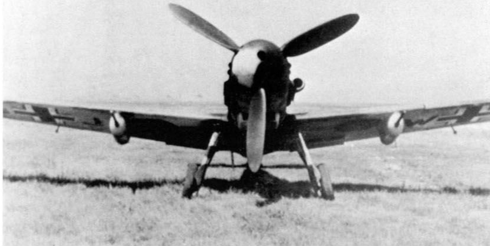
Me 109 G-2/R6 na przyfabrycznym lotnisku WNF, lato 1942 roku. W gondolach pod skrzydłami „Gustawów“ montowano działka MG 151/20, w odróżnieniu od modyfikacji wersji F-4, na których instalowano MG 151/15.
