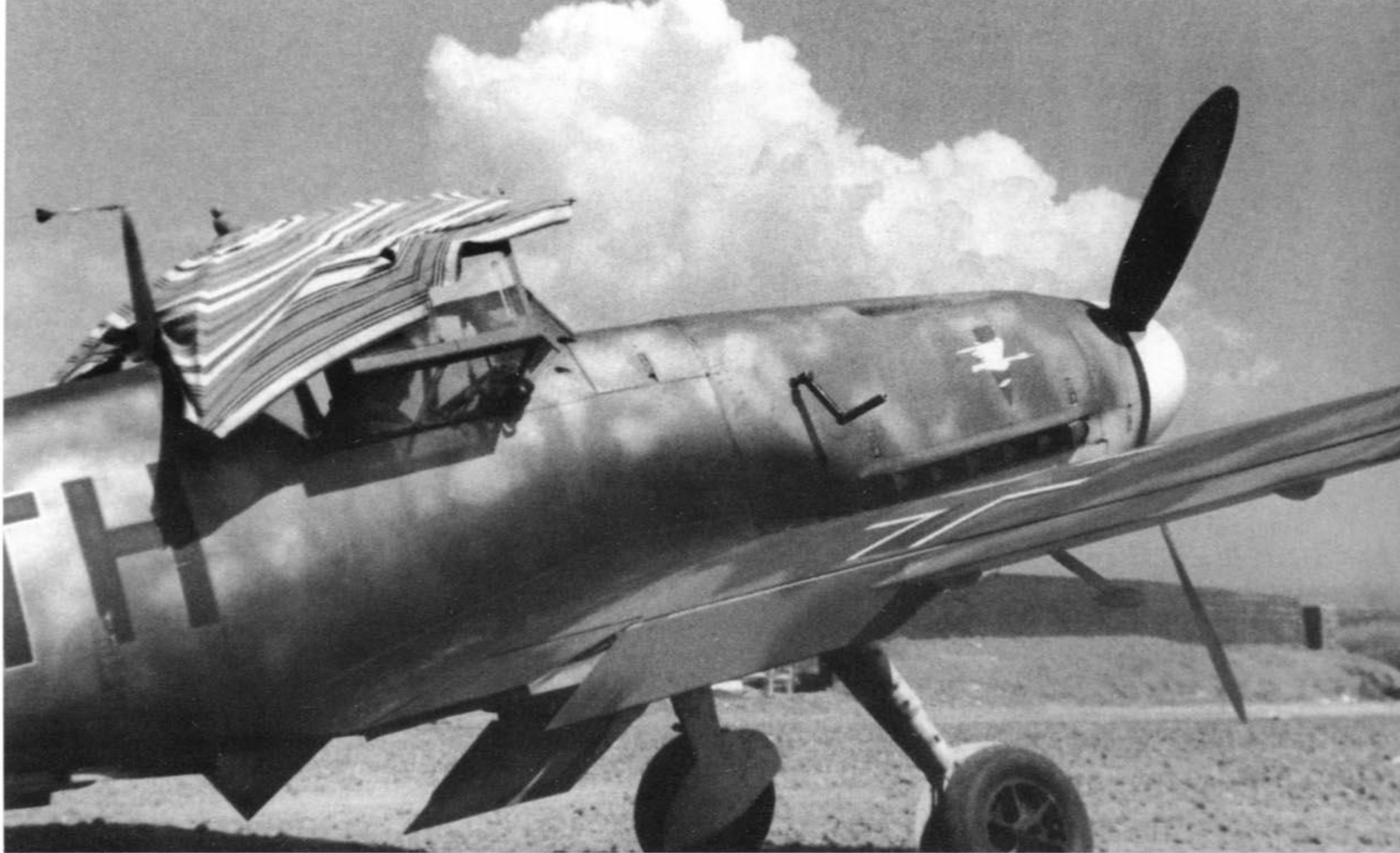
Me 109 F-4/R3 z 1.(F)/122, Sycylia, lato 1942 r. Warto zwrócić uwagę na fragment obudowy kamery fotograficznej, widocznej w dole kadłuba, za splywem skrzydła. Na okapotowaniu silnika wyraźnie widoczne jest godło jednostki.
