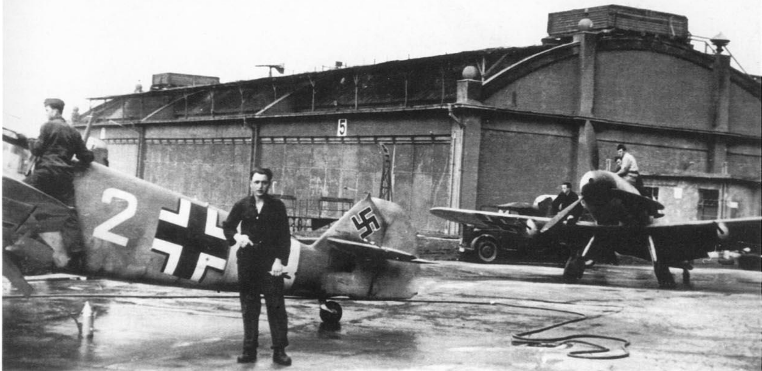
Powyżej i u dołu: Me 109 F-4 z podskrzydłowym uzbrojeniem MG 151 kalibru 15 mm. Samoloty należą do I/JG 52, która była pierwszą jednostką uzbrojoną w takie „Friedrichy“, a także jedyną, która testowała w warunkach frontowych Me 109F z działkami MG 151/20 w podskrzydłowych gondolach.
