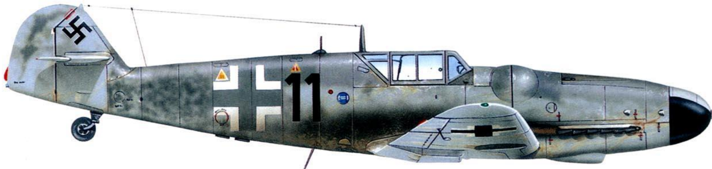
Me 109 G-8 , W.Nr 201765, „czarna 11” jednej z jednostek rozpoznawczych operujących nad Francją jesienią 1944 roku. Samolot nosi standardowe malowanie i oznakowanie, za wyjątkiem tylnej części kadłuba, gdzie przy pomocy farb 74/75 zamalowano poprzednie oznakowanie taktyczne maszyny.
