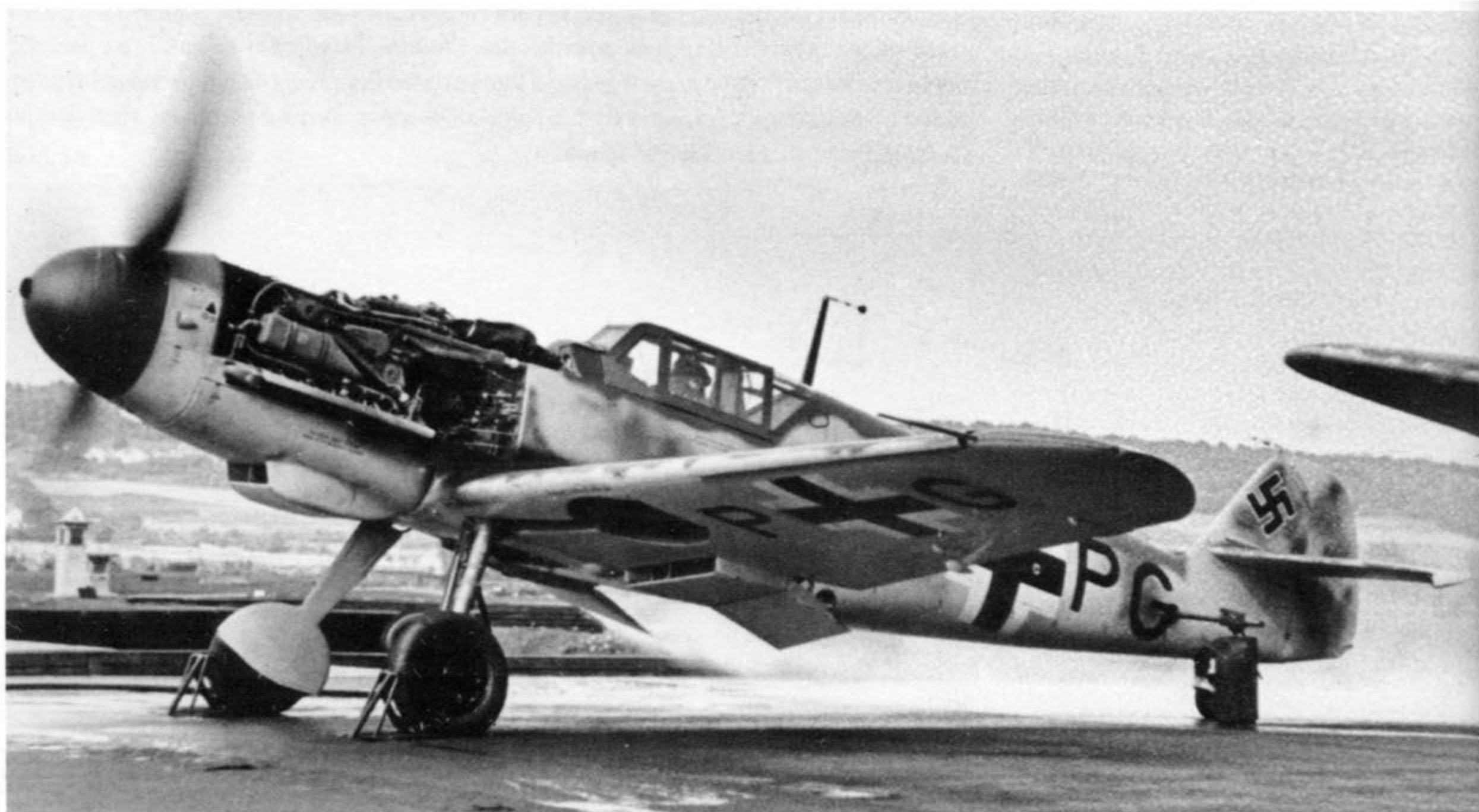
Następne zdjęcie fabrycznie nowego Me 109 G-2, choć z nieco innym kodem CC+PG. Na zdjęciu widoczna próba silnika.
