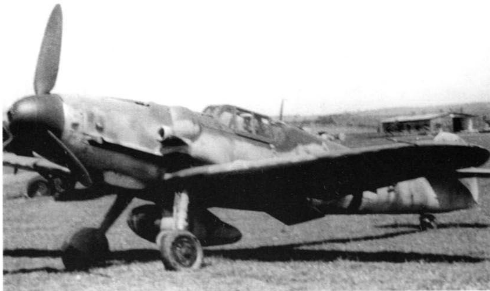
„Gustaw-6“ kołuje na start. W drugiej połowie 1943 r. niemal wszystkie „Gustawy“ były wyposażone w zamki dla dodatkowych zbiorników.
