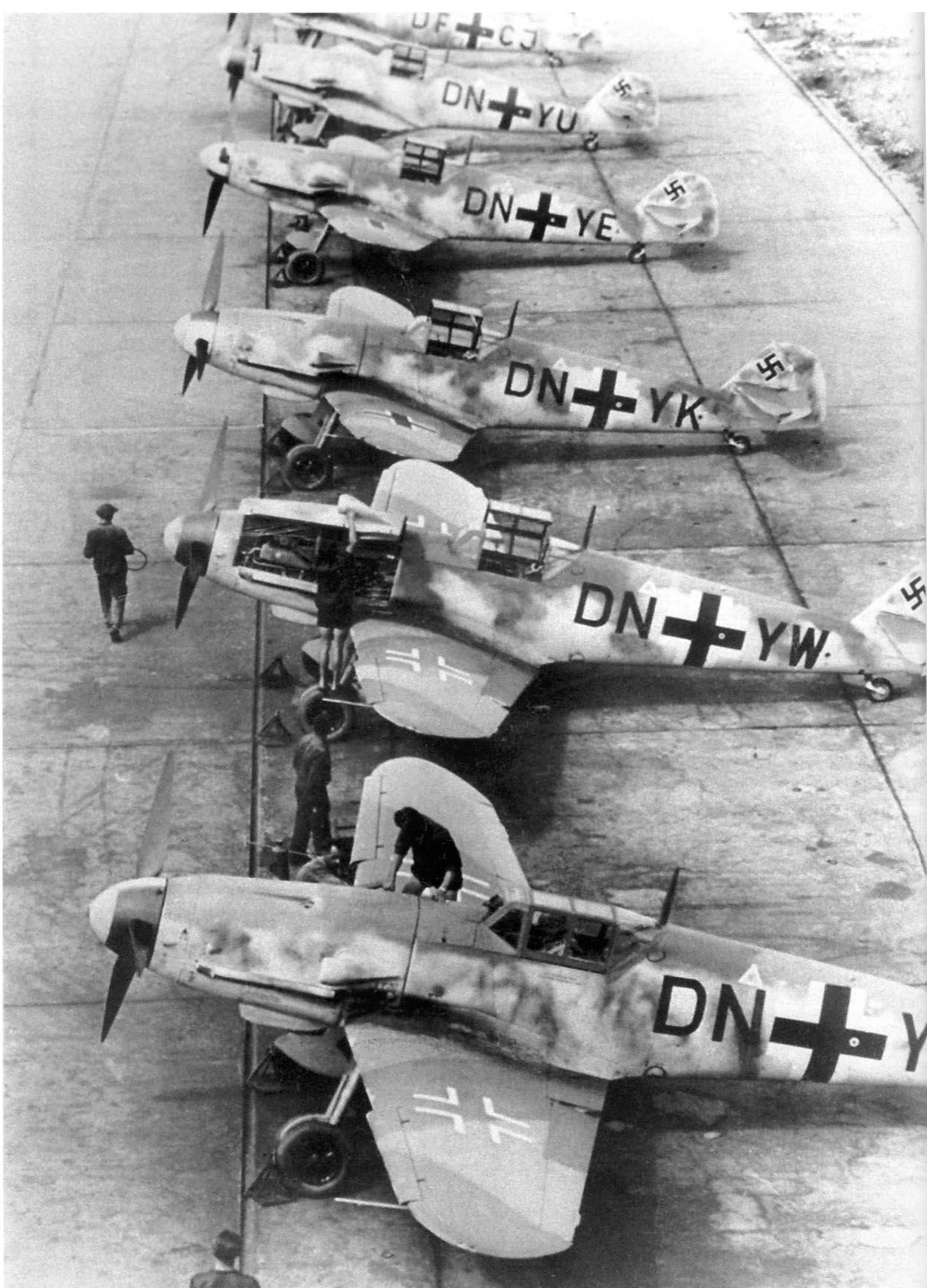
Grupa Me 109 G-2 gotowa do odbioru. Doskonale widoczne jest ich malowanie i oznakowanie — górne powierzchnie kadłuba i skrzydeł są identyczne na wszystkich maszynach, natomiast plamki na bocznych powierzchniach cechują się już pewną dowolnością.
