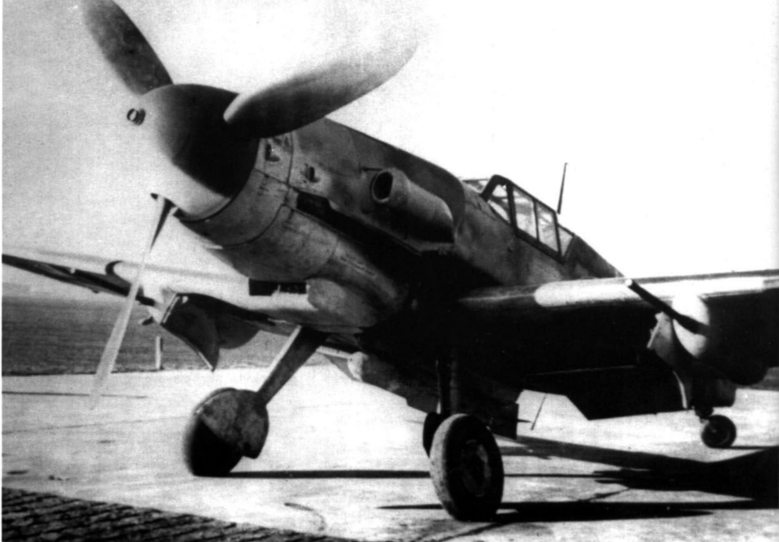
Me 109 G-6, W.Nr 15562, CN+WF, stanowił jeden z nie mniej niż tuzina prototypów dla samolotów z silnikami DB 605 AS oraz D. Szczególną uwagę zwraca podkadłubowy pylon na dwie bomby po 50 kg każda.
