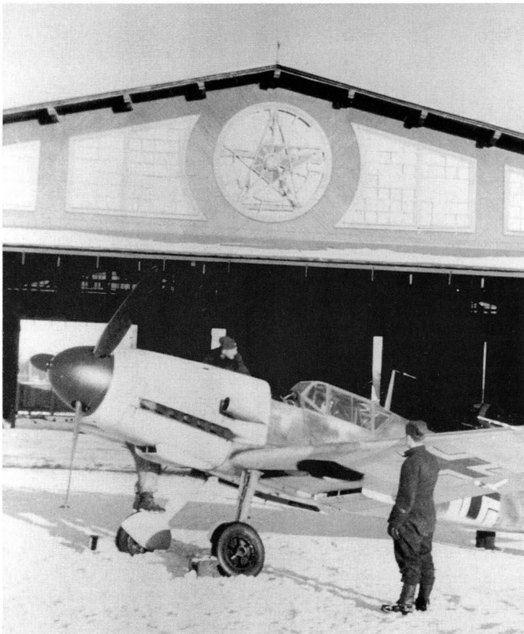
Me 109 F-2 z JG 54 sfotografowany w trakcie przygotowywania do zadania bojowego na Froncie Wschodnim, zima 1941/42 r. Dobrze widać kształt wlotu powietrza do gaźnika, typowy dla Me 109F; był on nieco węższy niż ten, używany na późniejszych seriach Me 109 F-4, który został dostosowany do filtra tropikalnego.
