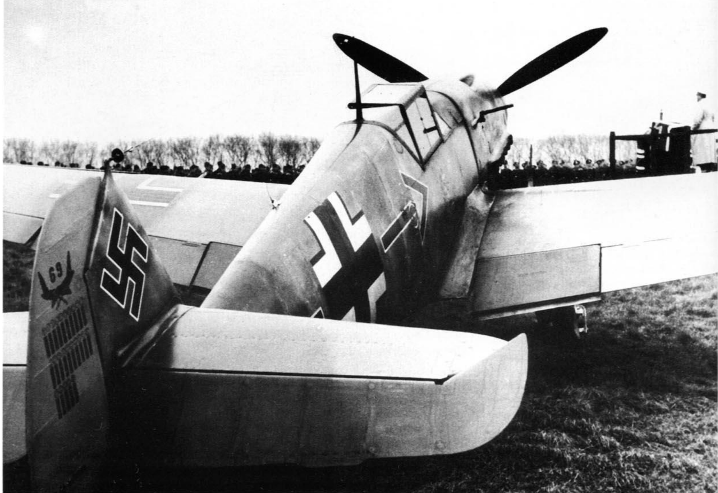
Zdjęcie Me 109 F-6/U Gallanda, zrobione w trakcie wizytacji JG 26 przez Göringą. Wyraźnie widać lufy działek MG FF/M, „spis treści“ na sterze oraz oznakowanie dowódcy pułku. Oba pilotowane przez Gallanda prototypy miały niemal identyczne oznakowanie i malowanie.
