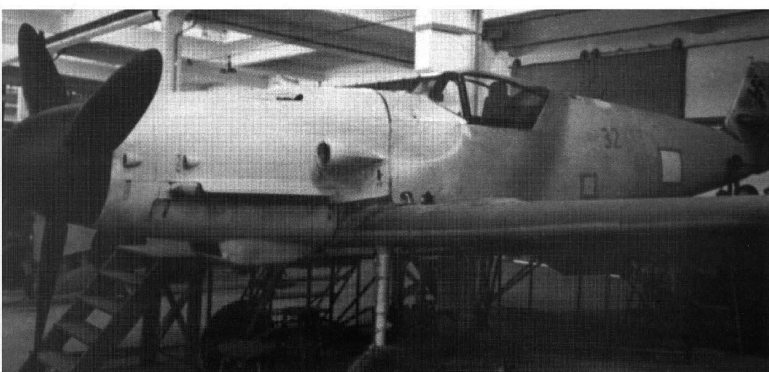
Me 109 G-6 przerobiony na prototyp „Konrada“, przełom lata i jesieni 1943 roku. Wyraźnie widać pierwotny typ osłon uzbrojenia nad silnikiem oraz proponowany typ owiewki.
