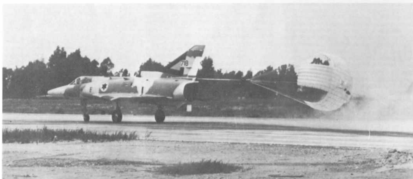
Powyżej i poniżej: Jeden z pierwszych Kfir'ów skracający dobieg za pomocą spadochronu.
