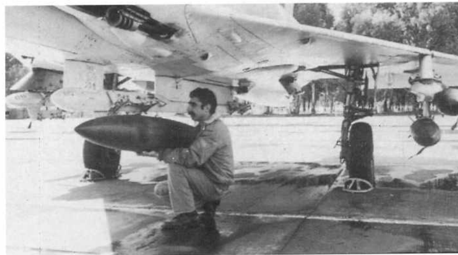
Belki wielozamkowe MER pod kadłubem Kfir'a C-2 oraz TER pod skrzydłami. Na belkach podwieszane są bomby P-1.
