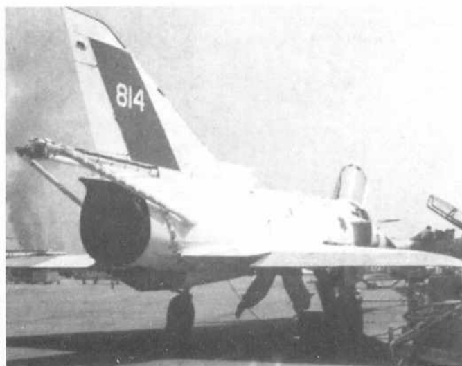
Poniżej: Kfir C-2 używany w badaniach „korkociągowych”. Widoczna jest konstrukcja do mocowania pojemnika ze spadochronem.
