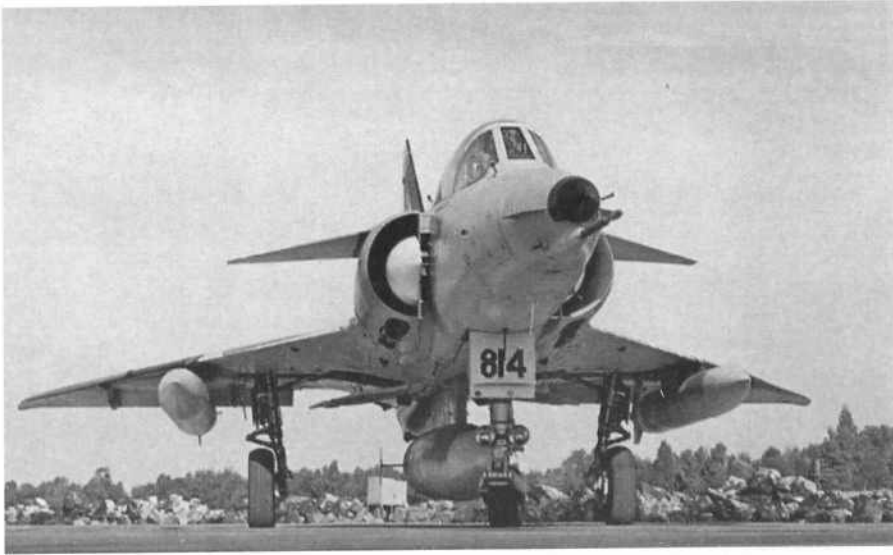
Kfir C-2 w widoku z przodu. Pod skrzydłami podwieszane zbiorniki paliwa po 500 l (naddźwiękowe). Pod kadłubem zbiornik 1300 l.
