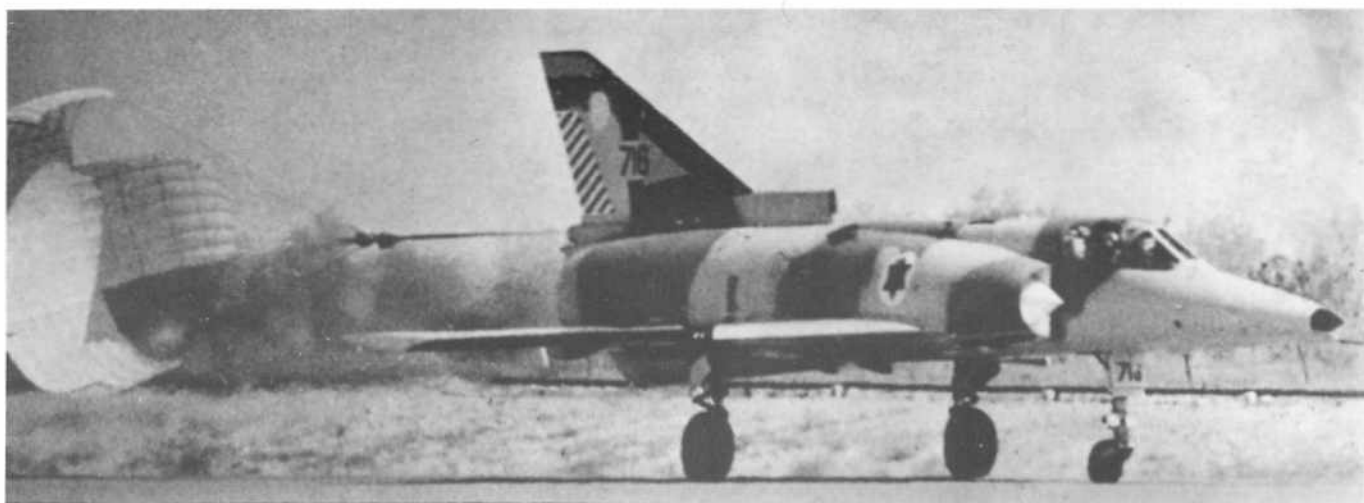
Powyżej i poniżej: Jeden z pierwszych Kfir'ów skracający dobieg za pomocą spadochronu.
