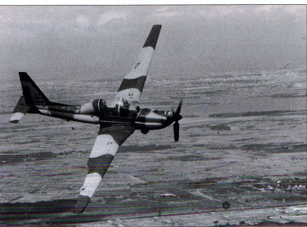
YO-3A posiadał konfigurację skrzydeł istniejącego szybowca SGS 2-32, lecz charakteryzowała się ona poszerzoną sekcją przednią i tylną, co zwiększało siłę nośną, polepszając sterowność przy małych szybkościach.
