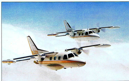
W 1977 r. wprowadzono pokrewne maszyny MU-2N i MU-2P. Typ N był wersją o długim kadłubie (na pierwszym planie), podczas gdy typ P miał pierwotną długość kabiny (na drugim planie).
